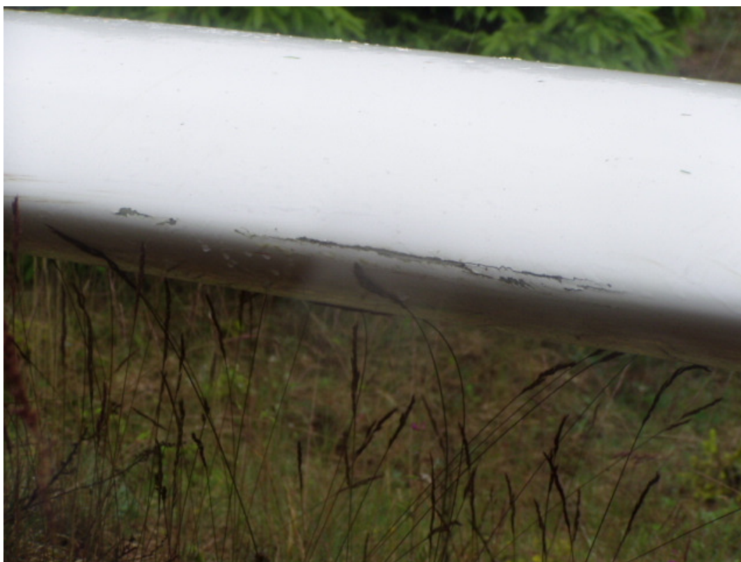
Fot.14 – Uszkodzenia krawędzi natarcia prawego skrzydła.
