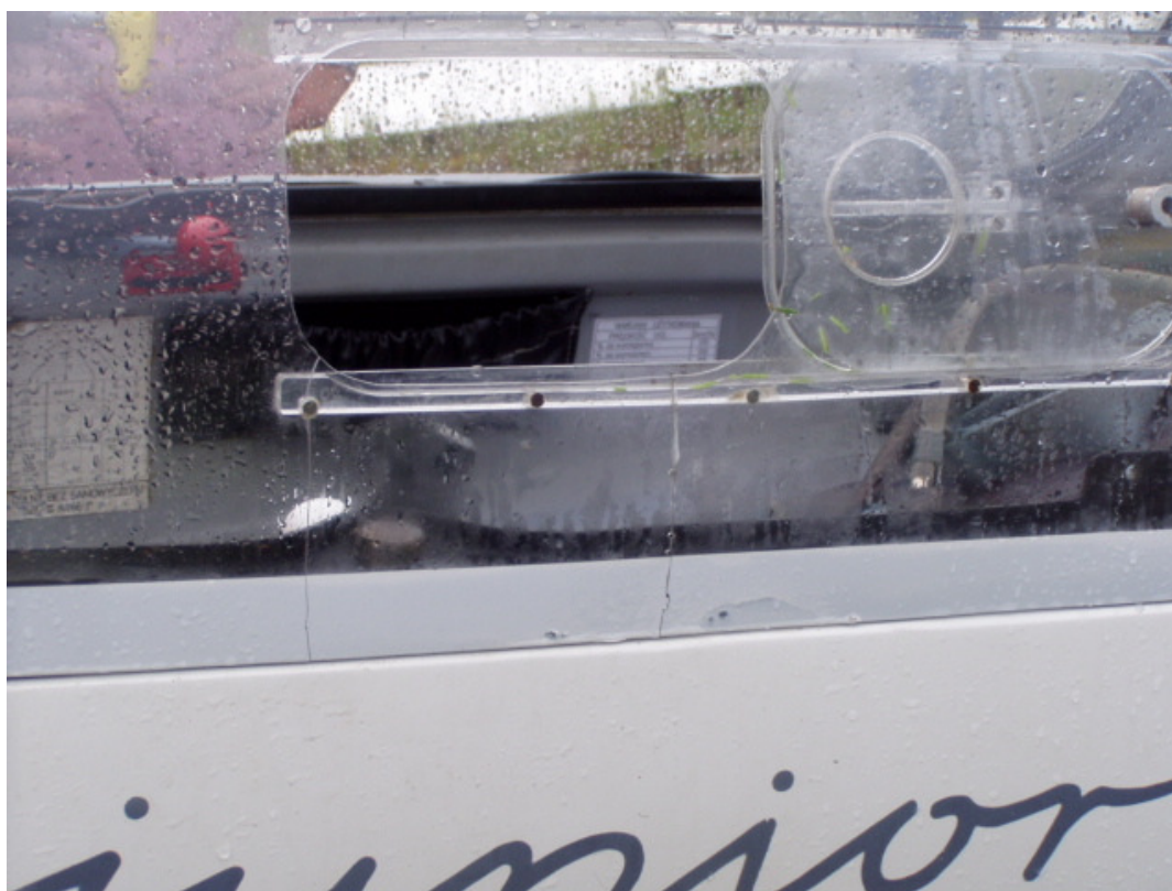
Fot.11 – Pęknięcia oszklenia osłony kabiny.
