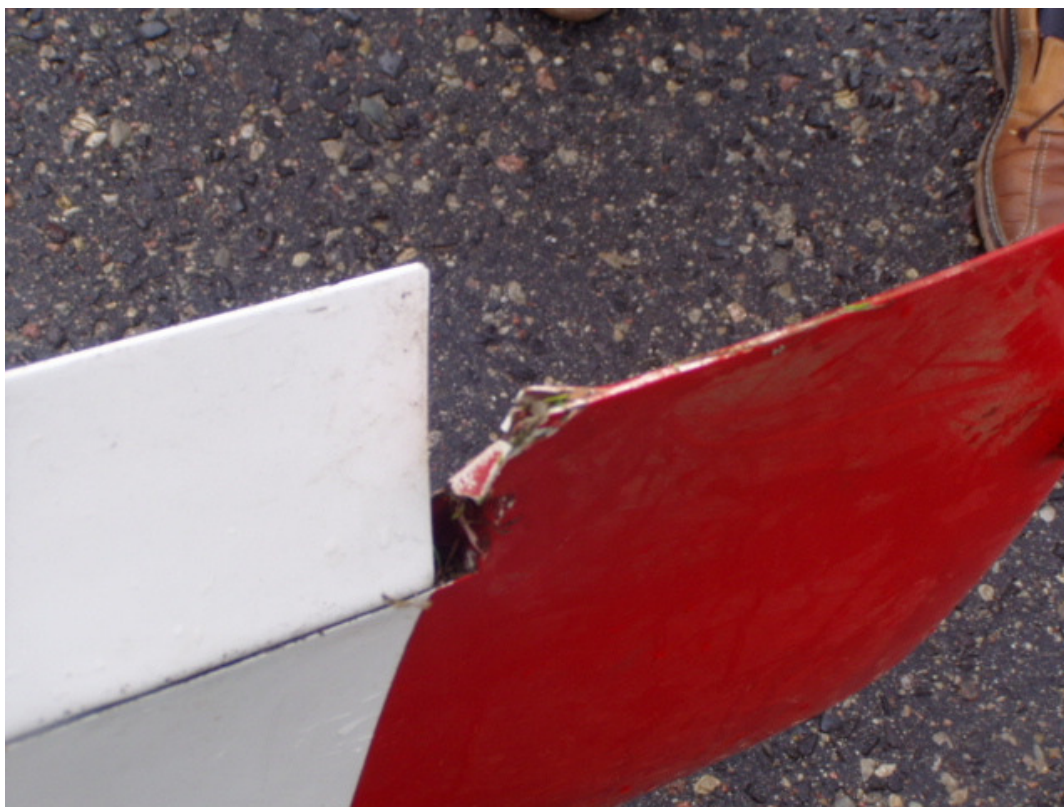
Fot.13 – Uszkodzenia końcówki prawego skrzydła.
