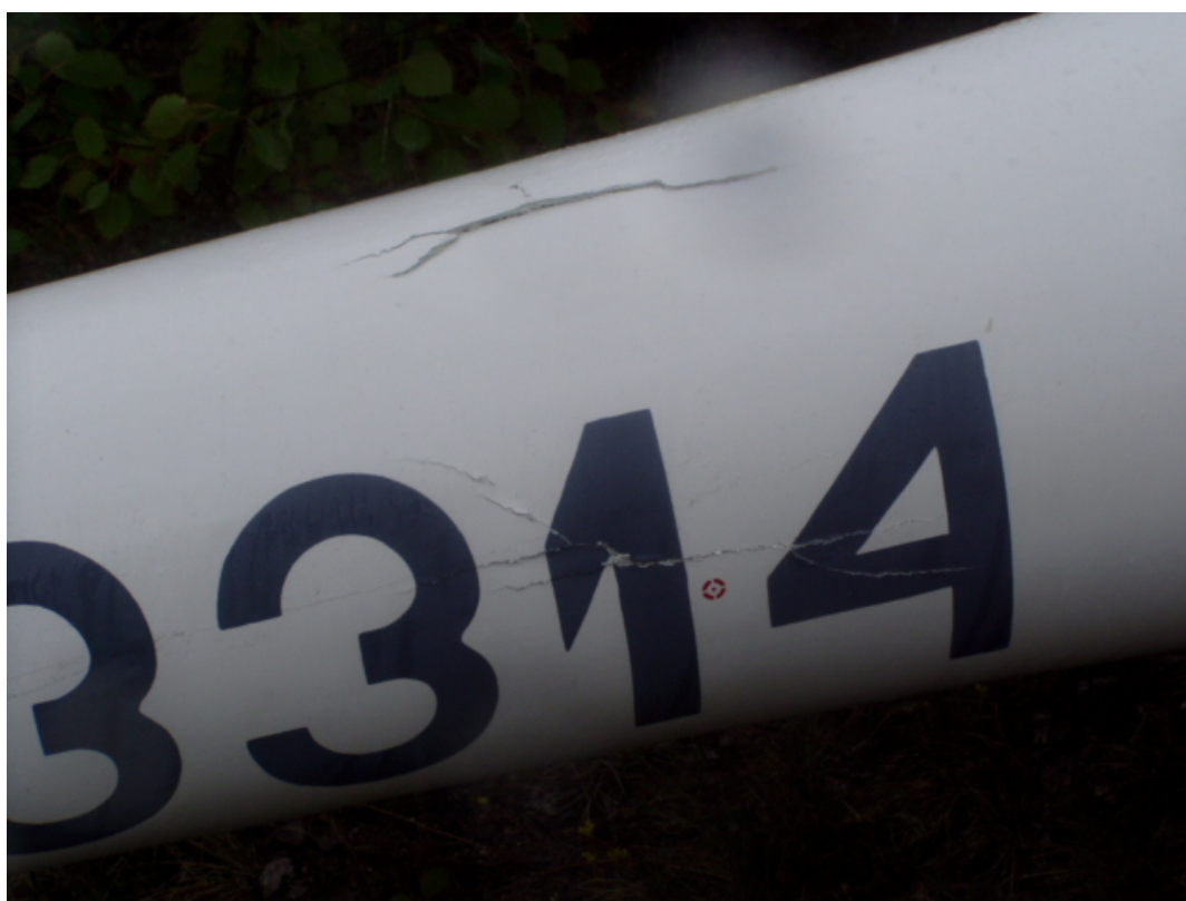
Fot.12 – Uszkodzenia belki ogonowej (prawa strona kadłuba).
