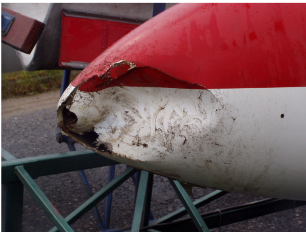
Fot.10 – Uszkodzony przód kadłuba szybowca.
