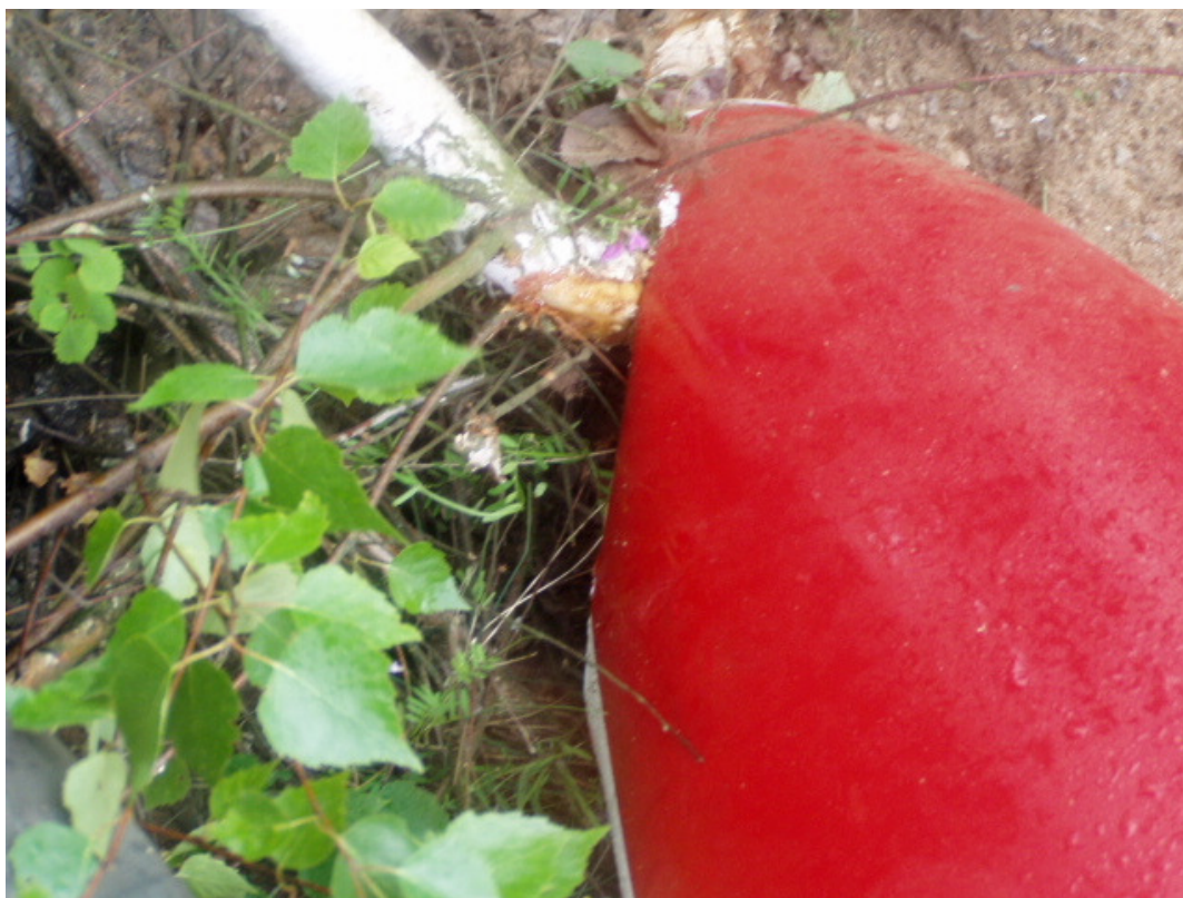
Fot.9 – Przód kadłuba szybowca uszkodzony na brzozach.
