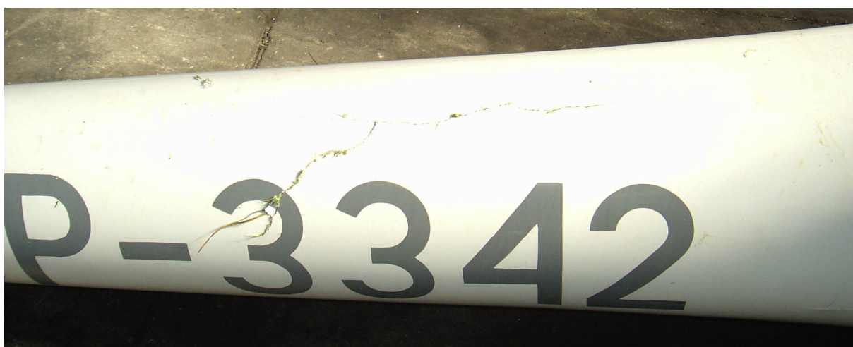
13 – Uszkodzenia belki kadłuba, prawa strona.
