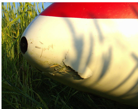
9 + 10 – Uszkodzenia przedniej części kadłuba, lewa strona.
