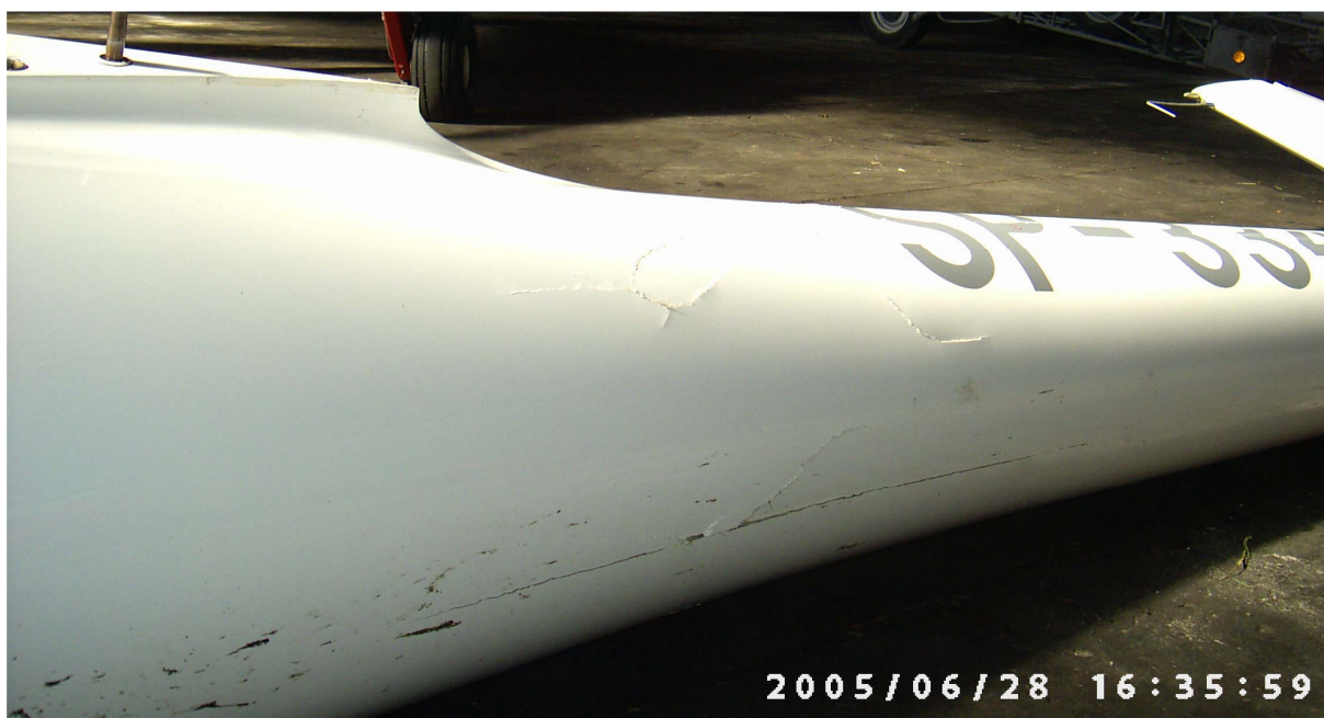
12 – Uszkodzenia kadłuba od spodu, lewa strona.
