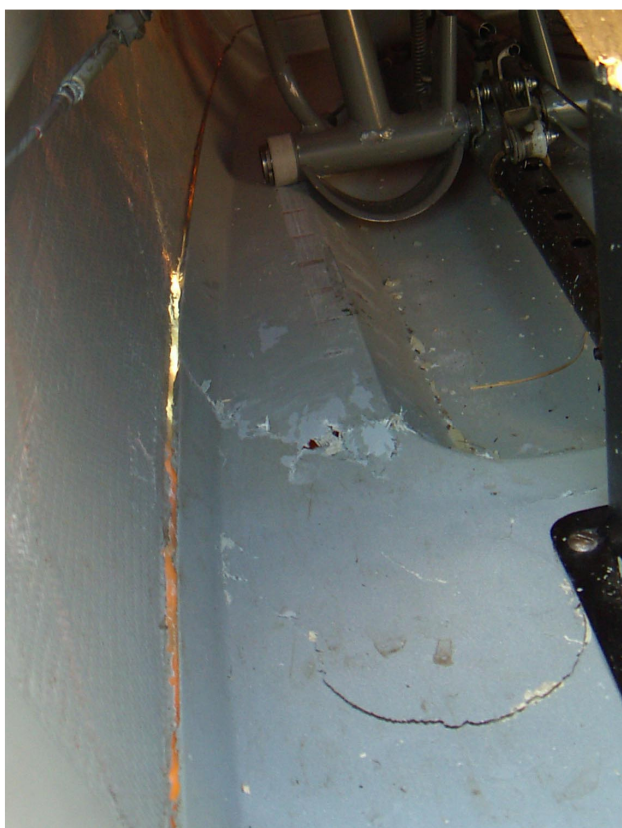
15 + 16 – Uszkodzenia podłogi i lewego pokrycia kadłuba w rejonie kabiny, widziane od strony wnętrza kabiny w różnych warunkach oświetlenia.
