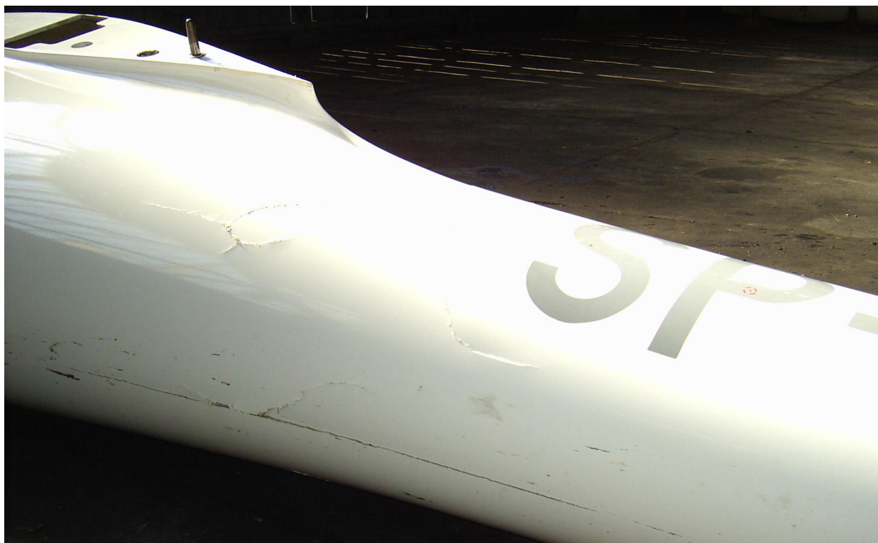
14 – Uszkodzenia kadłuba od spodu, lewa strona.
