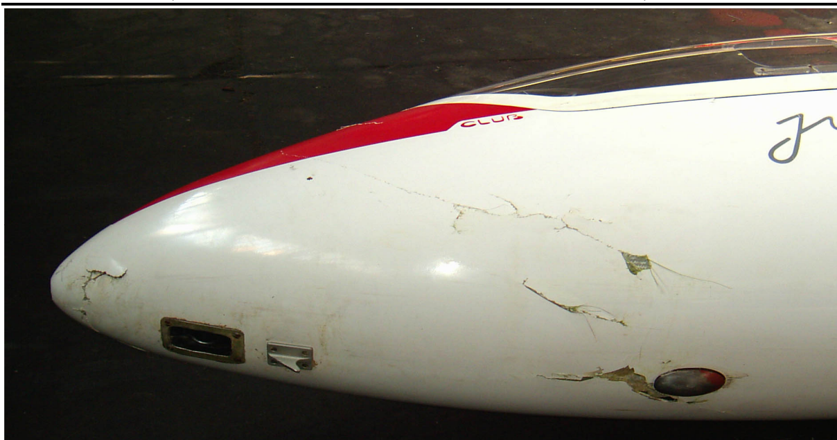
11 – Uszkodzenia przedniej części kadłuba od spodu.
