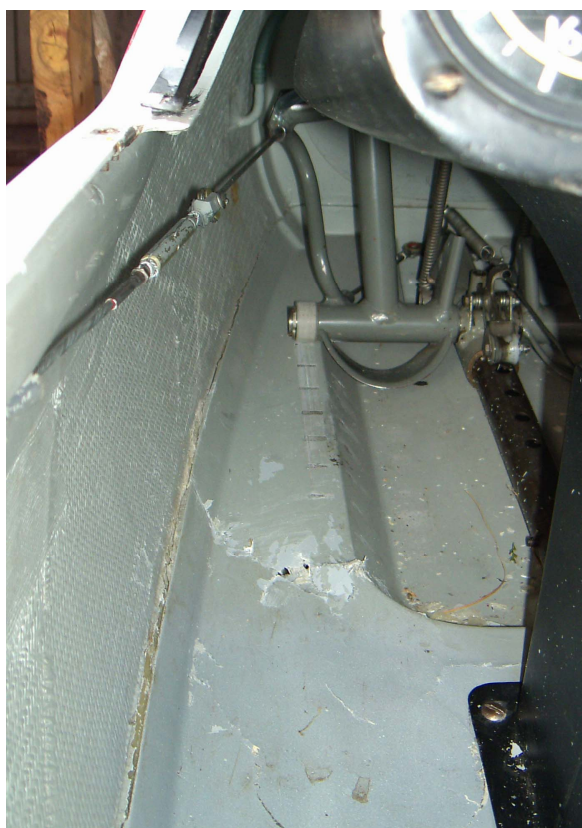
15 + 16 – Uszkodzenia podłogi i lewego pokrycia kadłuba w rejonie kabiny, widziane od strony wnętrza kabiny w różnych warunkach oświetlenia.
