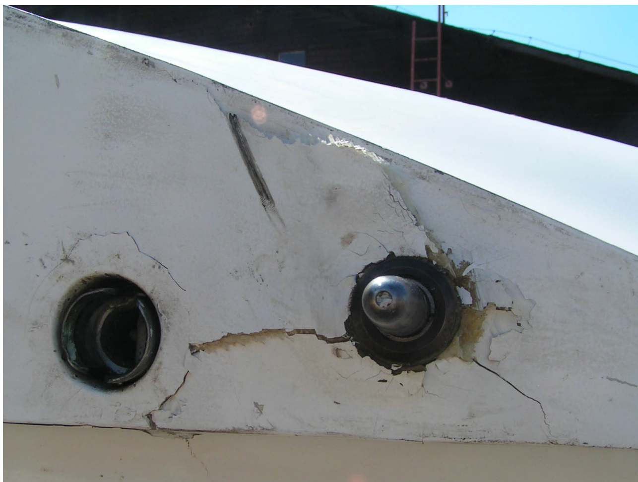
Fot.8 – Uszkodzenie lewego żebra kadłubowego w okolicy tylnego czopa montażowego lewego skrzydła.
