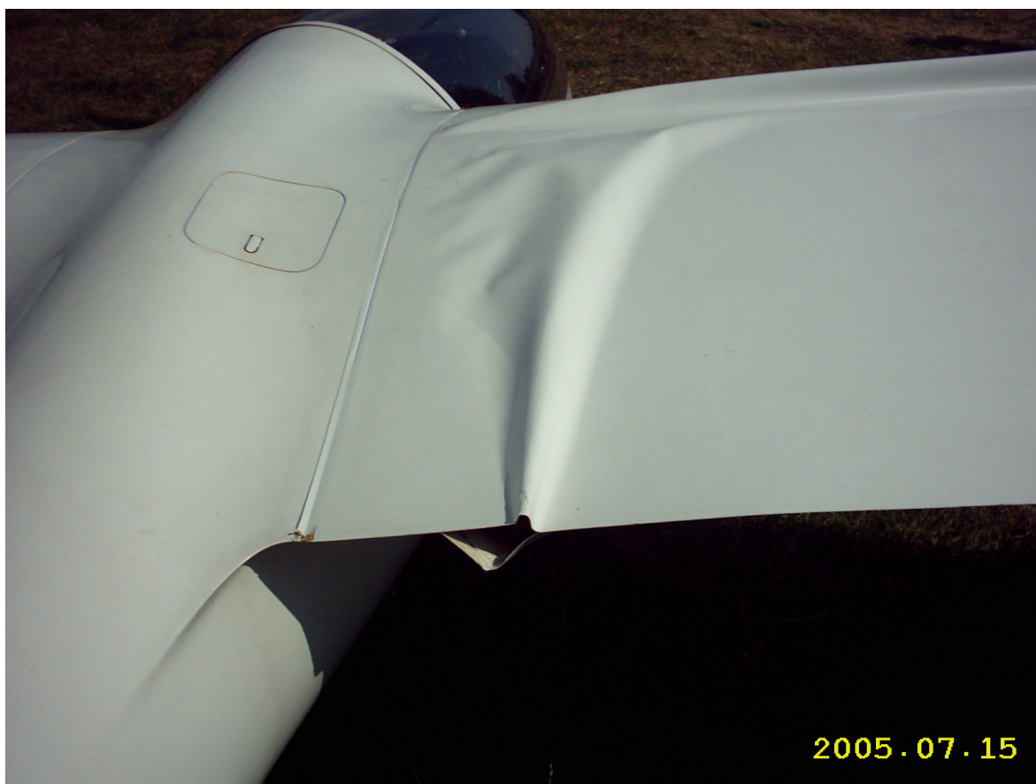
Fot.9 – Uszkodzenia prawego skrzydła u nasady w części spływowej.
