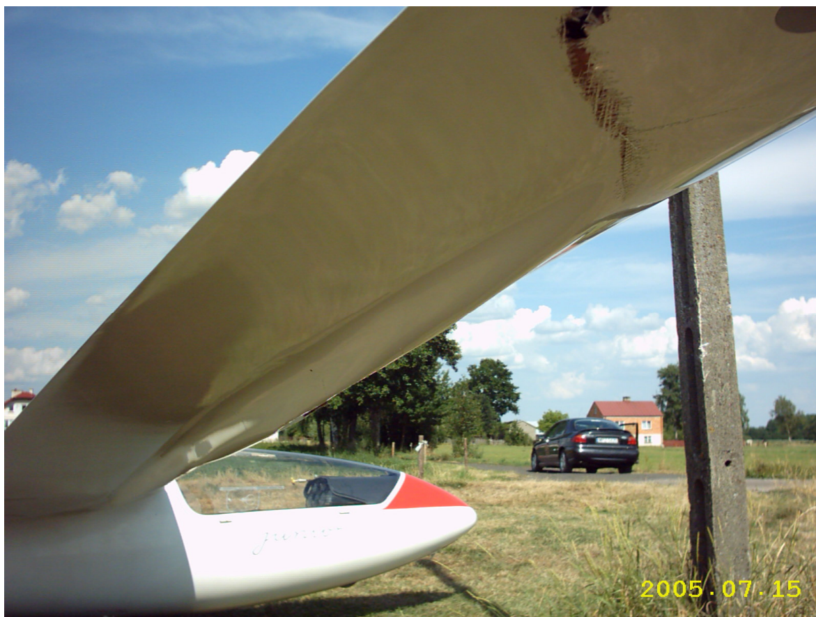
Fot.6 – Uszkodzenia na dolnej powierzchni prawego skrzydła.
