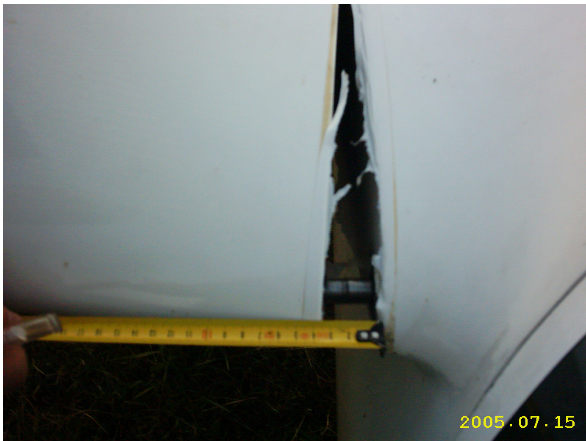
Fot.10 – Odształcenie prawego skrzydła na nosku u nasady przy kadłubie.
