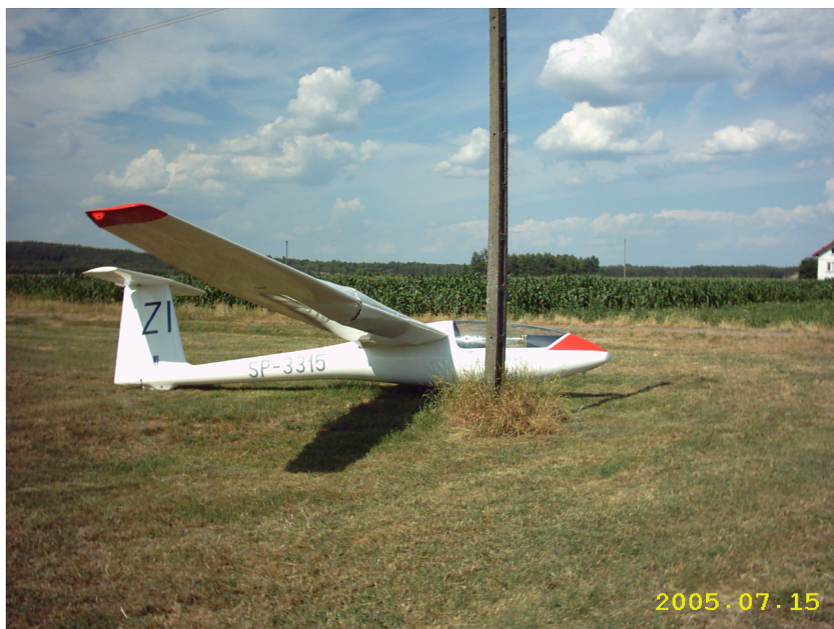
Fot.4 – Ogólny widok szybowca na miejscu wypadku, widoczne uszkodzenie prawego skrzydła.
