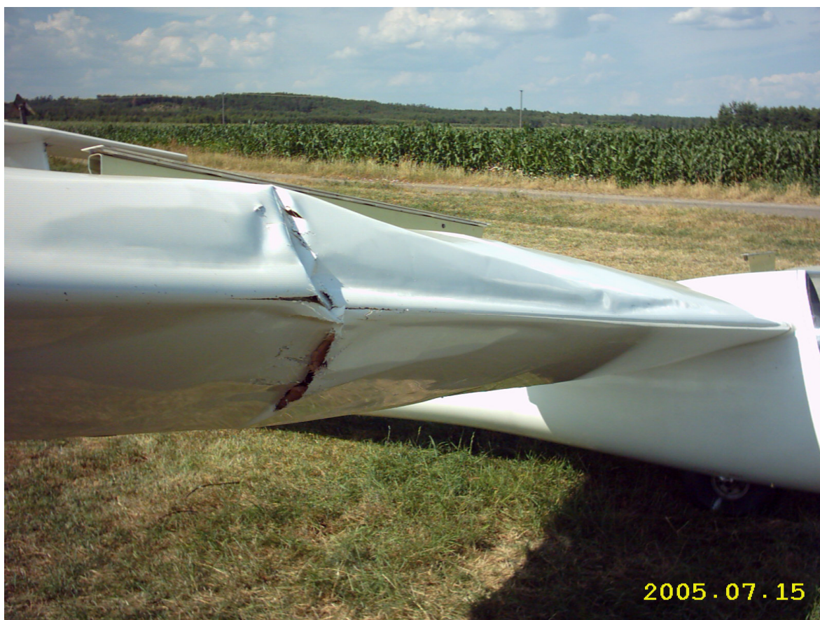
Fot.5 – Uszkodzenie krawędzi natarcia prawego skrzydła po uderzeniu w betonowy słup.
