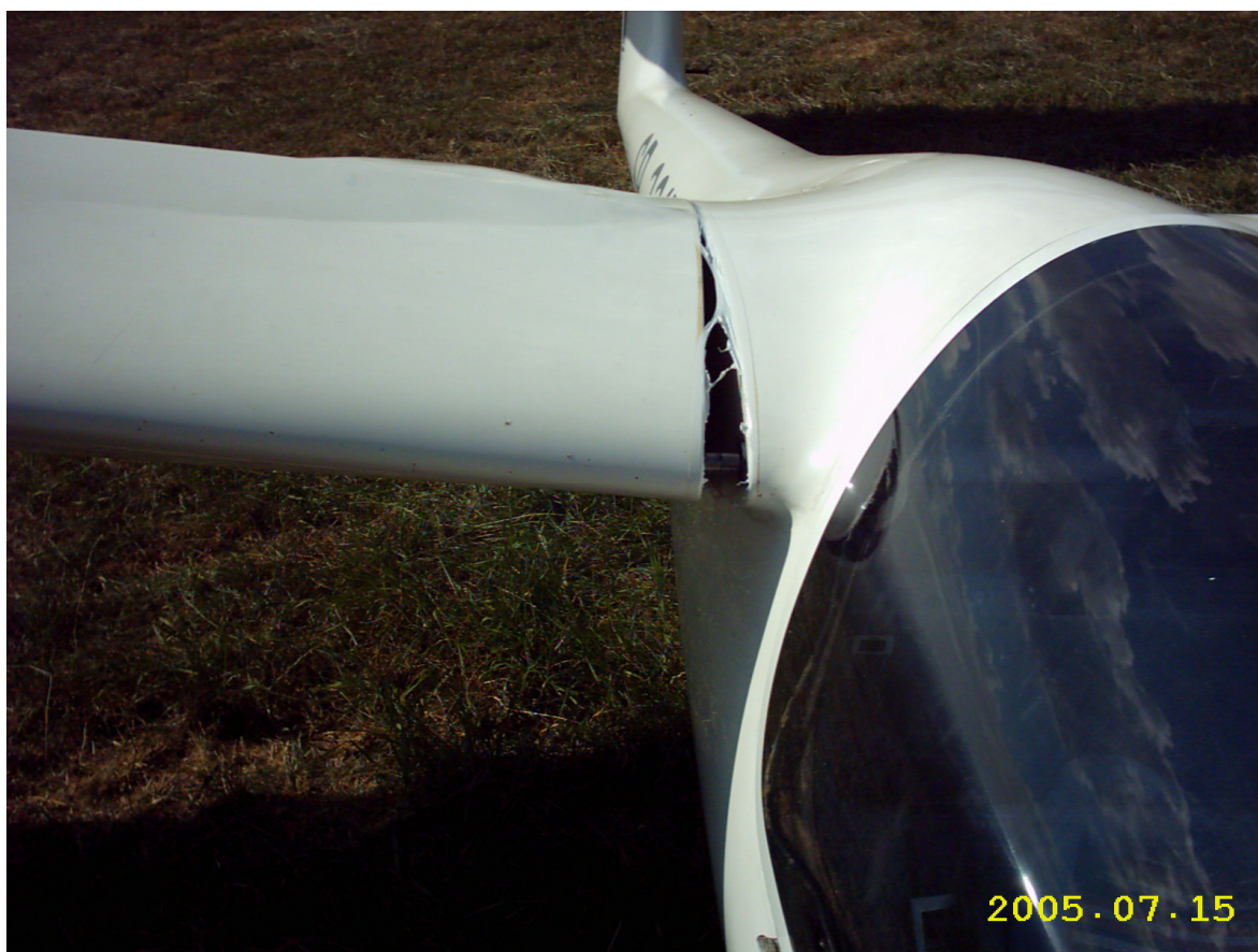
Fot.11 - Odkształcenie prawego skrzydła na nosku u nasady przy kadłubie.
