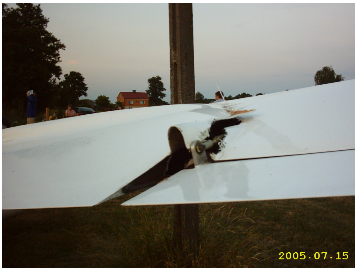
Fot.7 – Uszkodzenia na górnej powierzchni prawego skrzydła w rejonie wyjścia napędu lotki.
