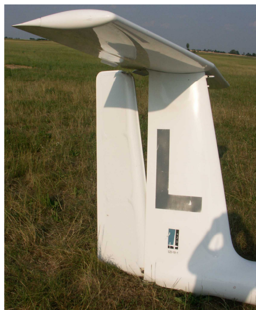
Fot.11 – Usterzenie, widać ster kierunku wyrwany z górnego zawiasu.
