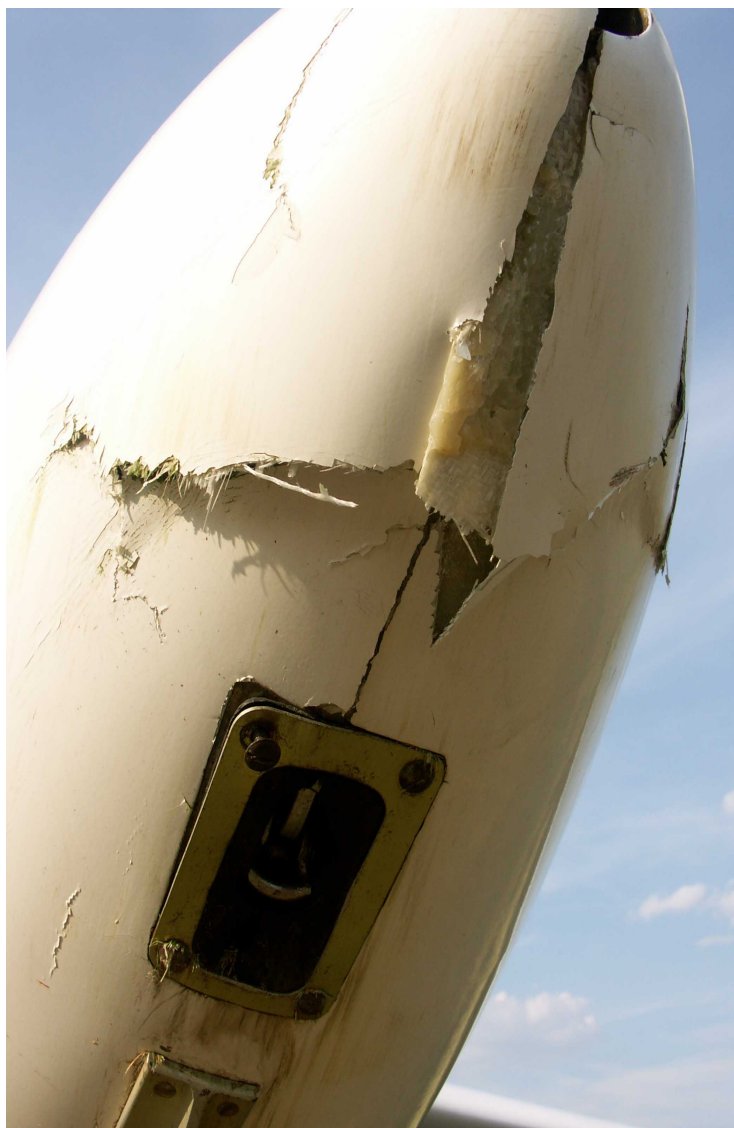
Fot.6 – Uszkodzony nosek kadłuba.
