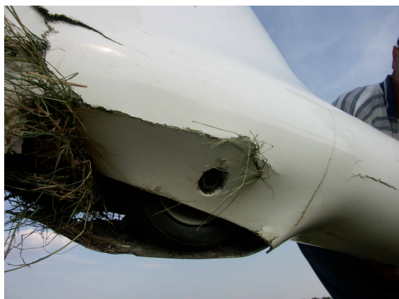
Fot.8 – Tył kadłuba, kółko ogonowe wyrwane i wbite do wnętrza.
