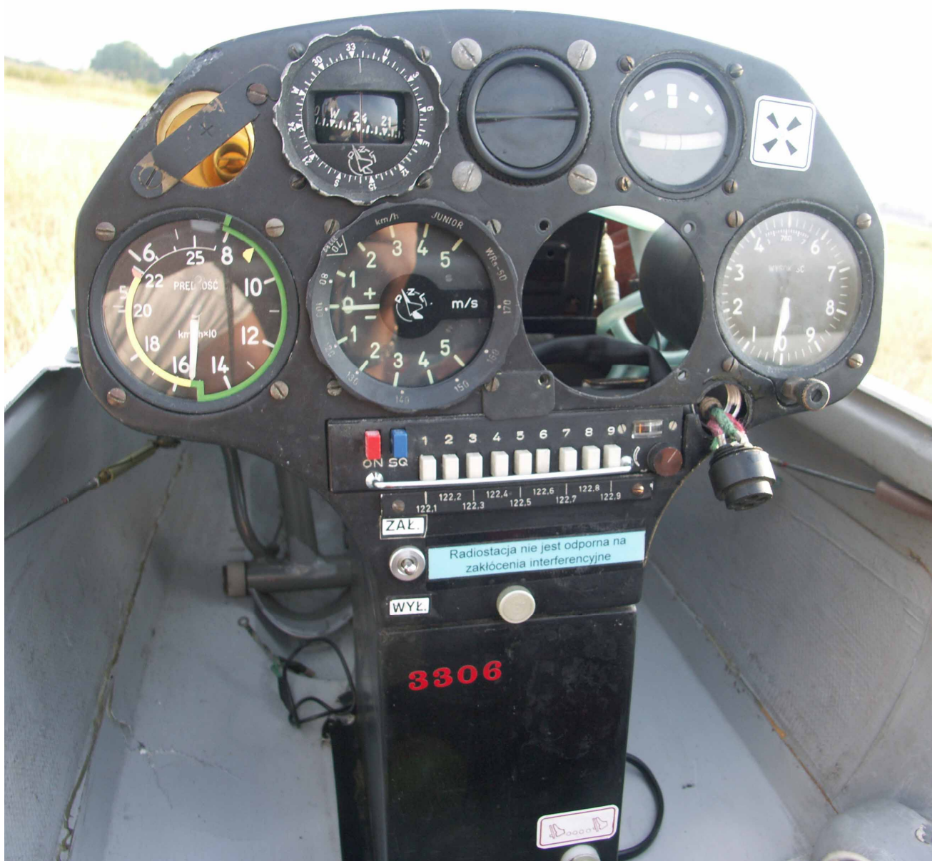
Fot.16 – Tablica przyrządów, po lewej stronie widać pęknięcia skorupy kadłuba.
