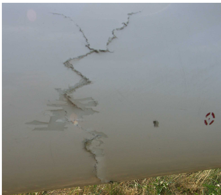
Fot.10 – Pęknięcie belki kadłuba pod usterzeniem – lewa strona.
