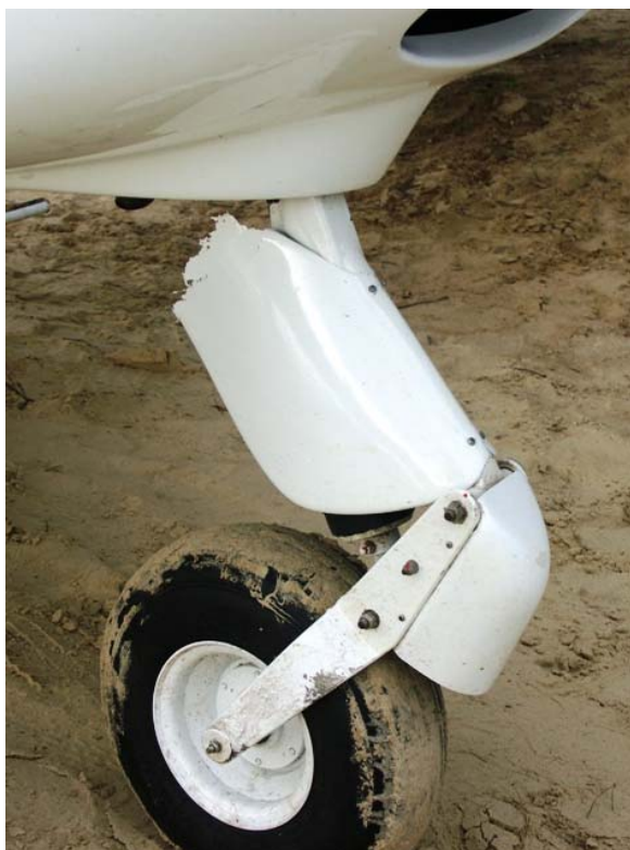
Fot. 7 – Uszkodzona górna owiewka podwozia - brak lewej połówki.
