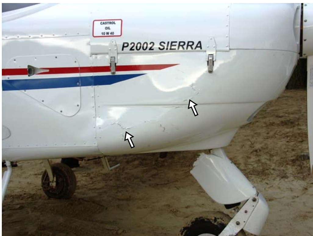
Fot. 9 – Widoczne ślady pęknięć dolnej osłony silnika - prawa strona.
