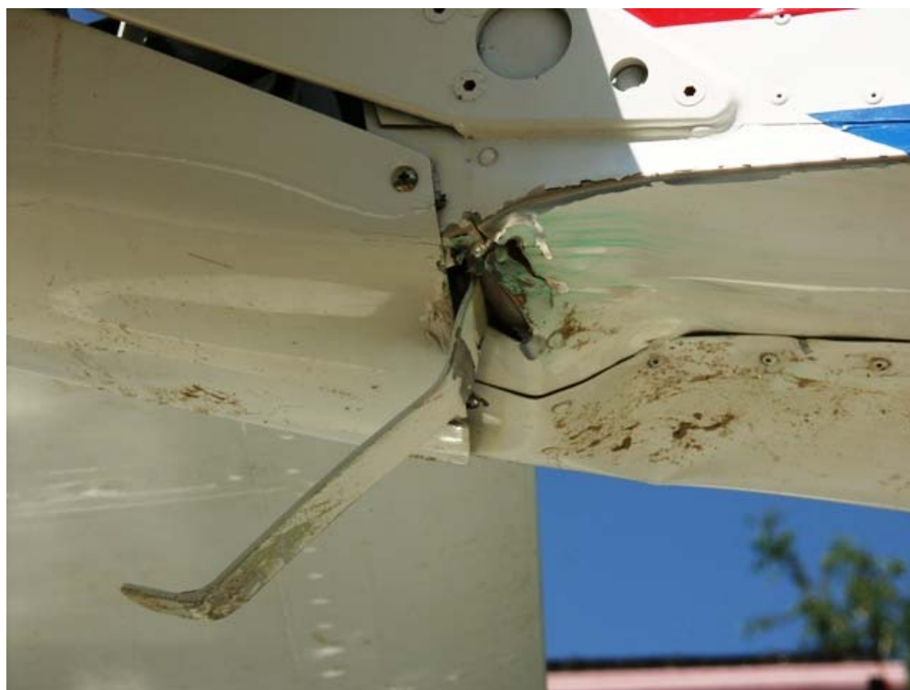
Fot. 6 – Uszkodzenie kadłuba w wyniku uderzenia o ławkę; widoczne ślady farby z ławki.
