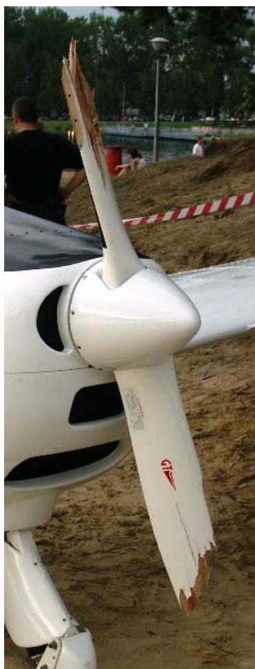
Fot. 16 – Śmigło z urwanymi łopatkami.
