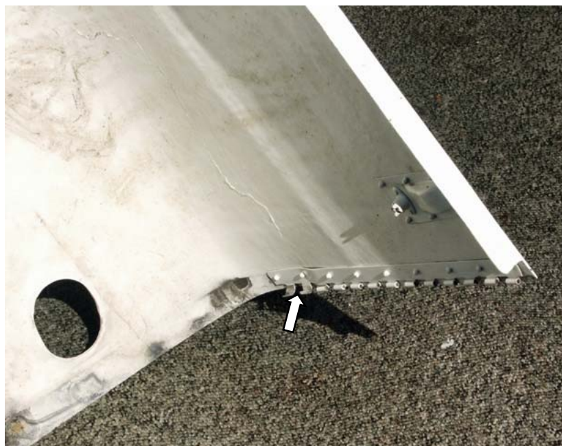
Fot. 15 – Zdformowany zawias montażowy osłony dolnej - prawa strona
