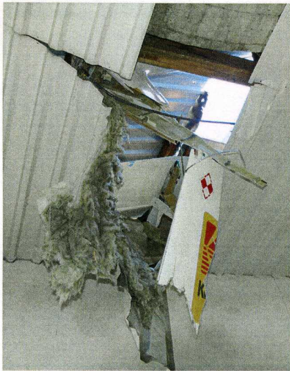
5a i 5b – Część ogonowa szybowca i zniszczona więźba dachowa.
