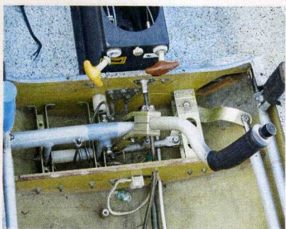
15 – Sterowanie lotkami i sterem wysokości w kabinie.
