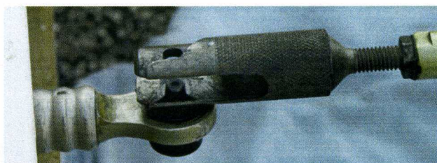
20a i 20b – Możliwość wadliwego połączenia popychaczy – przypuszczalna przyczyna wypadku.
