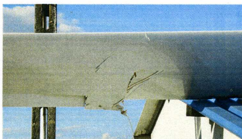
7a i 7b – Lewe skrzydło szybowca z widocznymi uszkodzeniami.
