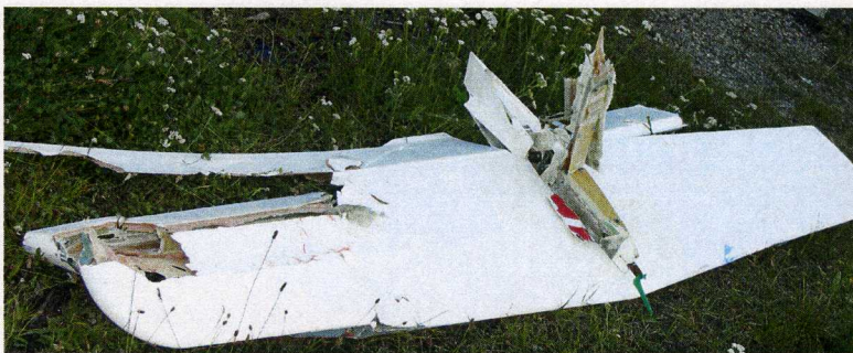
16 – Oderwane usterzenie poziome.
