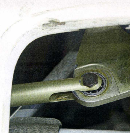
17 – Popychacz „krótki” przyłączony do dźwigni w kadłubie.
