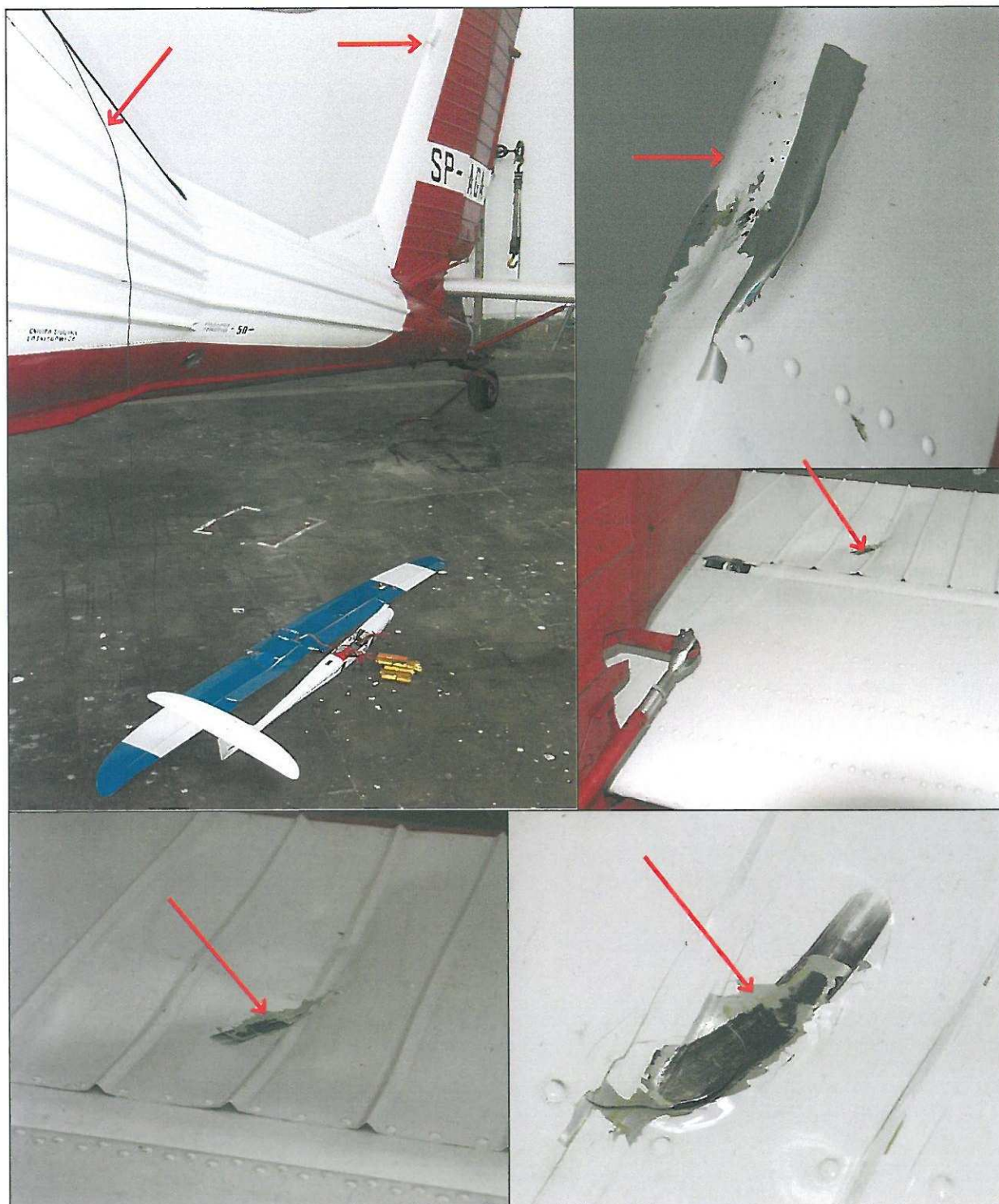
2, 3, 4, 5, 6 – Uszkodzony samolot i rozbity model po zderzeniu – zbliżenia uszkodzeń płatowca SP-AGA.
