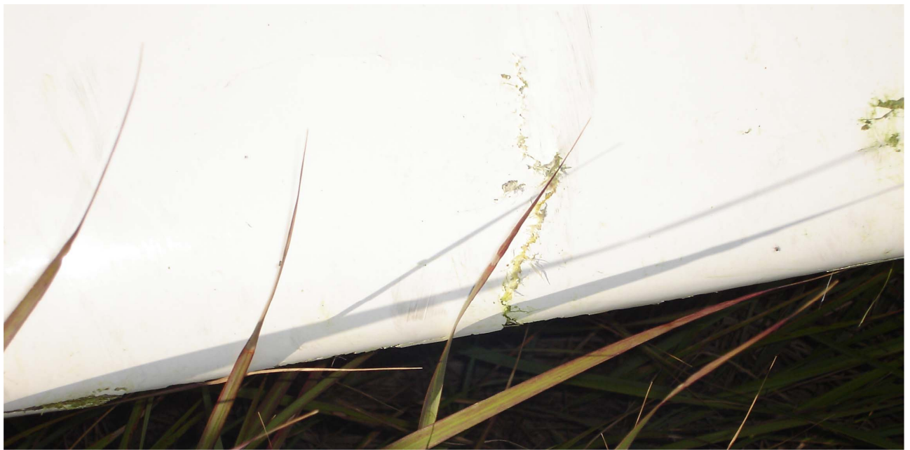
Fot.7 – Uszkodzenia skrzydła.
