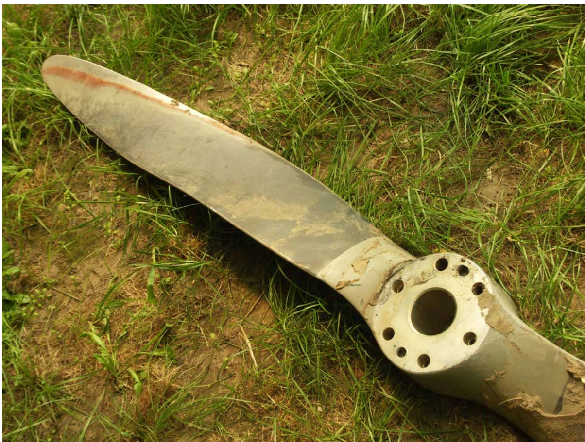
Fot.40 – Łopata śmigła „zeszlifowana” na krawędzi wskutek tarcia o ziemię.
