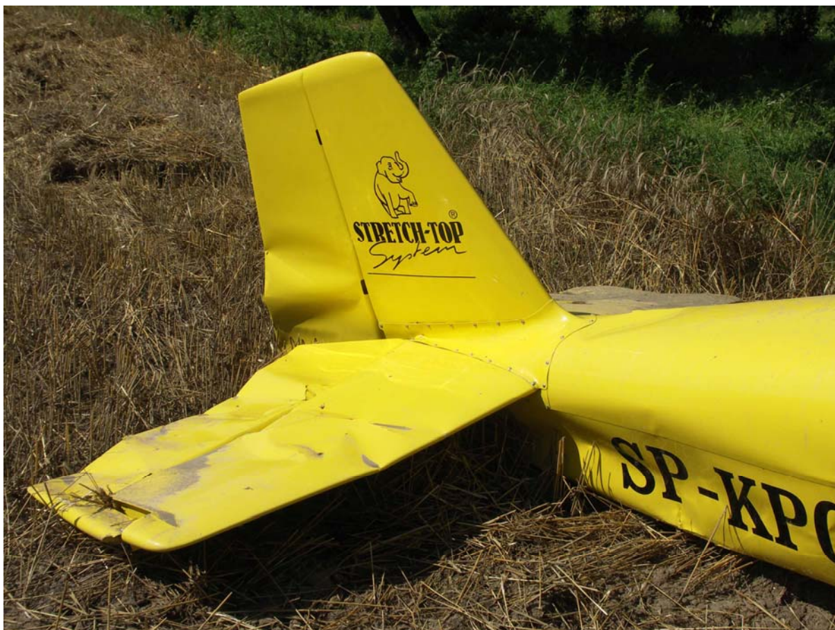
Fot.19 – Tylna część kadłuba z usterzeniem, prawa strona.
