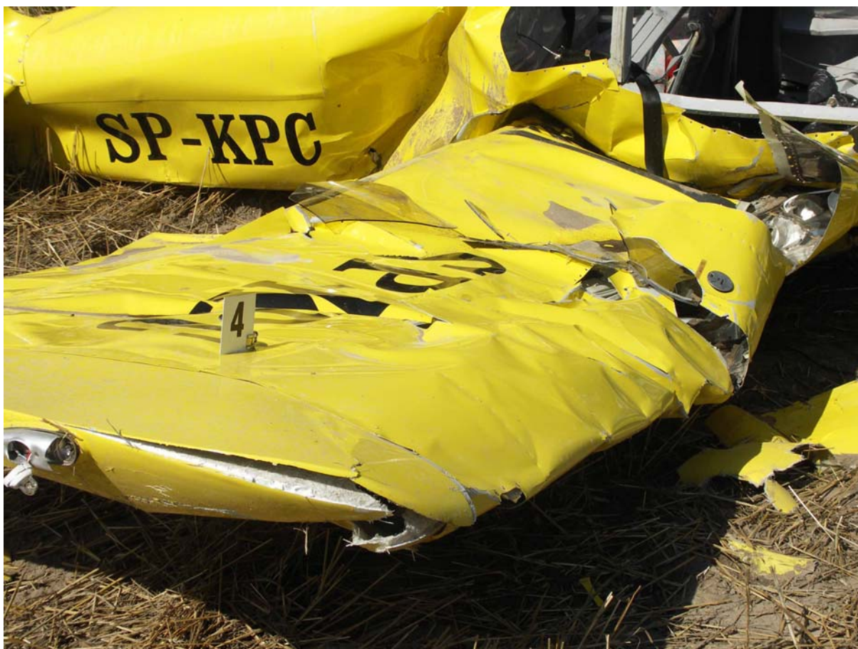
Fot.14 – Zniszczone prawe skrzydło.
