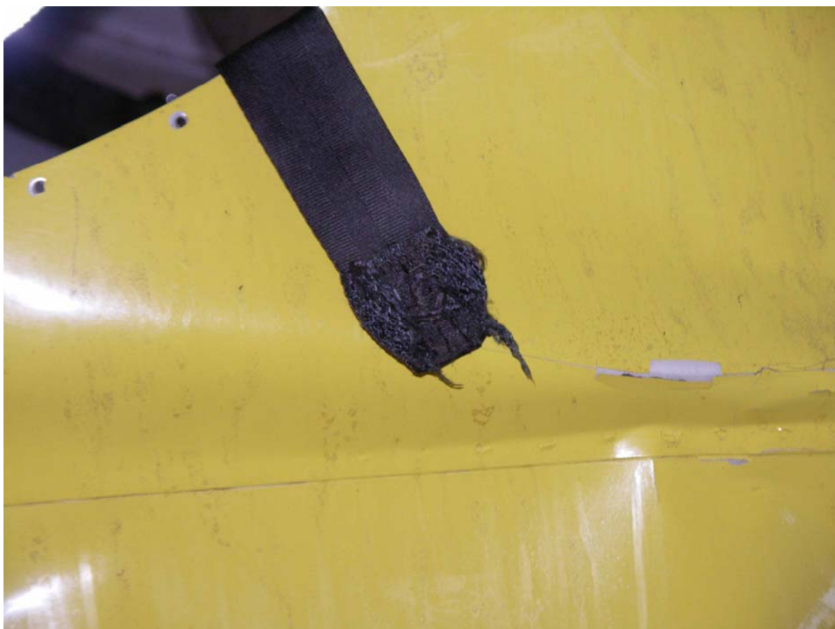
Fot.34 – Rozerwany szew na rozwidleniu lewego kompletu pasów barkowych.
