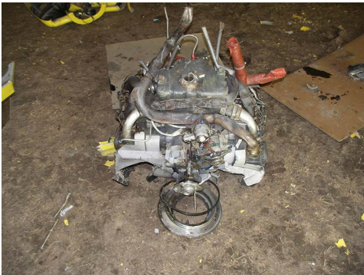
Fot.37 – Silnik po odcięciu od samolotu, widok z przodu i od dołu; gaźnik odłamany.
