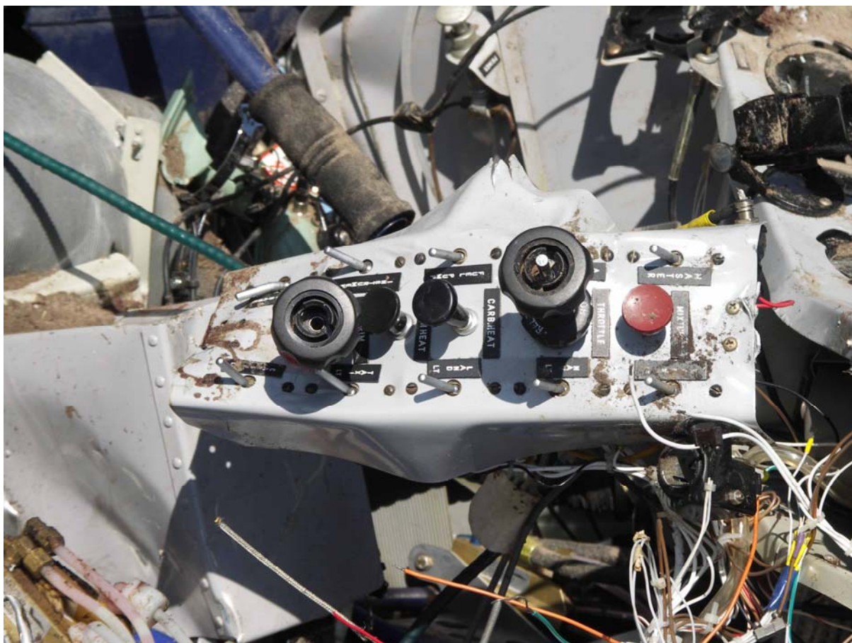
Fot.31 – Pulpit środkowy z manetkami sterowania silnikiem.
