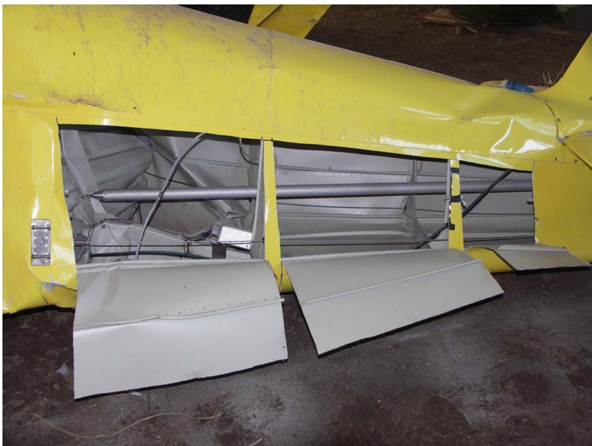
Fot.44 – Sterowanie w kadłubie – widok ogólny po odsłonięciu pokryć.
