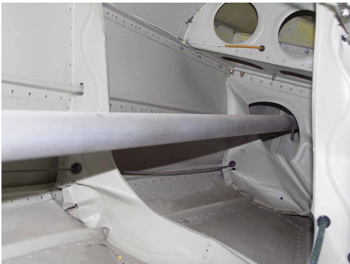
Fot.46 – Sterowanie w kadłubie od strony usterzenia.
