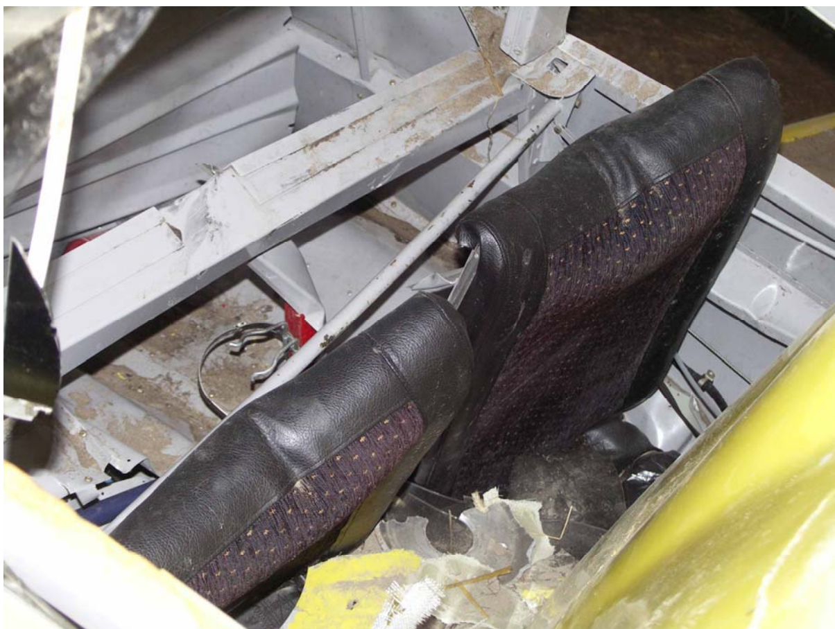
Fot.32 – Oparcia foteli z wgnieceniami od barkowych pasów bezpieczeństwa.
