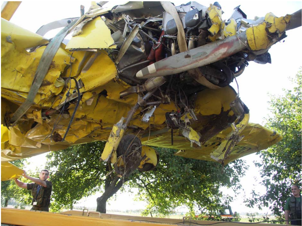
Fot.35 – Podnoszenie wraku – widać zniszczony spód kadłuba i połamane podwozie.
