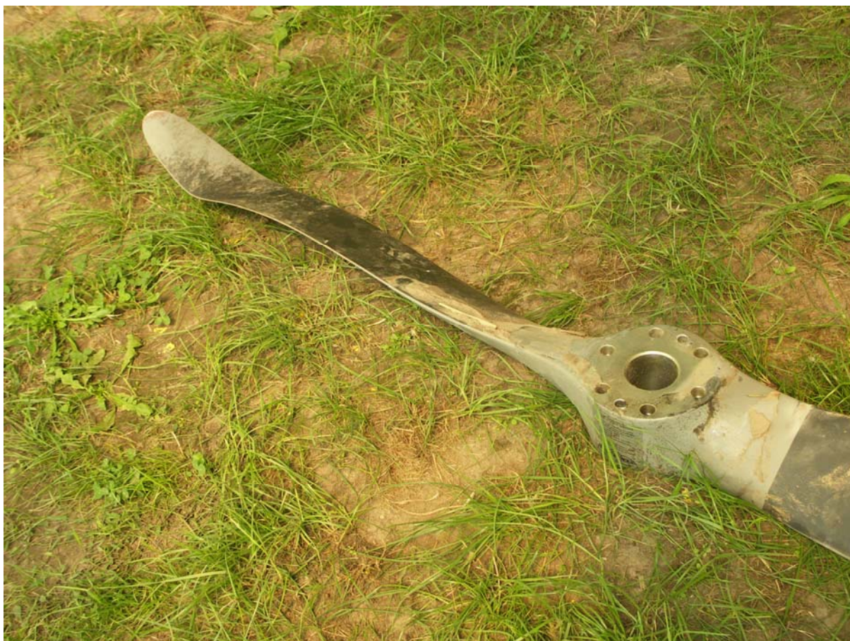
Fot.41 – Druga łopata śmigła, zgięta wskutek uderzenia o ziemię.
