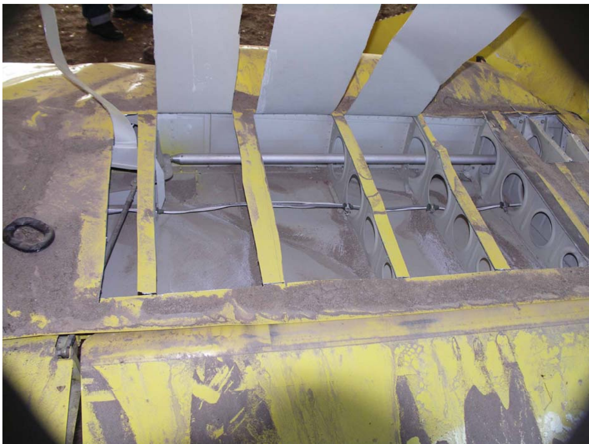
Fot.47 – System sterowania lotką w lewym skrzydle po odsłonięciu pokryć.
