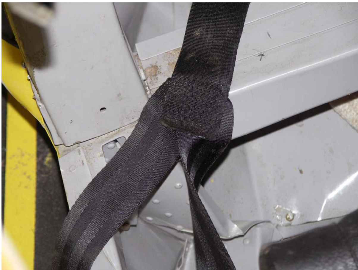
Fot.33 – Rozwidlenie prawego kompletu pasów barkowych, bez uszkodzeń.
