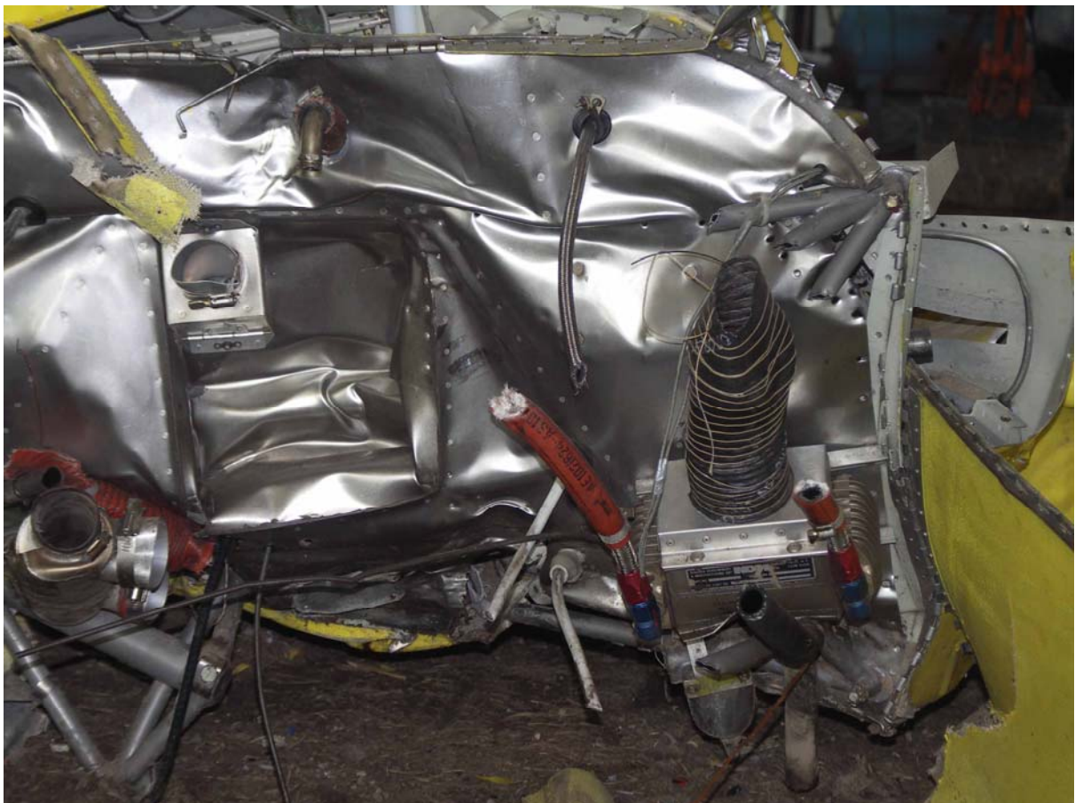
Fot.36 – Przegroda ogniowa po odcięciu łoża silnika i jego systemów.
