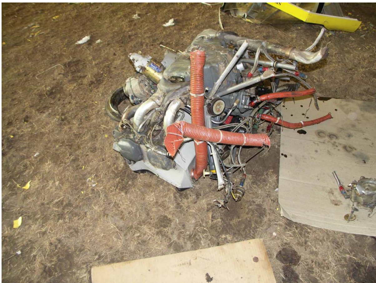
Fot.39 – Silnik odcięty od samolotu, widok z dołu i \frac{3}{4} od tyłu z prawej, obok odłamany gaźnik.
