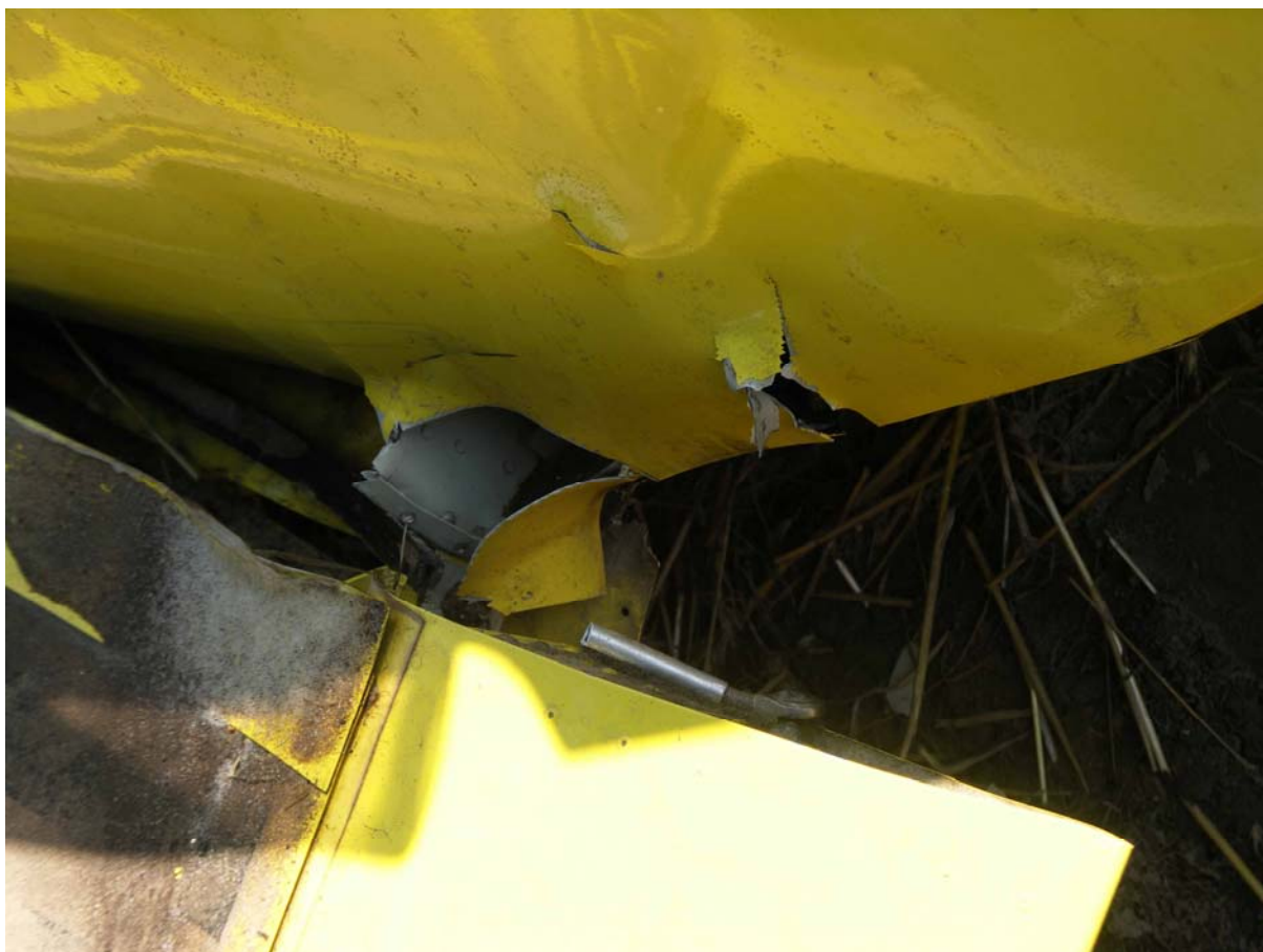
Fot.43 – Nasada lewego skrzydła – widać oderwaną końcówkę sterowania klapą.
