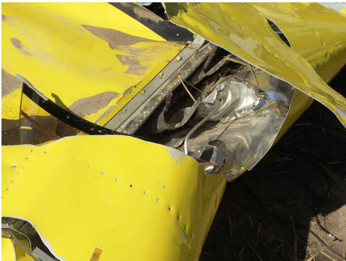
Fot.15 – Zniszczony zbiornik paliwa w nosku prawego skrzydła.
