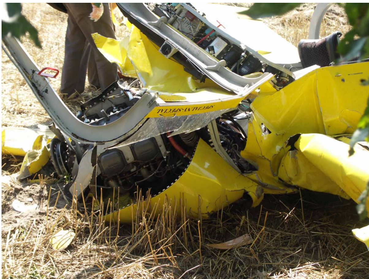
Fot.22 – Przednia część kadłuba i silnik, lewa strona.
