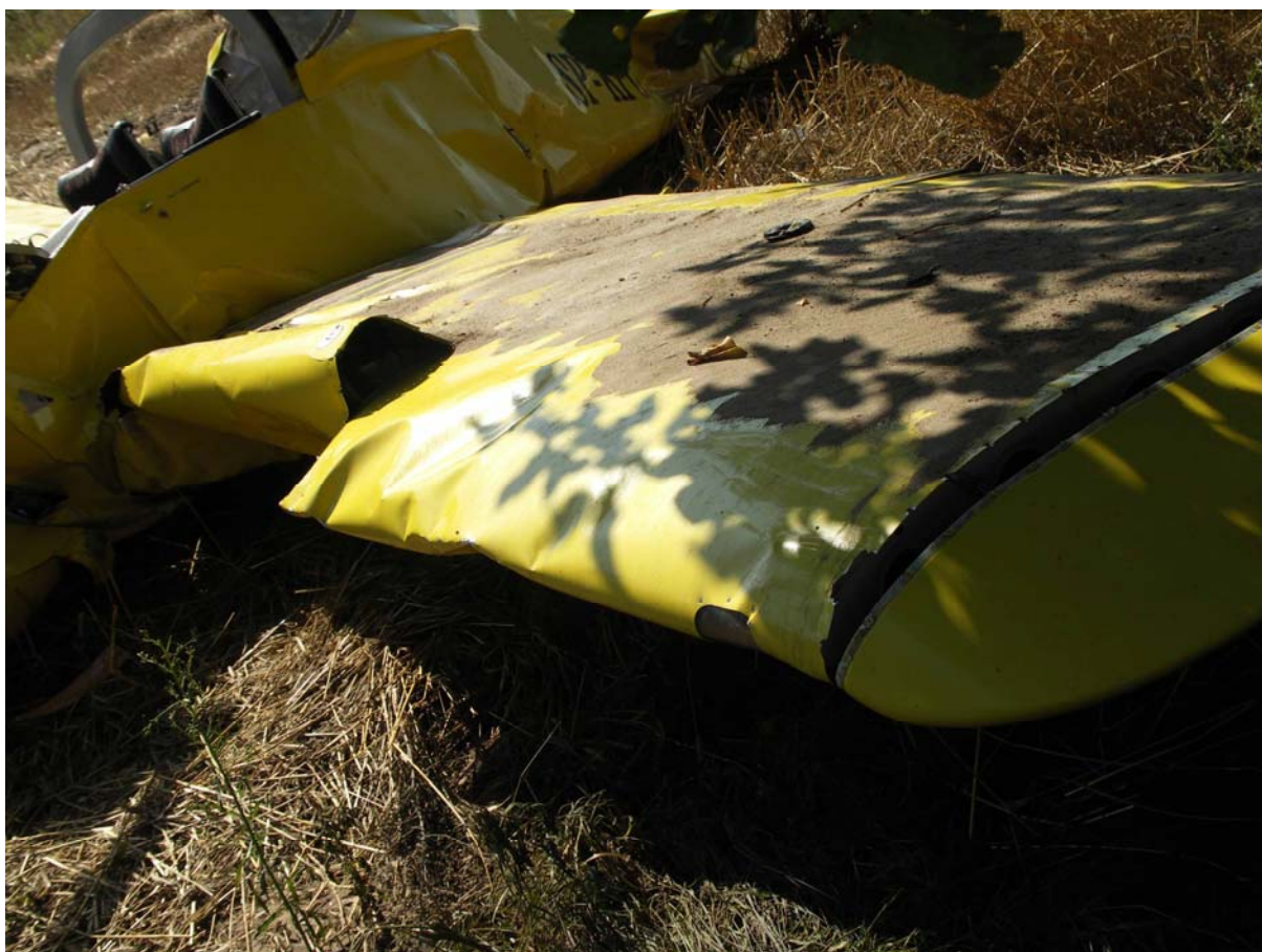
Fot.24 – Zniszczone lewe skrzydło.
