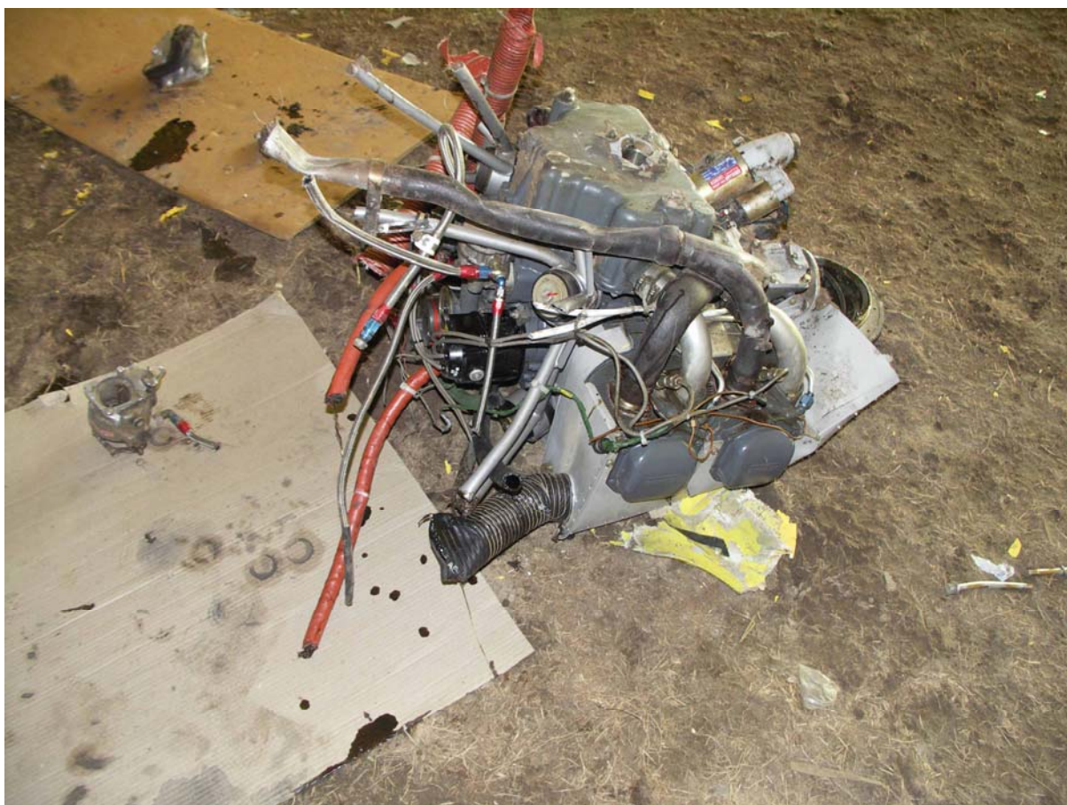
Fot.38 – Silnik odcięty od samolotu, widok z dołu i ¾ od tyłu z lewej, obok odłamany gaźnik.
