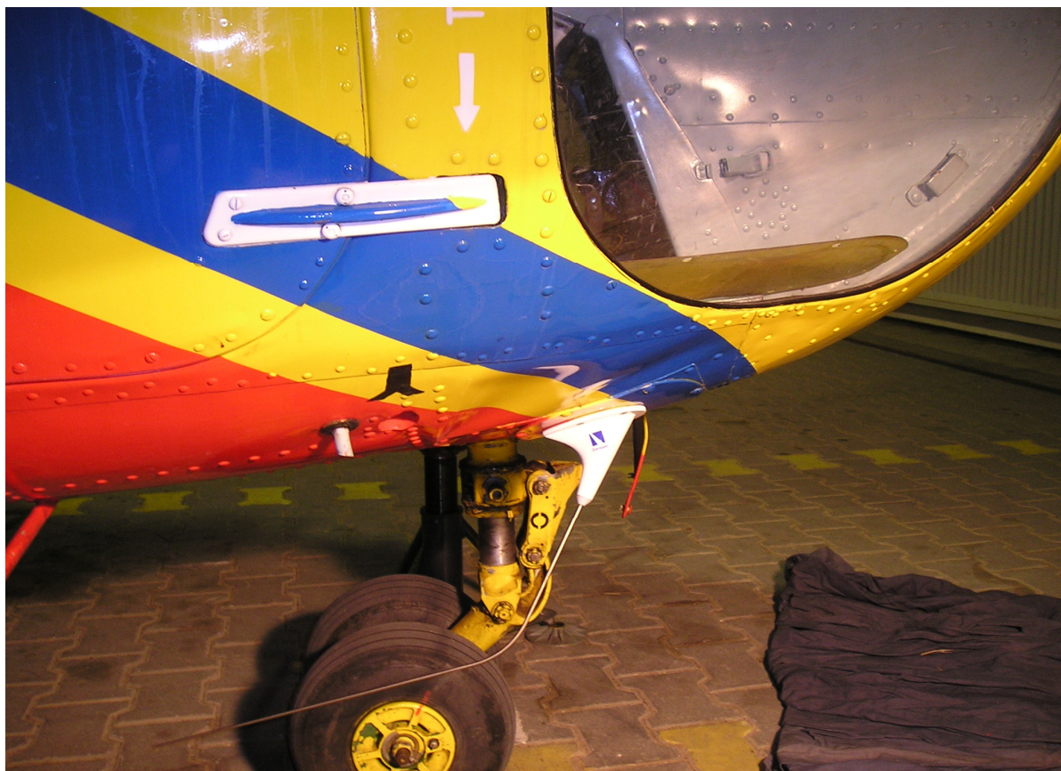
Fot.3 – Przednia część kadłuba – widoczne deformacje pokrycia w rejonie zamocowania podwozia.
