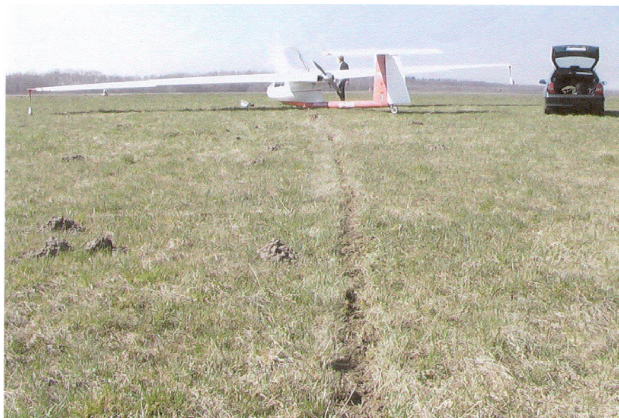
2 – Sytuacja krótko po zderzeniu. Widoczny ślad dobiegu na trawiastej nawierzchni lotniska.
