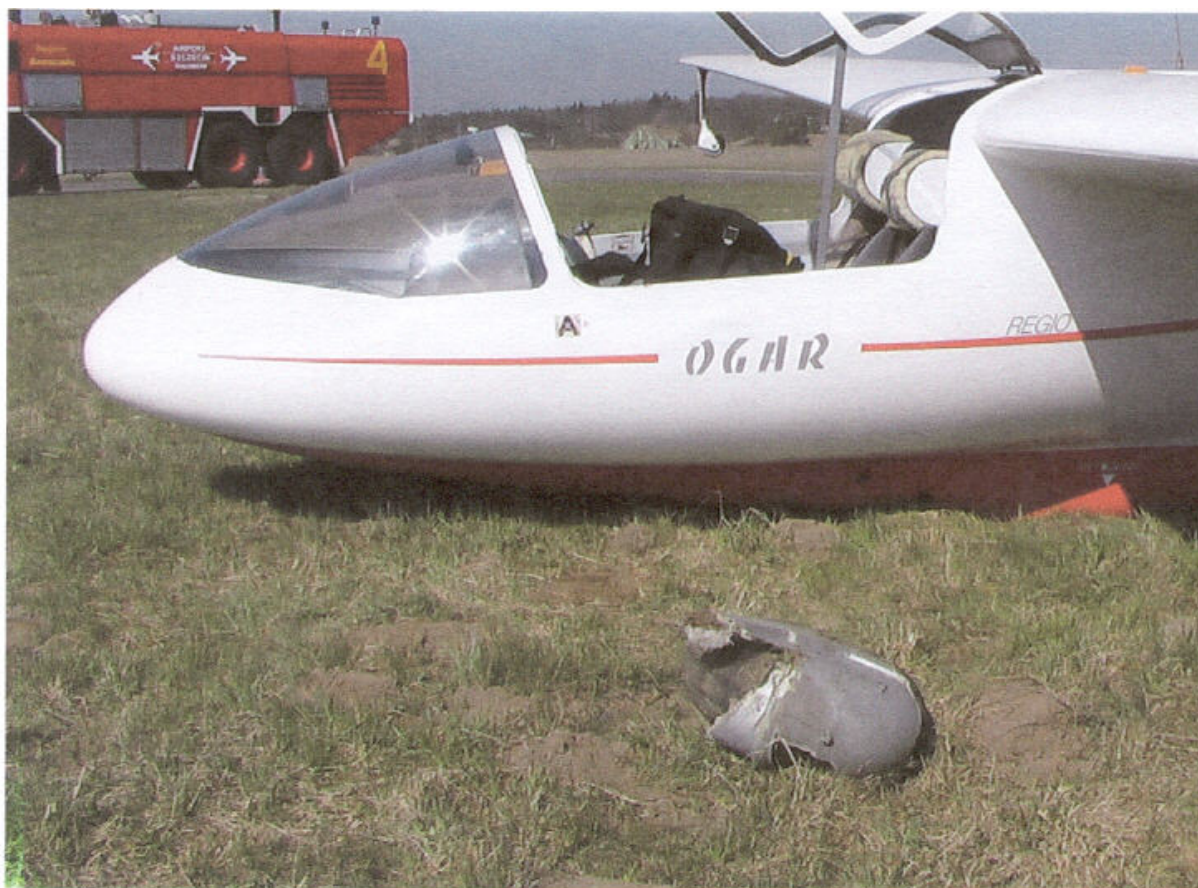
4 – Motoszybowiec po zatrzymaniu się na końcu dobiegu; obok wyłamane koło podwozia przedniego.
