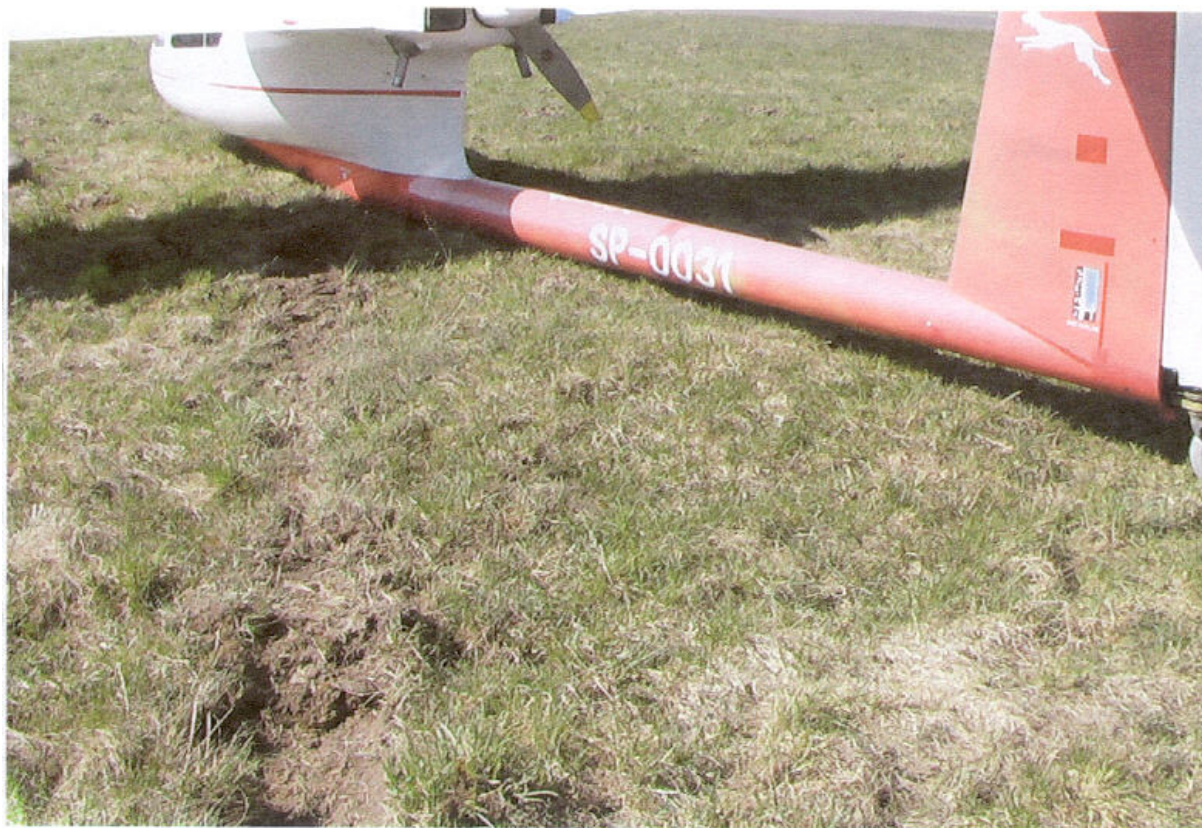
3 – Motoszybowiec po zatrzymaniu się na końcu dobiegu. Zwraca uwagę brak koła podwozia głównego, które zostało wyłamane.
