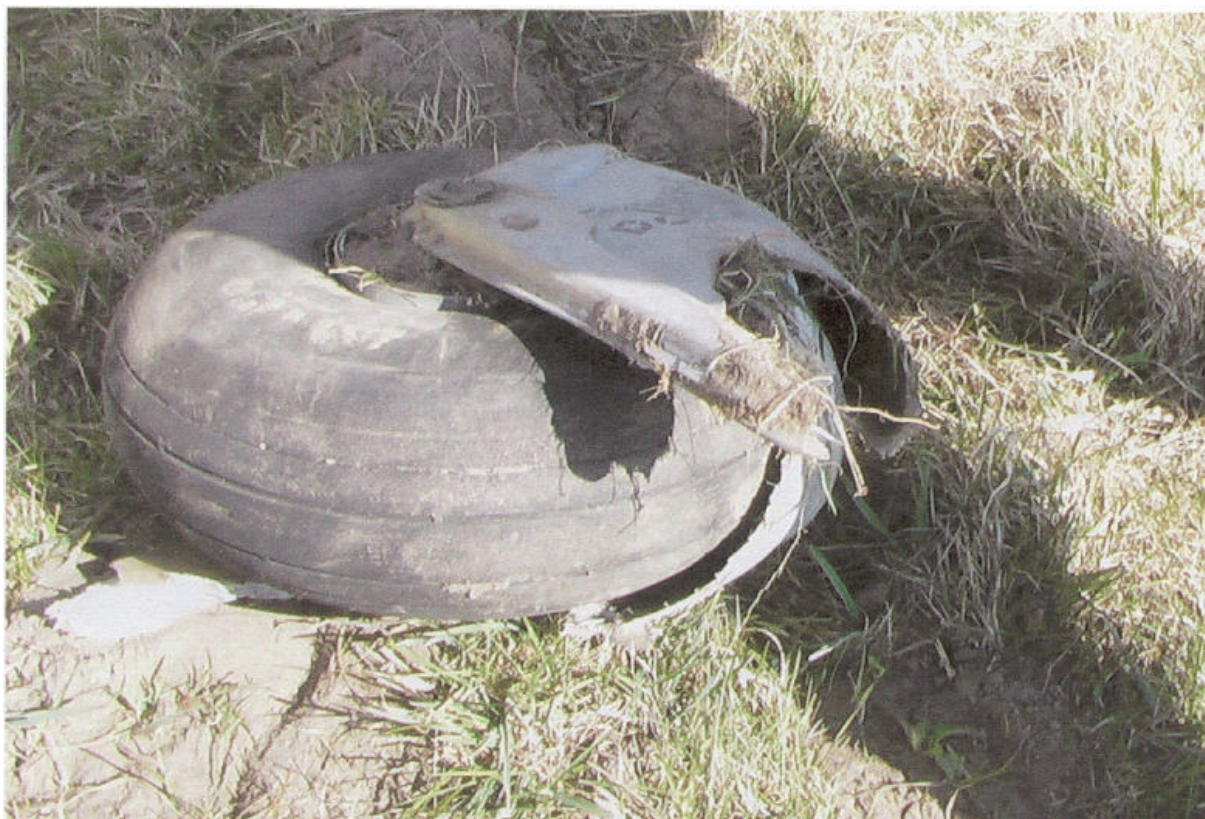
5 – Wyłamane koło podwozia przedniego.
