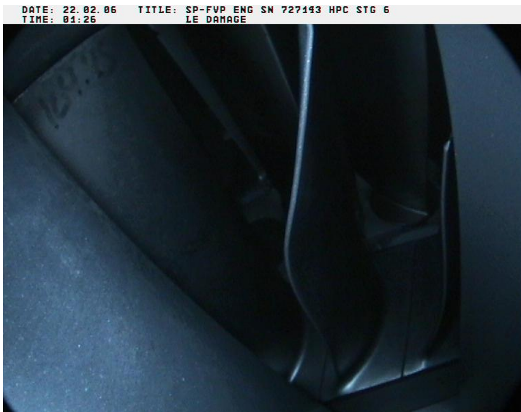
Fot. 3 Zdjęcia z inspekcji horoskopowej prawego silnika, stopień 6 sprężarki HPC
