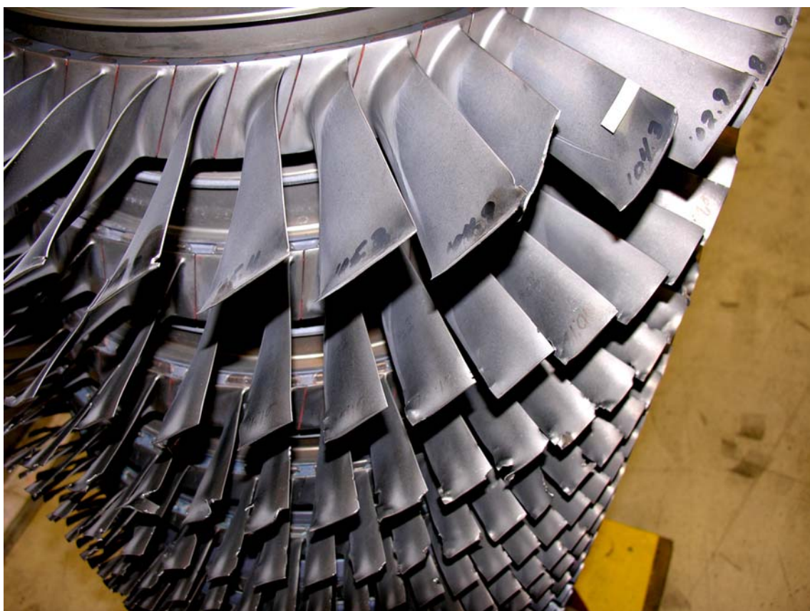
Fot. 2 Widok wirnika sprężarki wysokiego ciśnienia silnika lewego po rozbiórce silnika w MTU Maintenance Hannover
