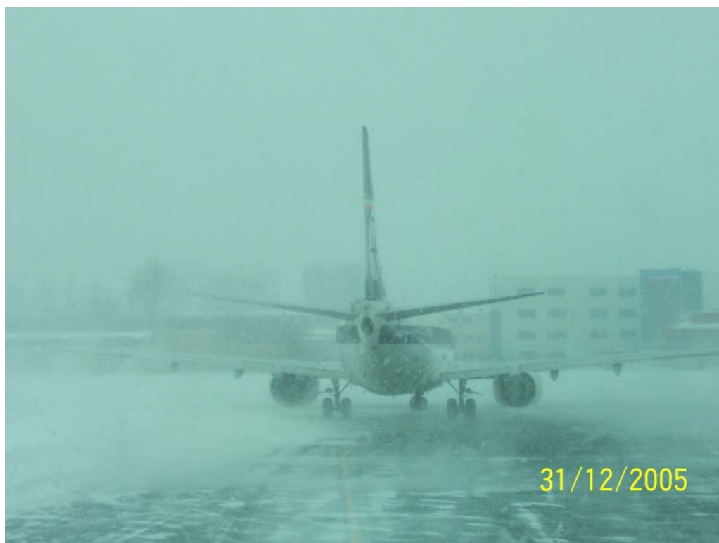
Fot. 7 Zdjęcie samolotu PLL LOT B-737 w chwilę po zagarnięciu śniegu przez silnik lewy co spowodowało samoczynne wyłączenie silnika (zdjęcia z incydentu, który miał na lotnisku Warszawa-Okęcie tego samego dnia 1 godzinę 19 minut po przerwany start samolotu rejsu FFP168).
