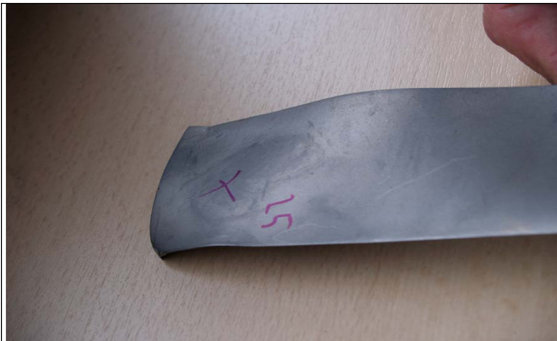
Zdj. 5 i 6. Przykładowe odkształcenia wierzchołków łopatek VI stopnia wirnikowego sprężarki
