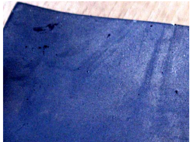
Zdj 3 Widok śladów nacieków na łopacie nr 2 po obróbce kontrastującej obraz.
