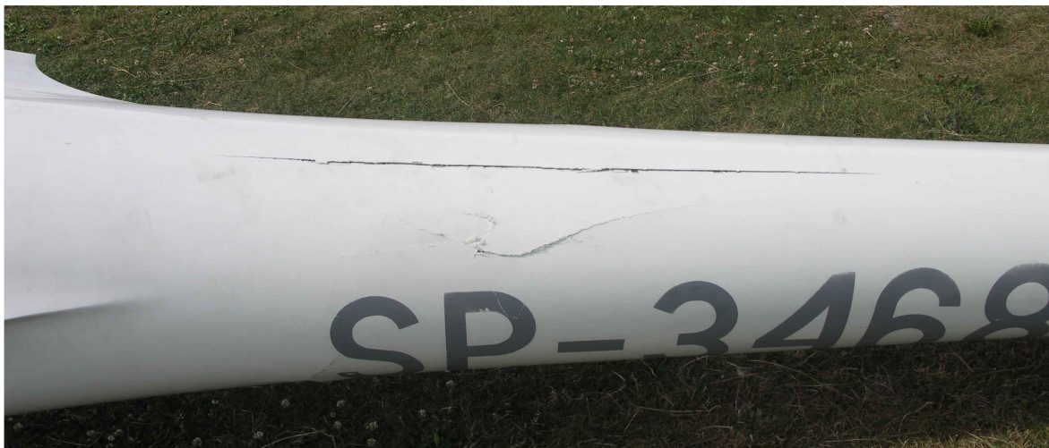
10 – Tylna część kadłuba z lewej strony – widoczne rozklejenie skorup na grzbiecie belki ogonowej.
