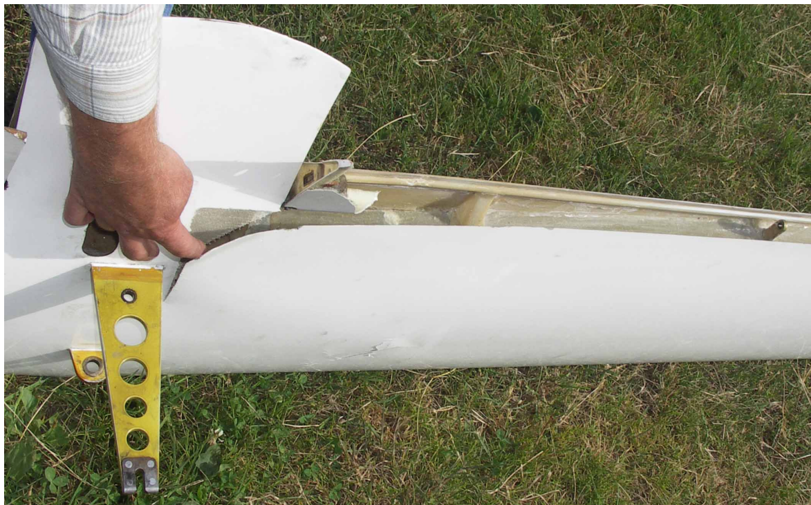
23 – Uszkodzenia statecznika poziomego po prawej stronie przy nasadzie od spodu – odwarstwienie pokrycia.
