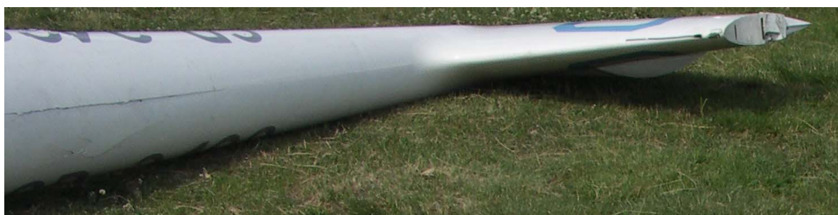
9 – Tylina część kadłuba od strony grzbietu – widoczne rozklejenie skorup.
