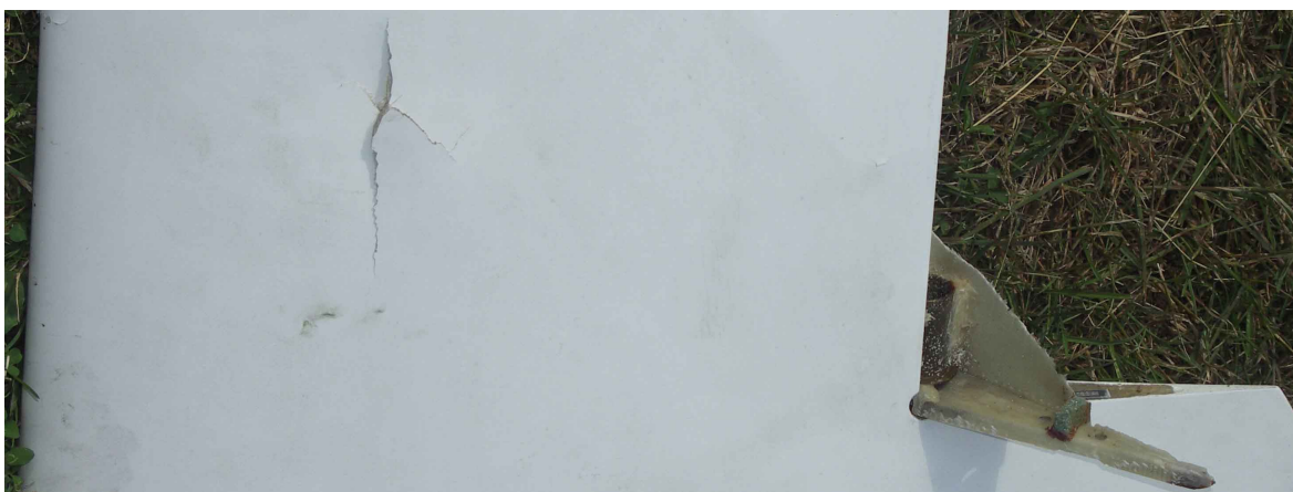
21 – Uszkodzenia statecznika poziomego po prawej stronie przy nasadzie od góry – pęknięcia pokrycia. Widoczne nasadowe żeberko prawej połówki steru wysokości, które po jej odłamaniu pozostało z fragmentem pokrycia steru przy stateczniku.
