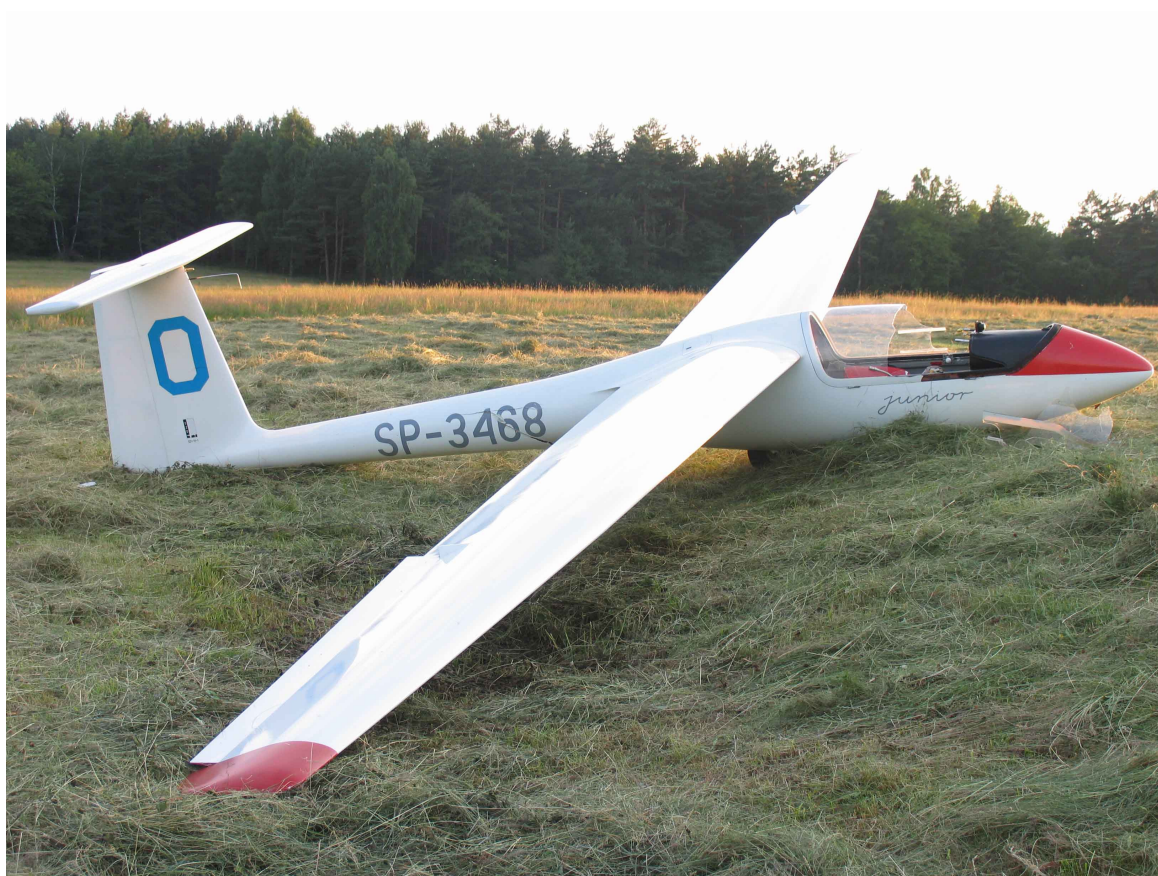
6 – Szybowiec w miejscu zakończenia dobiegu. Widoczne zgięcie terenu, które stało się przyczyną uszkodzenia szybowca.
