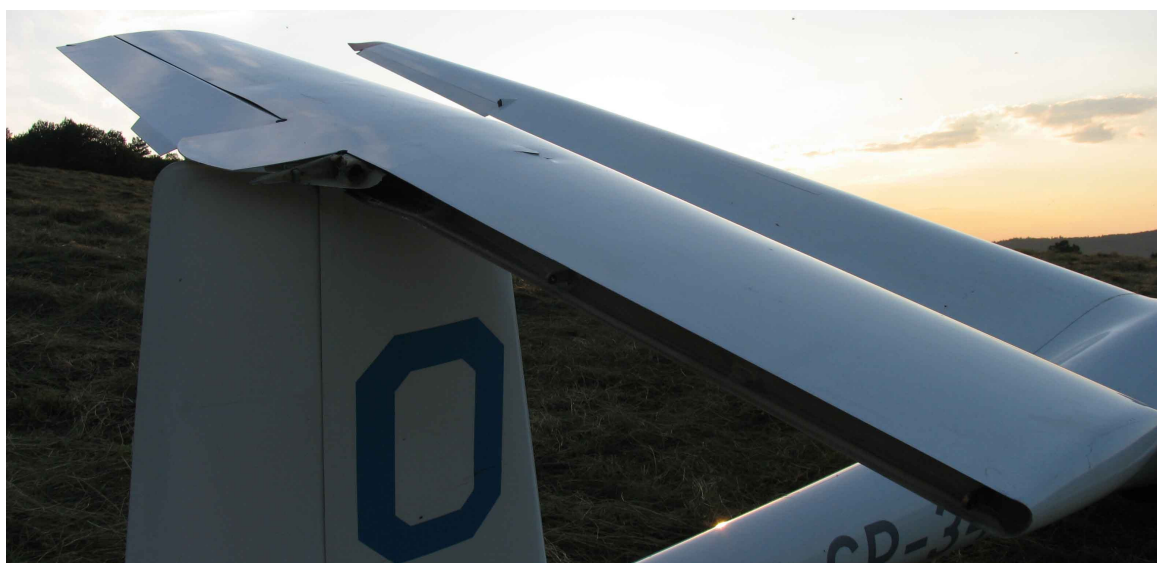
17 – Uszkodzone usterzenie poziome z oderwaną prawą połówką steru wysokości.
