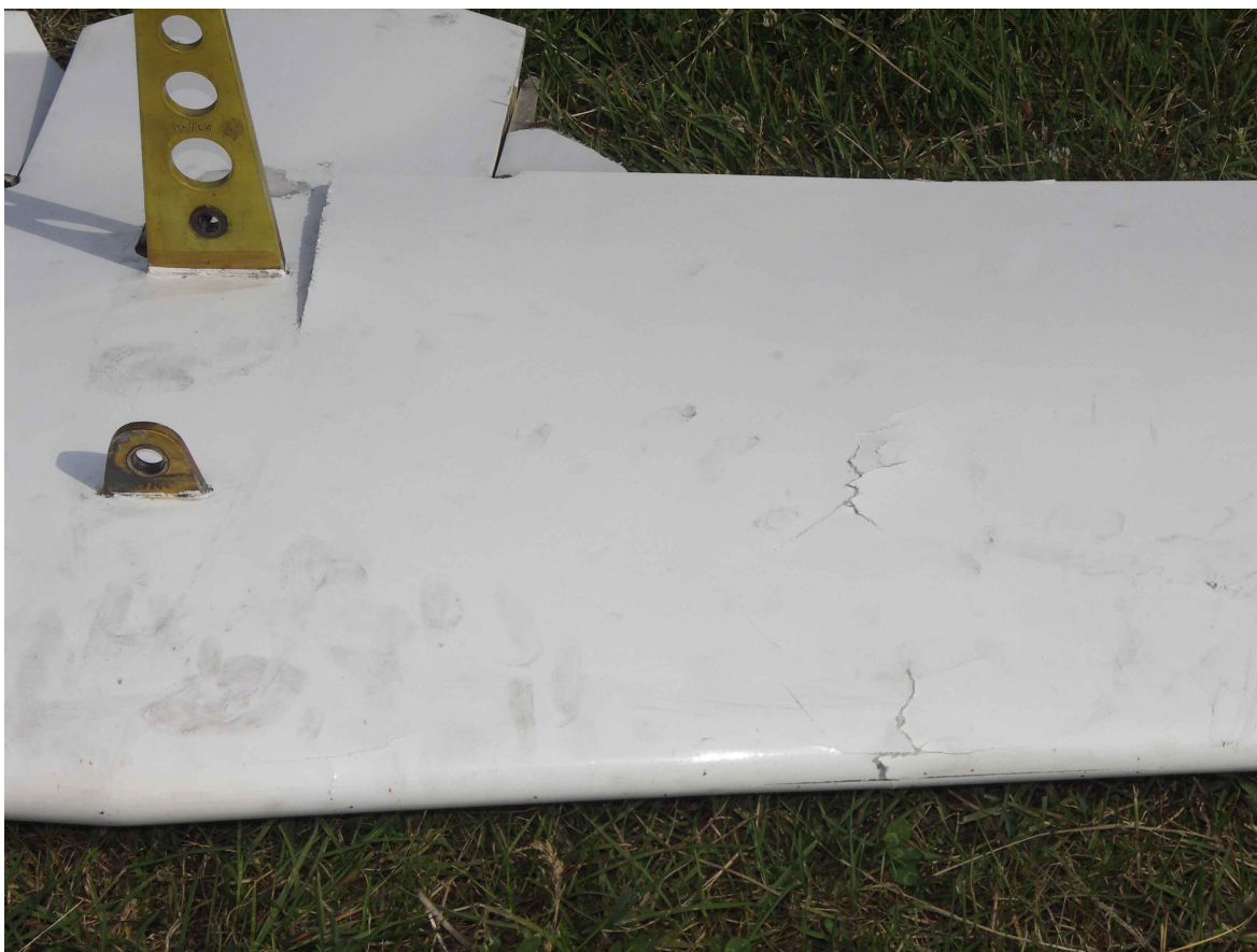
22 – Uszkodzenia statecznika poziomego po prawej stronie przy nasadzie od spodu – pęknięcia pokrycia.
