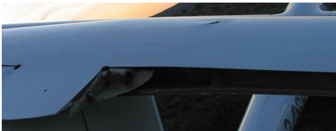
18 – Uszkodzenia statecznika poziomego. Widoczne wyrwane nasadowe żebro prawej połówki steru wysokości, pozostałe przy stateczniku i przebicie pokrycia statecznika poziomego.
