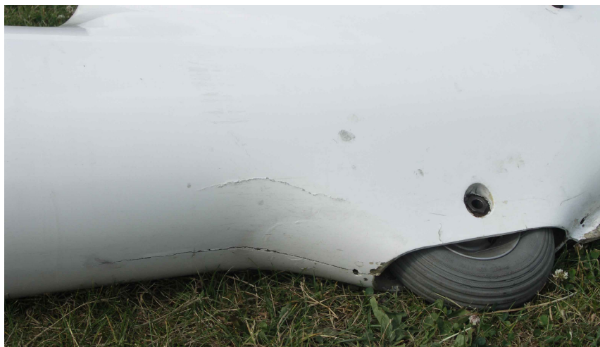
16 – Pęknięcie i rozklejenie skorup belki ogonowej po lewej stronie kadłuba przy kółku ogonowym.
