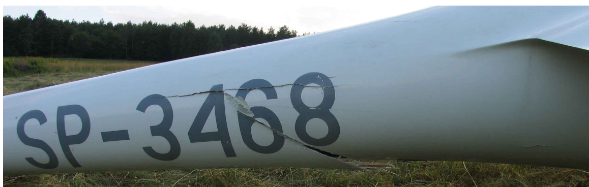
14 – Prawa strona kadłuba – widoczne uszkodzenia belki ogonowej.
