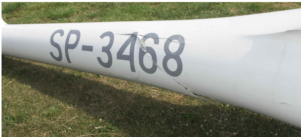
13 – Prawa strona kadłuba – widoczne uszkodzenia belki ogonowej.
