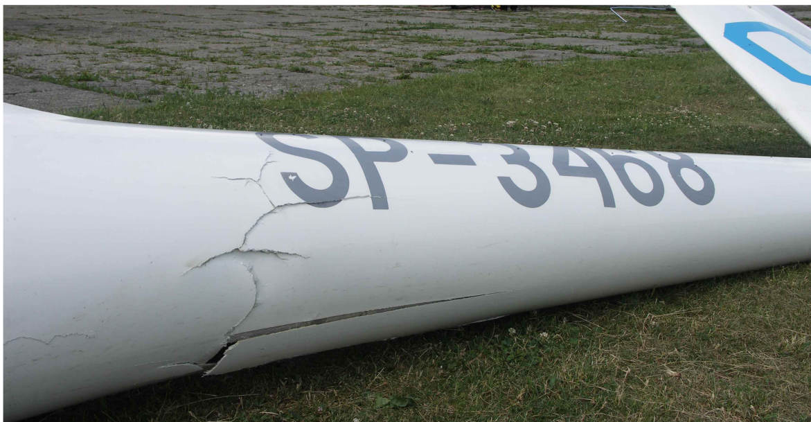
11 – Tylna część kadłuba z lewej strony – widoczne uszkodzenia spodu belki ogonowej.
