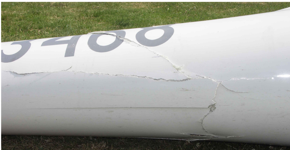
12 – Uszkodzenia belki ogonowej od spodu kadłuba.
