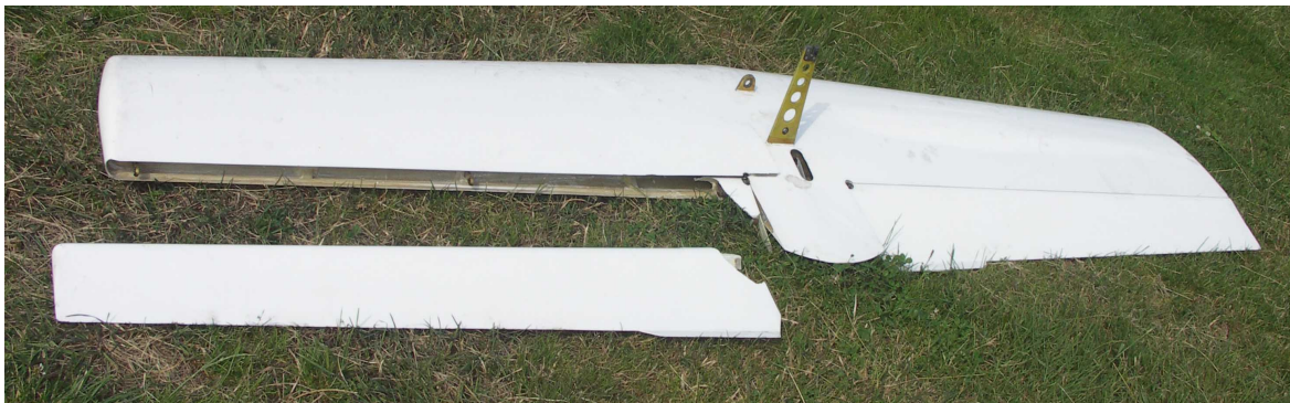
20 – Zdemontowane usterzenie poziome od spodu, widoczne uszkodzenia.
