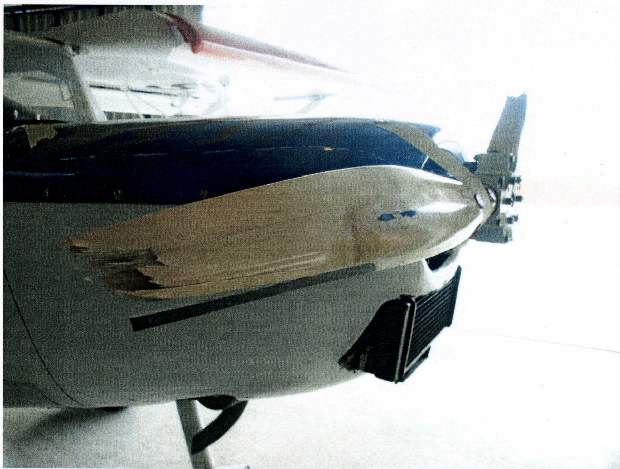
Fot.5 – Łopata śmigła z odłamaną końcówką.
