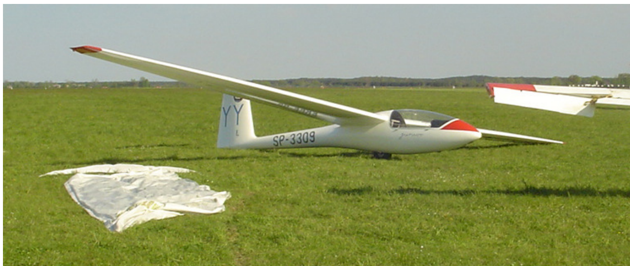
Fot.5 – Szybowiec SZD-51-1 Junior SP-3309, z prawej uszkodzona końcówka skrzydła szybowca SZD-9bis Bocian SP-2804 (zdjęcie wykonane z przeciwnej strony, niż Fot.4).
