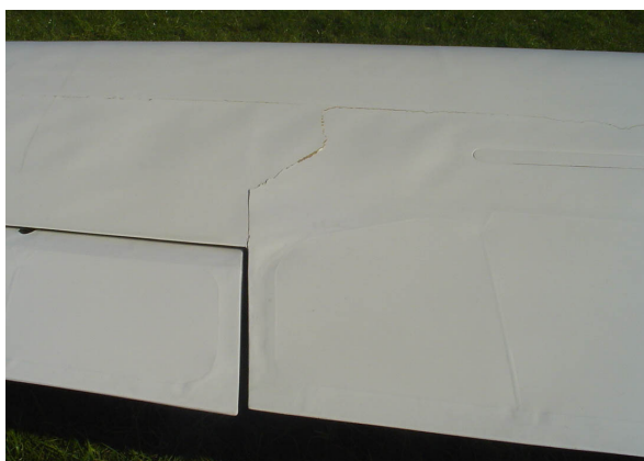
Fot.8 i 9 – Uszkodzenia górnej powierzchni lewego skrzydła i lotki szybowca SZD-9bis Bocian SP-2804.
