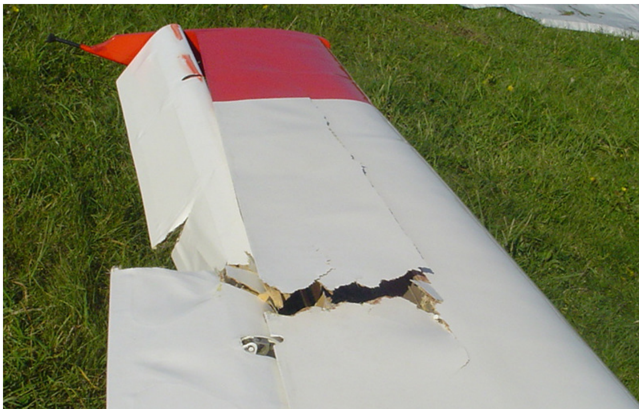
Fot.8 – Uszkodzona końcówka lewego skrzydła i lewa lotka szybowca SZD-9bis Bocian SP-2804.
