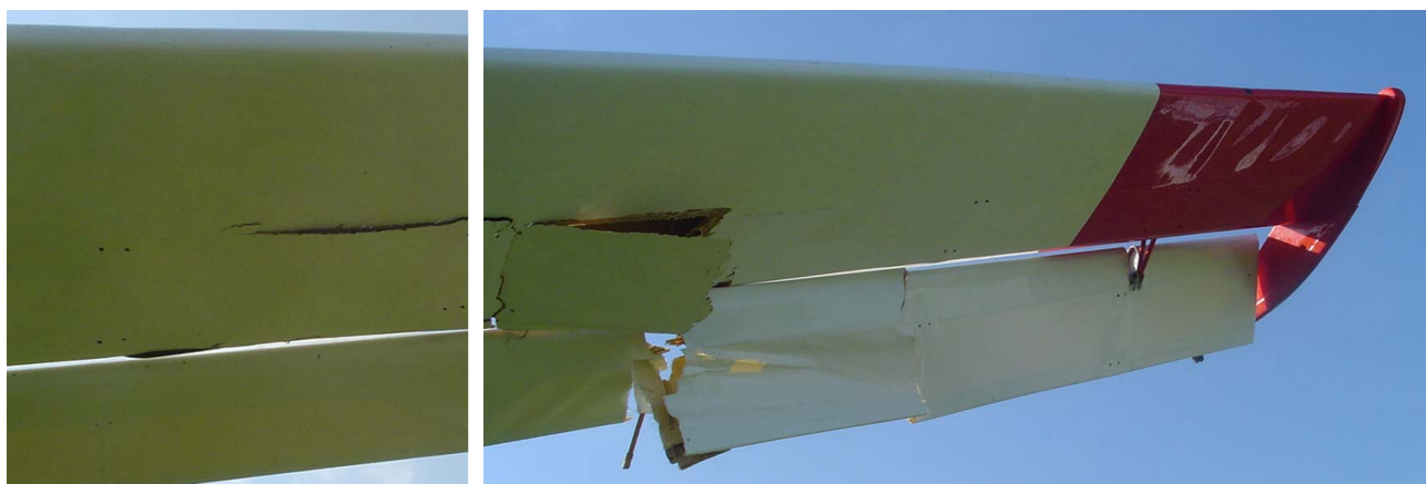
Fot.12 i 13 - Uszkodzenia dolnej powierzchni lewego skrzydła i lotki szybowca SZD-9bis Bocian SP-2804.
