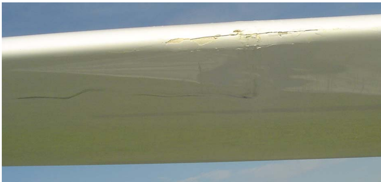
Fot.6 i 7 – Uszkodzenia szybowca SZD-51-1 Junior SP-3309 – u góry krawędź natarcia prawego skrzydła w miejscu kolizji, u dołu uszkodzenie wskutek przekroczenia naprężeń i wyboczenia pokrycia u jego nasady.
