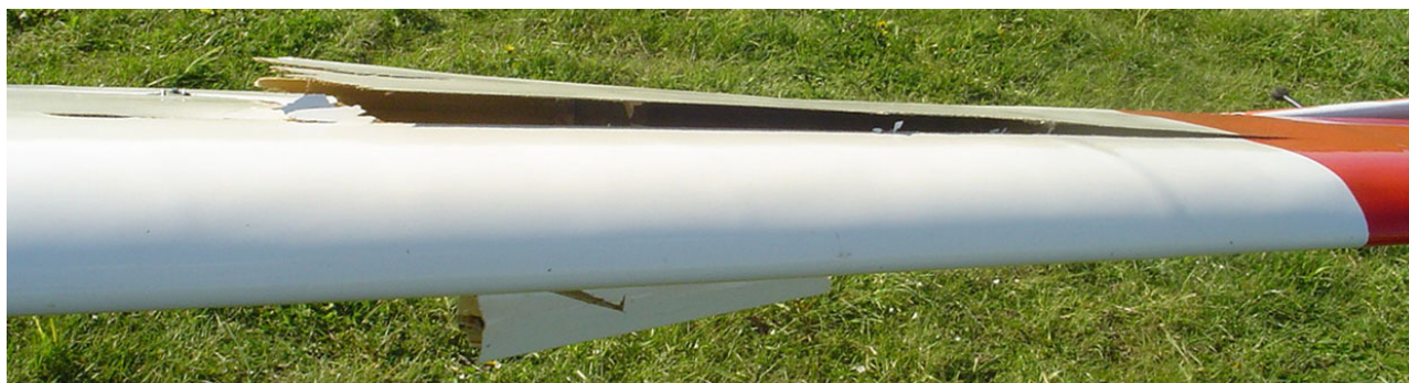
Fot.10 - Uszkodzenia lewego skrzydła i lotki szybowca SZD-9bis Bocian SP-2804 widziane od przodu.
