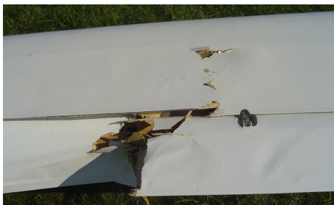
Fot.8 i 9 – Uszkodzenia górnej powierzchni lewego skrzydła i lotki szybowca SZD-9bis Bocian SP-2804.
