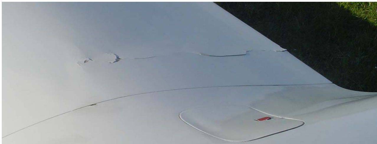
Fot.6 i 7 – Uszkodzenia szybowca SZD-51-1 Junior SP-3309 – u góry krawędź natarcia prawego skrzydła w miejscu kolizji, u dołu uszkodzenie wskutek przekroczenia naprężeń i wyboczenia pokrycia u jego nasady.
