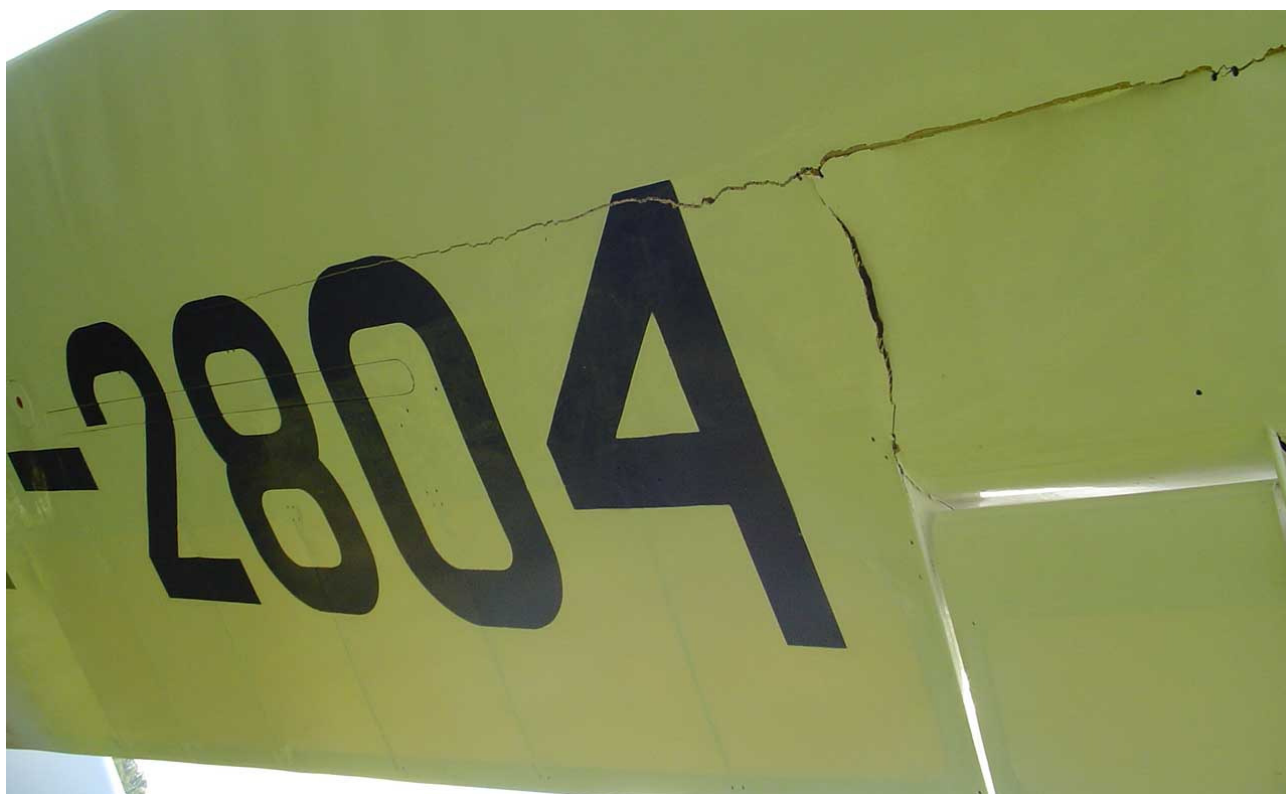
Fot.11 – Uszkodzenia dolnej powierzchni lewego skrzydła szybowca SZD-9bis Bocian SP-2804.
