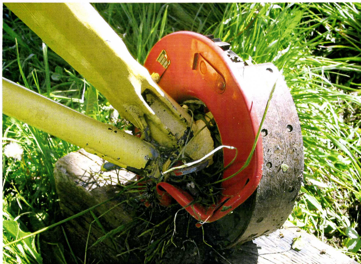
Fot.14 – Uszkodzone lewe podwozie od strony wewnętrznej.
