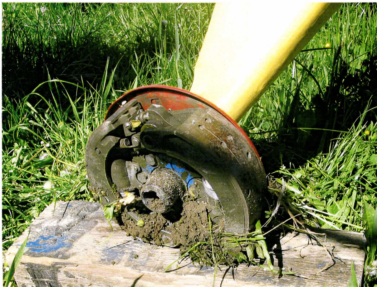
Fot.13 – Uszkodzone lewe podwozie od strony zewnętrznej.
