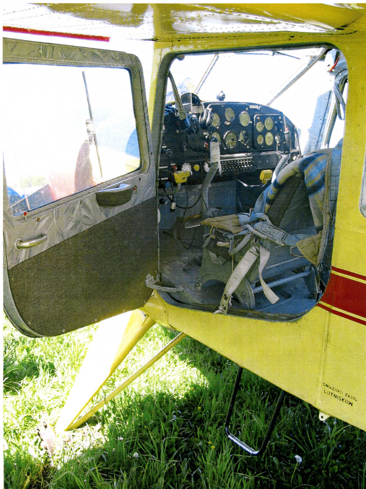
Fot.12 – Widok kabiny i uszkodzonego podwozia po lądowaniu.
