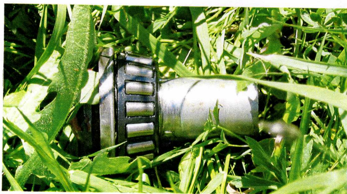
Fot.3 i 4 – Odłamana oś z łożyskiem (po lewej) i osłona łożyska (po prawej).
