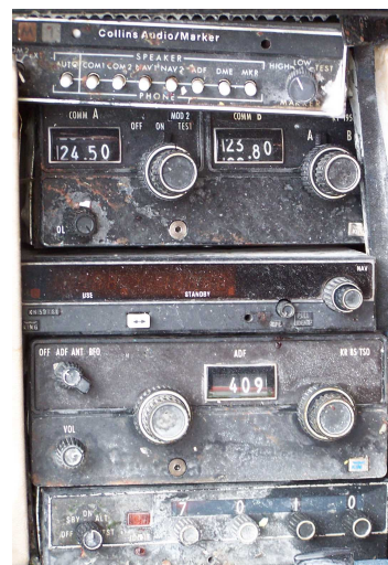
Fot.22 – Wyposażenie radionawigacyjne i radiokomunikacyjne, zachowane nastawy wybranych częstotliwości.
