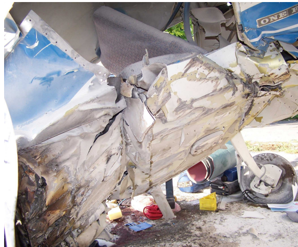
Fot.14 – Przednia część kadłuba od spodu – po lewej stronie zdjęcia widać ślady pożaru.
