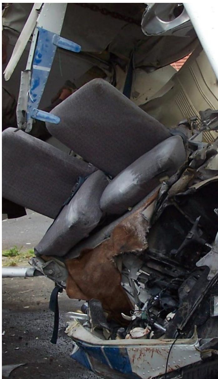
Fot.25 – Wnętrze kabiny po rozcięciu kadłuba. W dolnej części (pod podłogą) widać ślady pożaru. Pod sufitem widoczny prawy pas barkowy. Na siedziskach foteli pasy biodrowe, przecięte podczas wyjmowania ciał załogi.
