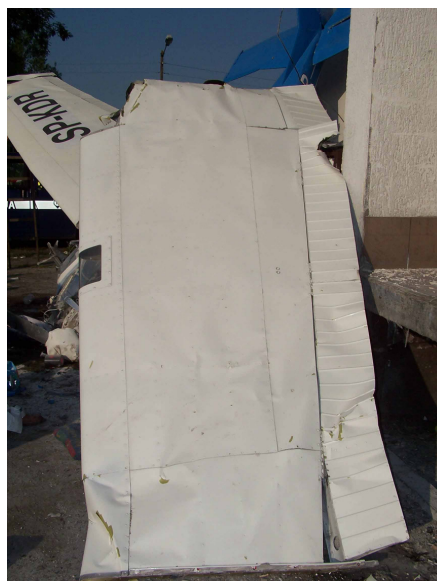
Fot.6 – Złamane lewe skrzydło, widok ogólny.
