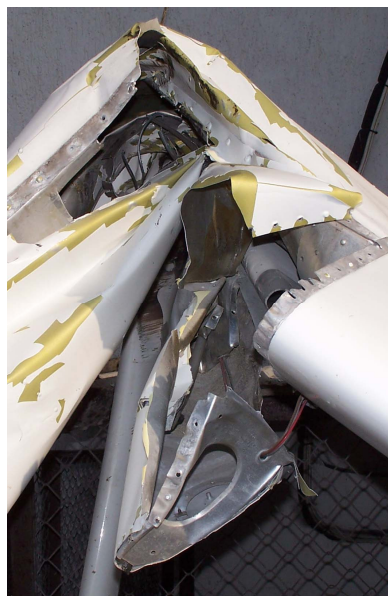
Fot.8 – Zbliżenie miejsca złamania lewego skrzydła.
