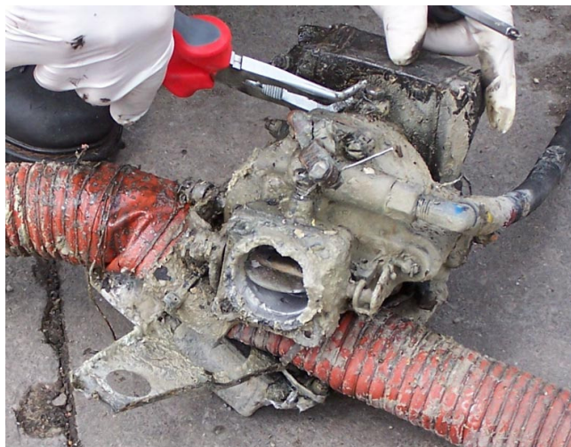
Fot.19 – Odłamany od silnika gaźnik. Widoczne przewody powietrzne (czerwone) i przewód paliwowy (czarny).
