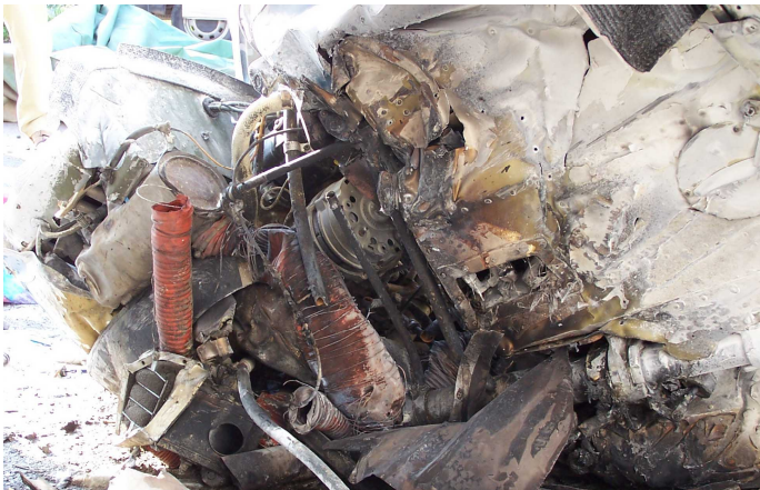
Fot.15 – Przednia część kadłuba od spodu, widok w kierunku silnika. Dobrze widoczne ślady pożaru na dolnym pokryciu kadłuba i agregatach silnika.
