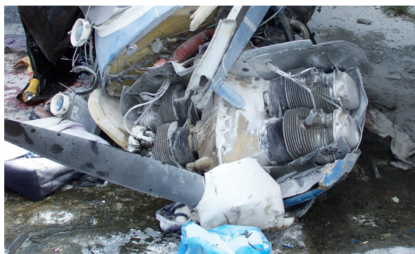
Fot.17 – Wyrwany z łoża zespół napędowy, widok ogólny. Widoczna nieuszkodzona jedna z łopat śmigła. Rodzaj i sposób uszkodzeń śmigła świadczy o tym, że nie obracało się ono w chwili zderzenia z budynkiem.
