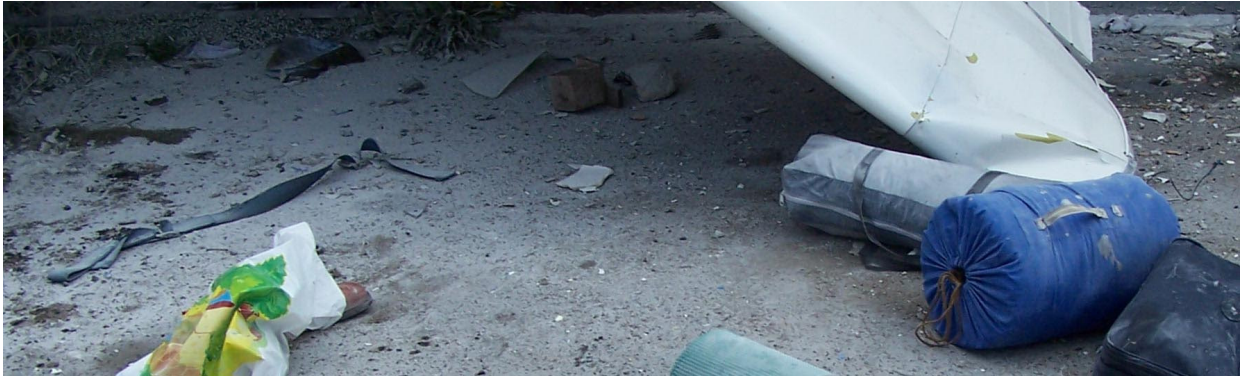
Fot.26 – Przedmioty, które wypadły bądź zostały wyjęte z kabiny podczas akcji ratunkowej, leżące obok opartej o ziemię końcówki lewego skrzydła. Po lewej stronie zdjęcia widoczny barkowy pas bezpieczeństwa.
