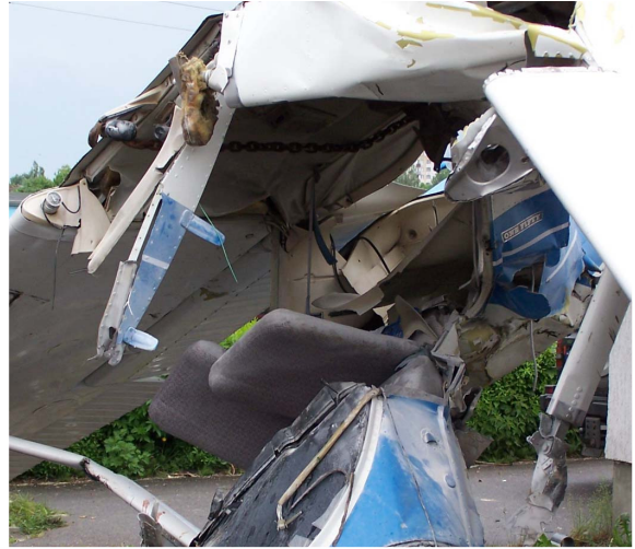
Fot.12 – Lewa strona przedniej części kadłuba podczas cięcia i unoszenia wraku. Pod sufitem kabiny widać prawy pas barkowy
