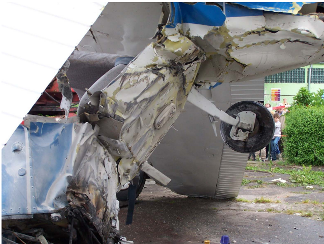
Fot.13 – Przednia część kadłuba od spodu, widok ogólny. Widoczne ślady pożaru w rejonie przegrody ogniowej.
