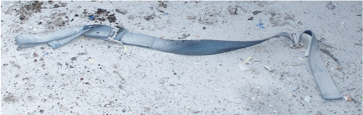
Fot.27 – Zbliżenie barkowego pasa bezpieczeństwa z fot.26. Jego stan świadczy o tym, że nie był prawidłowo zamocowany w samolocie, a co za tym idzie, nie mógł być używany zgodnie z przeznaczeniem.
