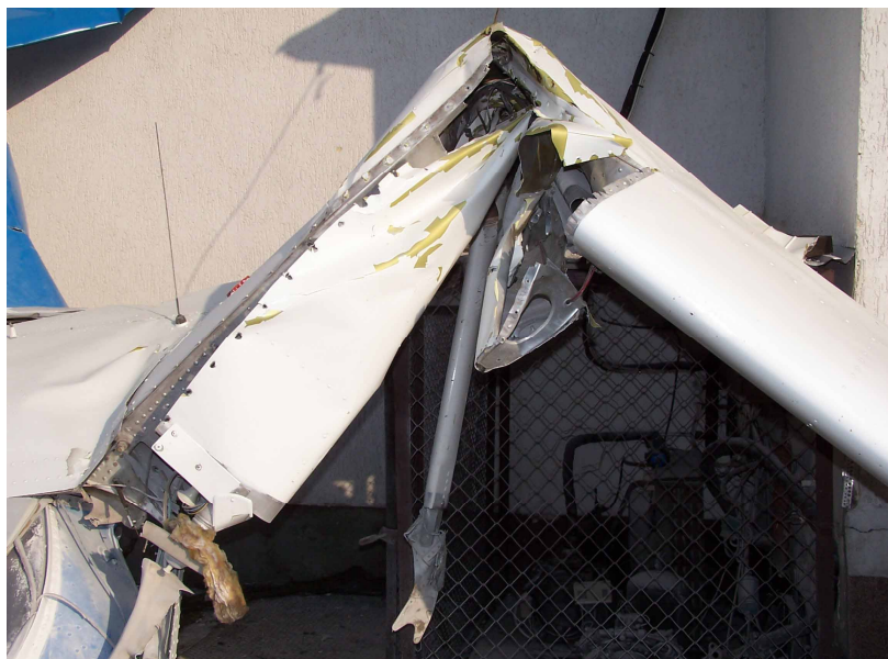
Fot.7 – Złamane lewe skrzydło, widoczny zastrzał i jego dolne okucie, wyrwane z kadłuba.
