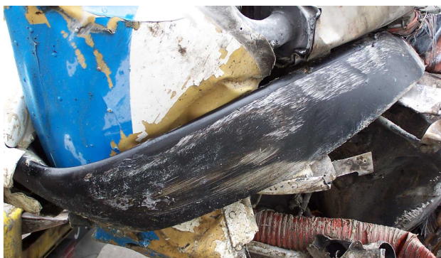
Fot.18 – Druga łopata śmigła, zagięta pod spód kadłuba podczas zderzenia z budynkiem. Rodzaj i sposób uszkodzeń śmigła świadczy o tym, że nie obracało się ono w chwili zderzenia z budynkiem.
