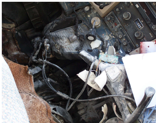
Fot.23 – Dolna część pulpitu centralnego i podłoga kabiny z widocznymi śladami pożaru.
