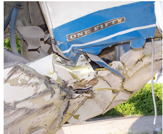
Fot.16 – Przednia część kadłuba od spodu. Uszkodzenia konstrukcji za wykrojem drzwi. W lewym górnym rogu zdjęcia widać prawy barkowy pas bezpieczeństwa.
