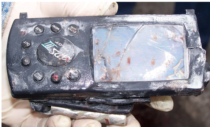
Fot.24 – Uszkodzone urządzenie do nawigacji satelitarnej GPS III Pilot.
