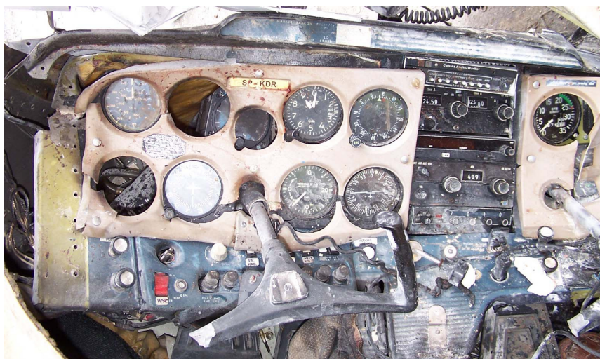
Fot.21 – Tablica przyrządów, widok ogólny. Niektóre przyrządy wyrwane z tablicy, wgniezionej uderzeniem głowy pilota-dowódcy. Widać także ślady pożaru. Widoczna wyłamana w dół sterownica ręczna (wolant) pilota-dowódcy.
