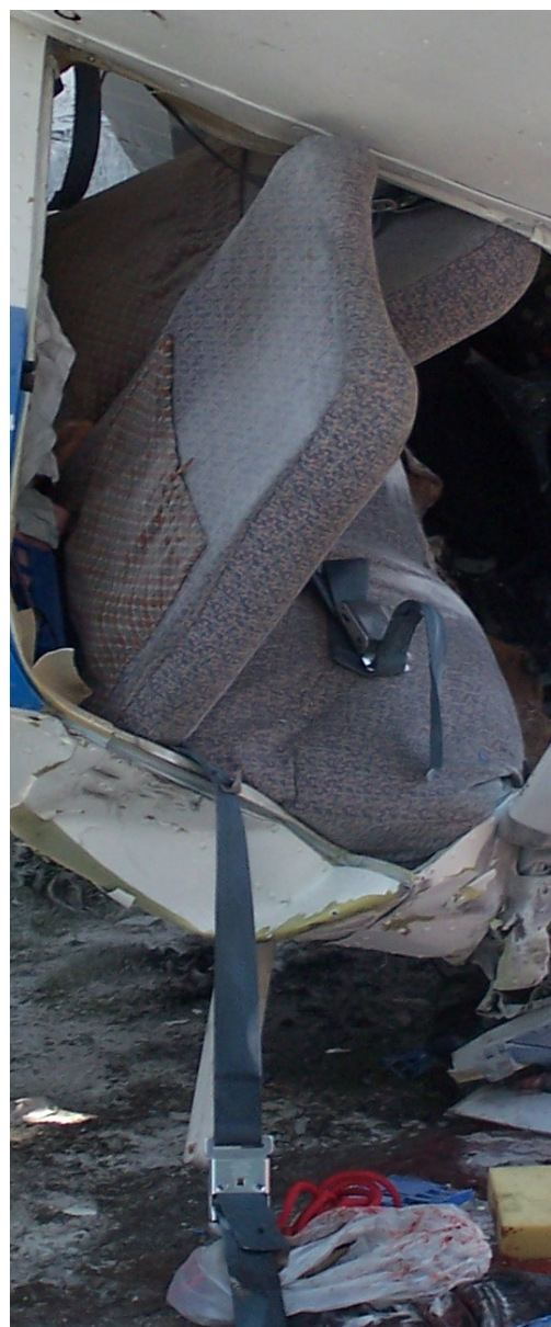
Fot.26 – Fotele i pasy bezpieczeństwa w widoku z prawej strony kadłuba – pasy biodrowe przecięte podczas wyjmowania ciał załogi.
