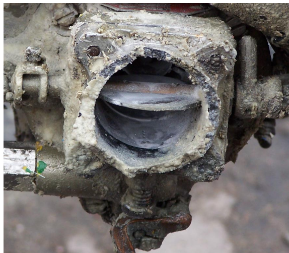
Fot.20 – Gardziel odłamanego od silnika gaźnika. Dobrze widoczna klapka przepustnicy w kanale wlotowym.
