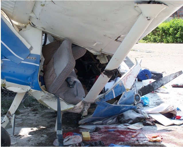
Fot.11 – Prawa strona przedniej części kadłuba. Na ocalałym zastrzale prawego skrzydła widać ślad smoły z dachu budynku.
