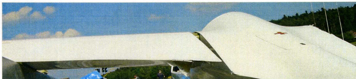
16 – Widok z tyłu na grzbiet środkowej części kadłuba, widoczne uszkodzenia lewego skrzydła u nasady.
