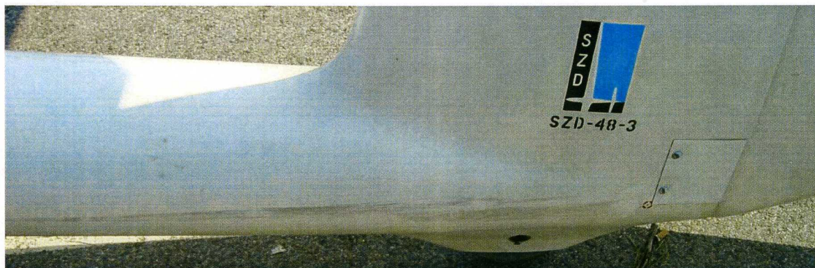
14 – Tylna część kadłuba z lewej strony, widoczne rysy wskutek tarcia o ogrodzenie.
