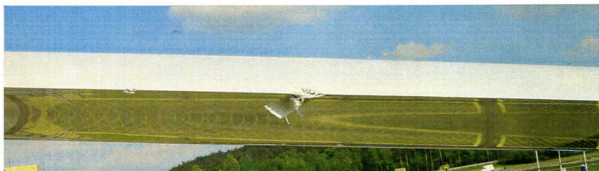
17 – Uszkodzenia krawędzi spływu lewego skrzydła.
