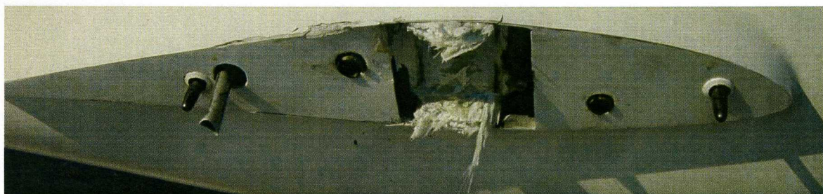
12 – Kadłub z prawej strony po wyłamaniu prawego skrzydła.
