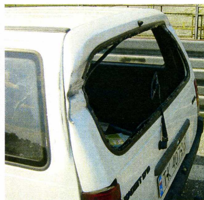
4 i 5 – samochód uszkodzony przez uderzenie prawym skrzydłem szybowca – widok ogólny i zbliżenie.
