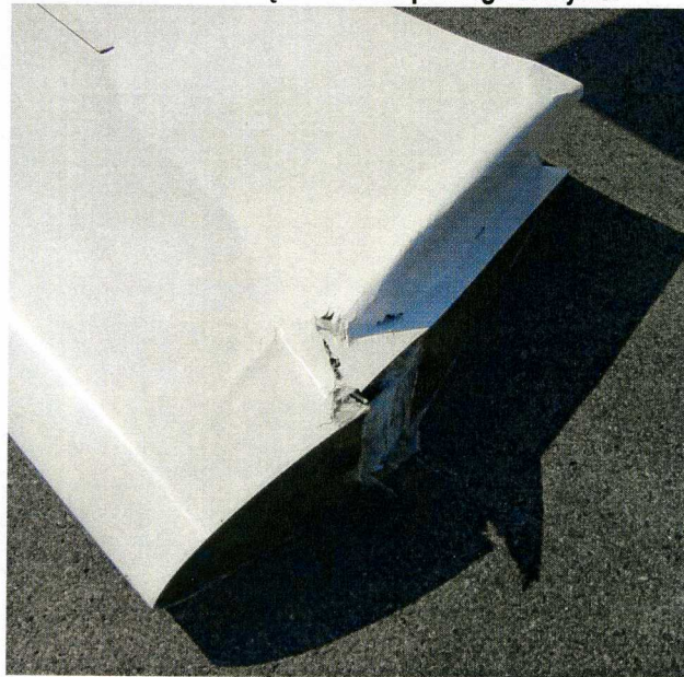
22 – Uszkodzenia nasady prawego skrzydła.
