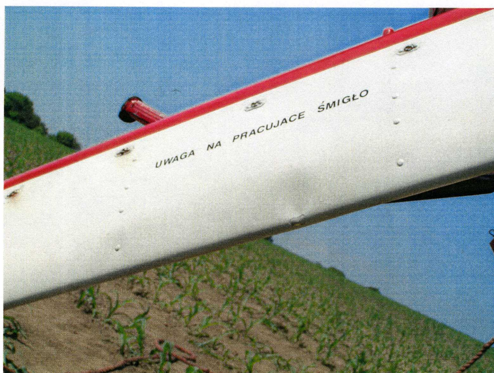
Fot. 10 – uszkodzenie osłony goleni lewej
