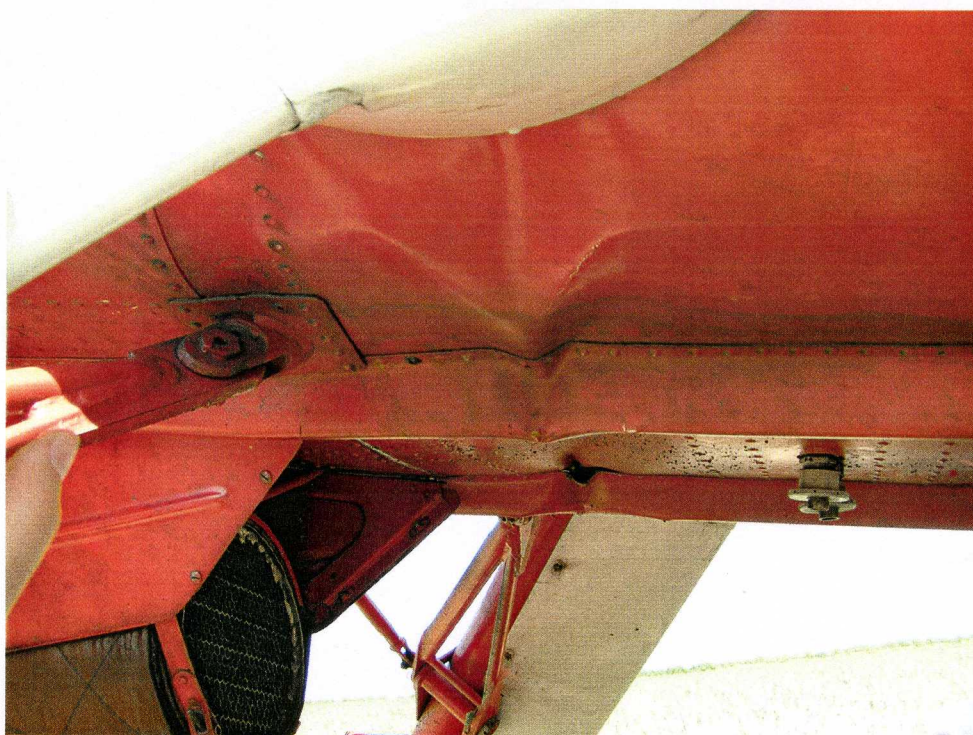
Fot. 9 - uszkodzenie blach dolnego pokrycia kadłuba za węzłem mocowania goleni podwozia głównego – strona lewa.
