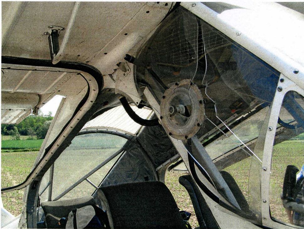
Fot. 3 – uszkodzenie wręgi nr 2, drzwi prawych oraz bocznego oszklenia kabiny
