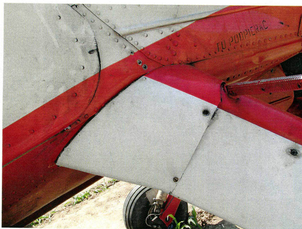
Fot. 6 – uszkodzenie prawej goleni oraz drzwi prawych - szczegóły
