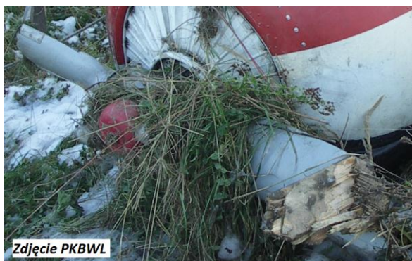
Rys.2. Czołowa część samolotu widoczne zamknięte zasłonki silnika
