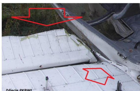
Rys.3. Uszkodzenia klap i mocowania lewego skrzydła
