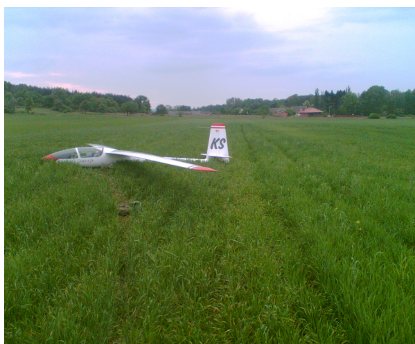
3 – Szybowiec po wylądowaniu – widać ślad w uprawach i wyłamane koło podwozia.
