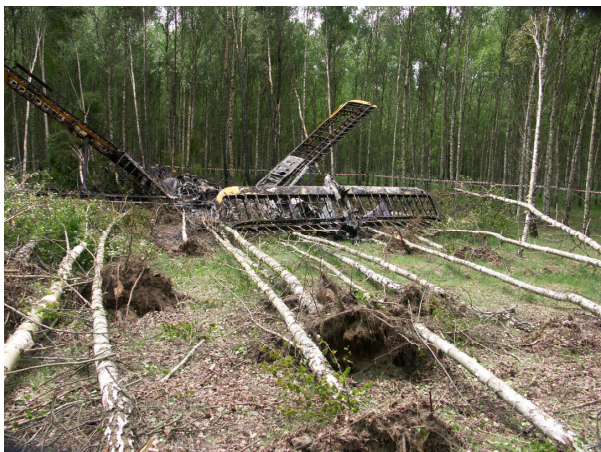
Fotografie ilustrują sposób ‘amortyzacji’ lądowania przez kolejno powalane brzozy
