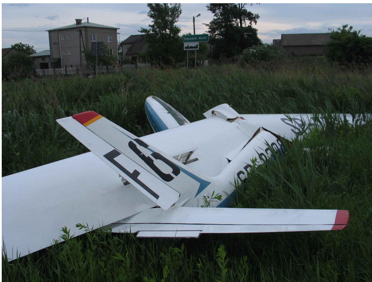
9 – Ogólny widok rozbitego szybowca, na pierwszym planie odłamane lewe skrzydło i tylna część kadłuba.
