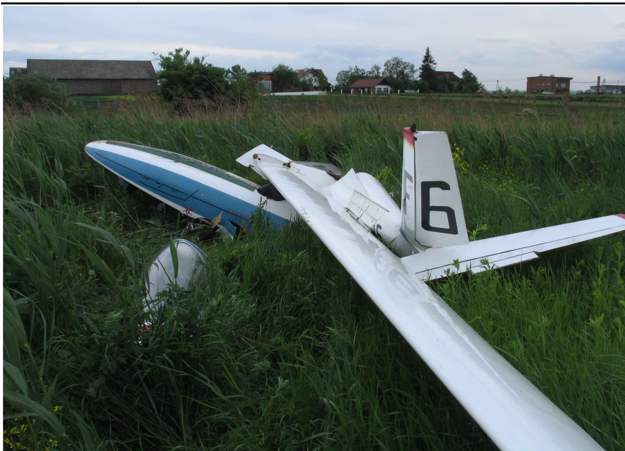
10 – Ogólny widok rozbitego szybowca, na pierwszym planie odłamane lewe skrzydło.
