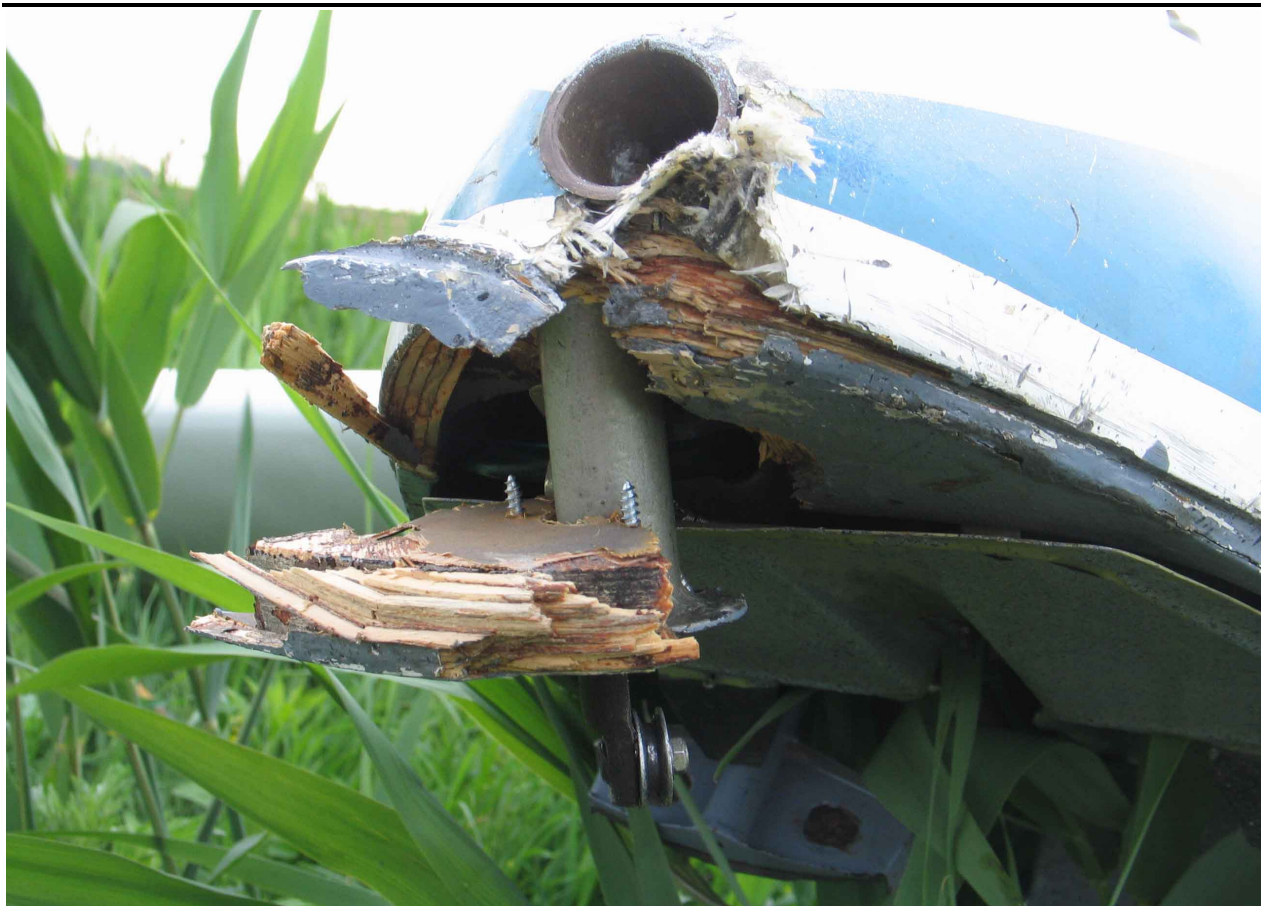
14 – Zniszczony przód kadłuba ze śladami uderzenia w ziemię.
