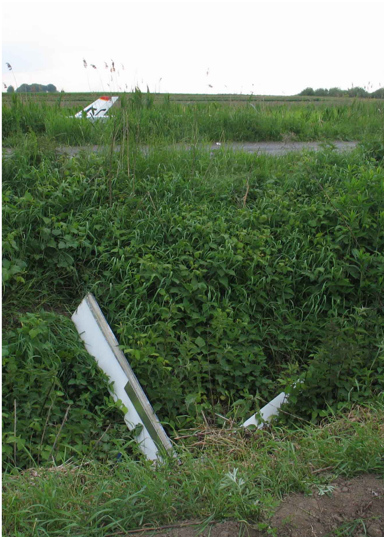
5 – Ogólny widok szczątków szybowca w kierunku zgodnym z kierunkiem podejścia. Na pierwszym planie oderwana lewa lotka.
