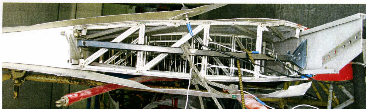
Fot.48 – Nasada lewego skrzydła (po demontażu).
