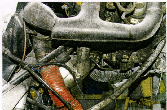
Fot.51 – Silnik po zdemontowaniu gaźnika - zbliżenie (prawa strona).
