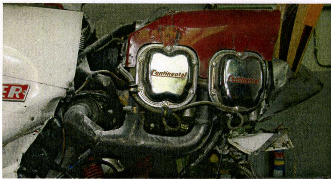
Fot.50 – Silnik po zdemontowaniu gaźnika (prawa strona).
