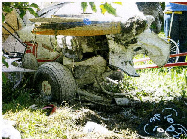
Fot.24 – Zniszczona przednia część samolotu.
