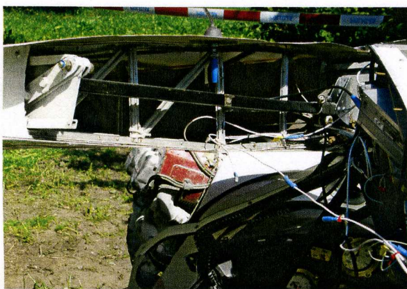
Fot.25 i 26 – Nasada lewego skrzydła po rozdzieleniu od kadłuba w wyniku wypadku.
