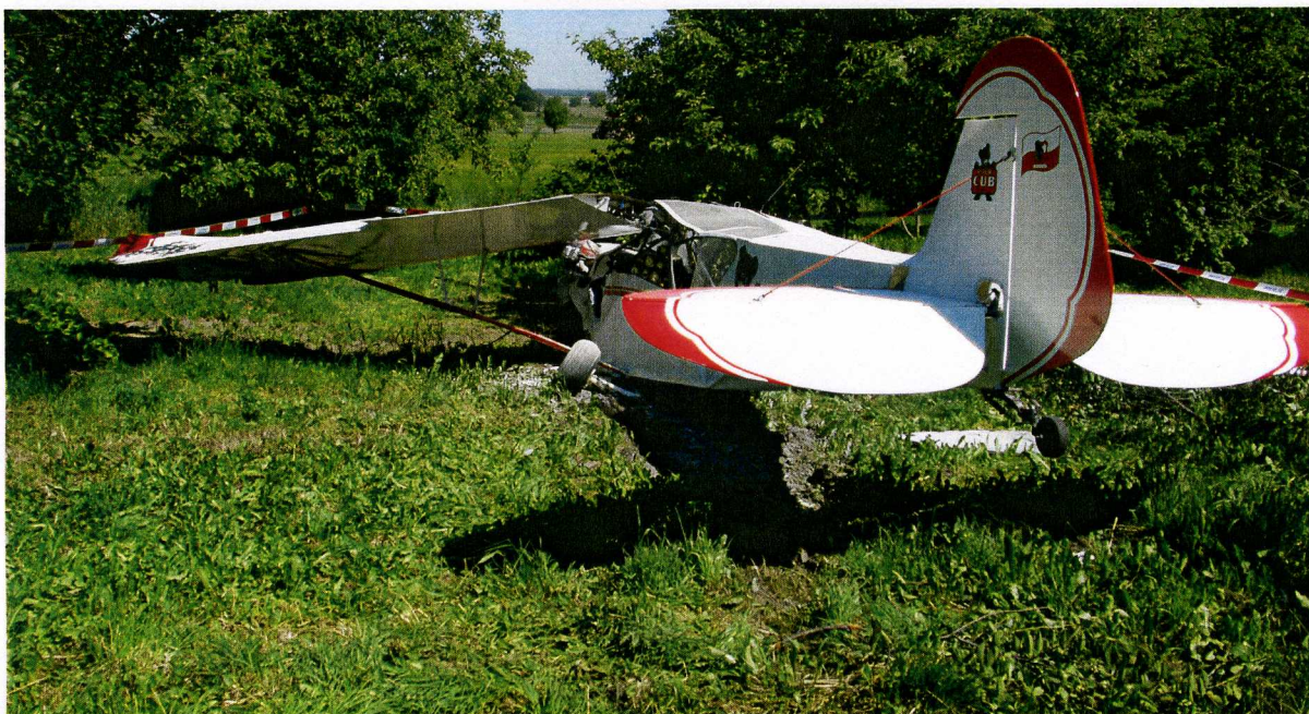
Fot.20 – Rozbity samolot w widoku od tyłu, widać ślad kadłuba na ziemi.
