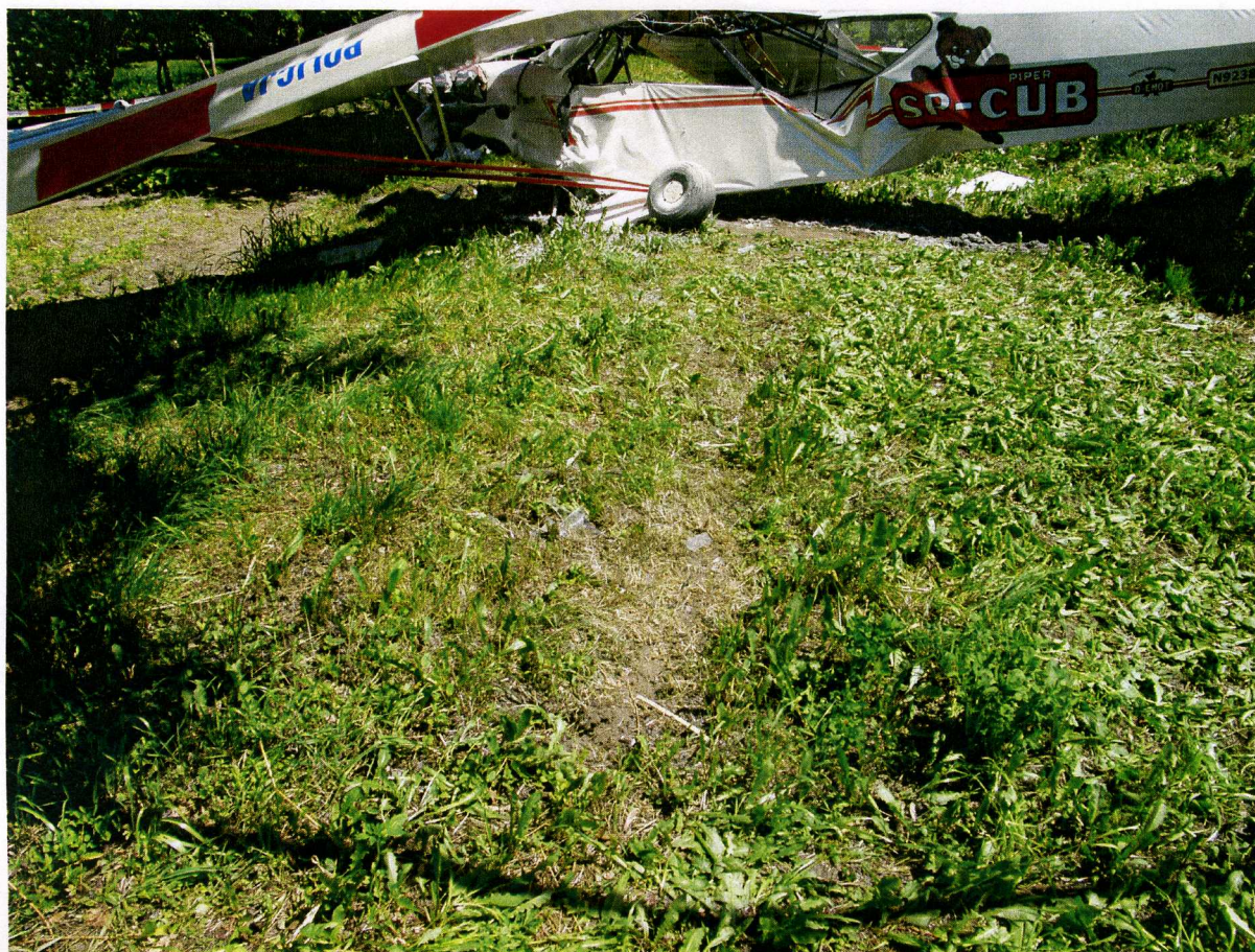
Fot.31 – Ślad końcówki lewego skrzydła na ziemi, widoczne odłamki oszklenia reflektora.
