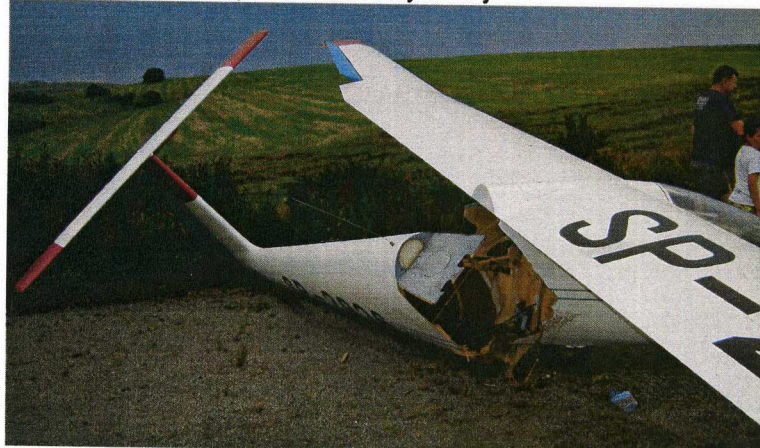
11 – Uszkodzony szybowiec z prawej strony.
