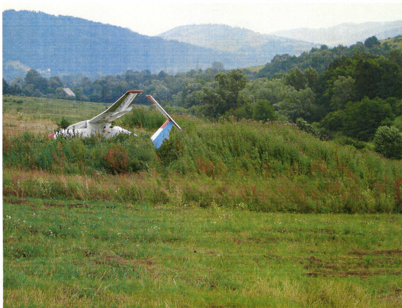
9 – Uszkodzony szybowiec po przekołowaniu przez uskok terenu i zatrzymaniu się na skraju parkingu.
