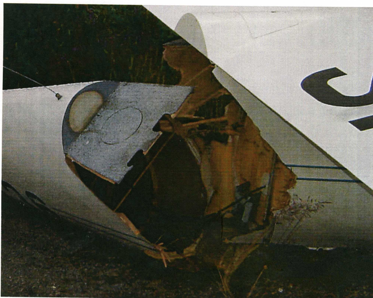
13 – Przełom kadłuba szybowca w zbliżeniu.
