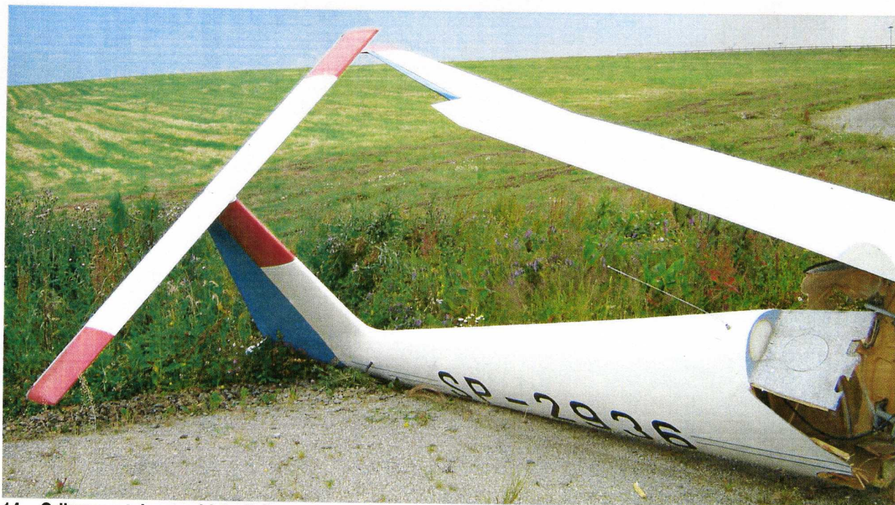
14 - Odłamana tylna część kadłuba z usterzeniem, widoczne lewe skrzydło.
