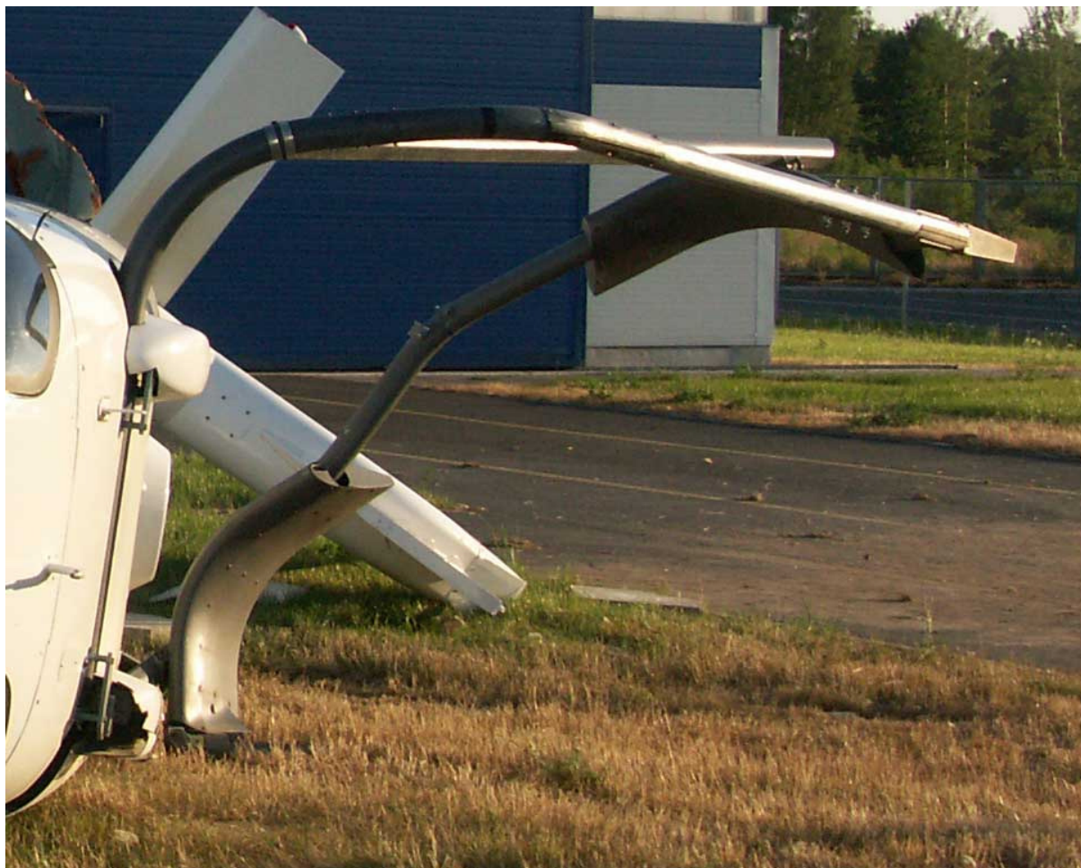
21 – Zniszczone podwozie śmigłowca, widok od przodu.
