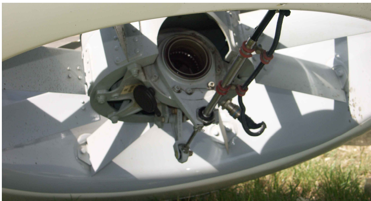
12 – Wirnik ogonowy i jego przekładnia kątowa w fenestronie – widać miejsce po wyrwanym wale napędowym i układ sterowania wirnikiem.
