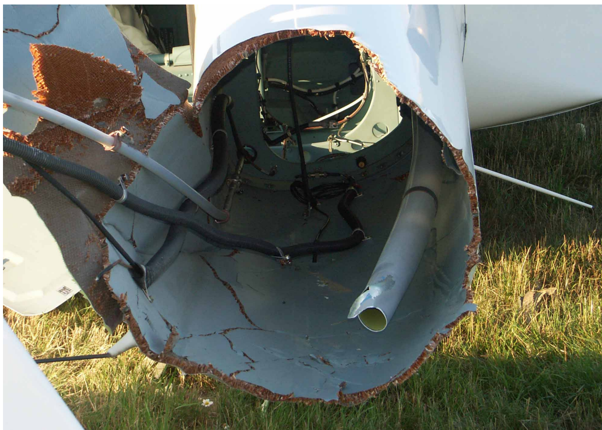
10 – Przełom belki ogonowej – widoczny ukreślony wał wirnika ogonowego, system sterowania i kable instalacji elektrycznej..
