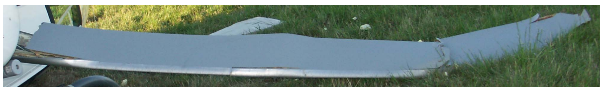
16 – Zniszczona łopata wirnika głównego.
