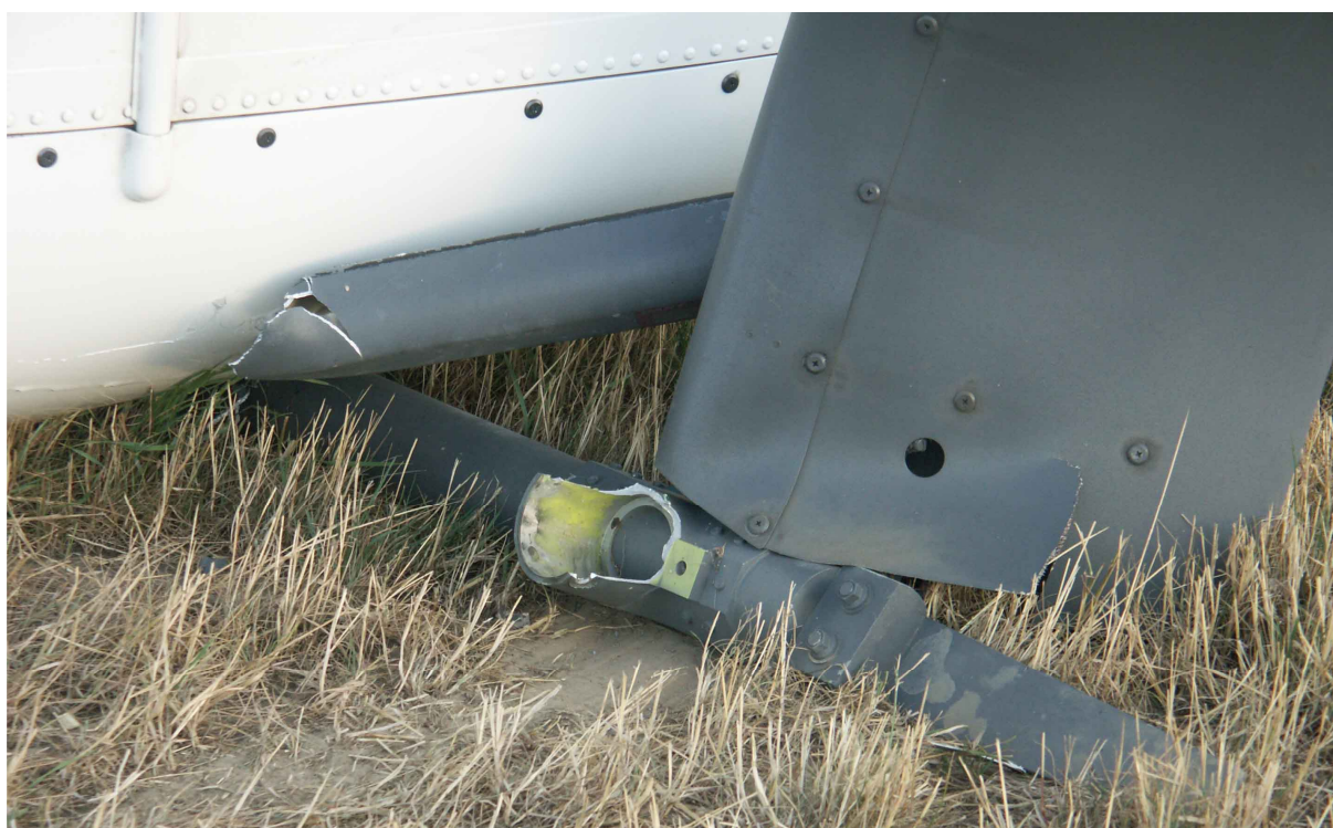
22 – Zbliżenie fragmentu zniszczonego podwozia.
