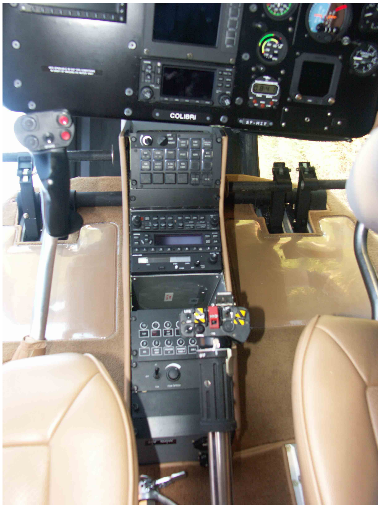
25 – Wnętrze kabiny, widok z góry na pulpit środkowy. Na pierwszym planie dźwignia skoku i mocy.
