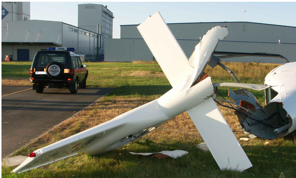
9 – Odłamane usterzenie śmigłowca z wirnikiem ogonowym i fenestronem.
