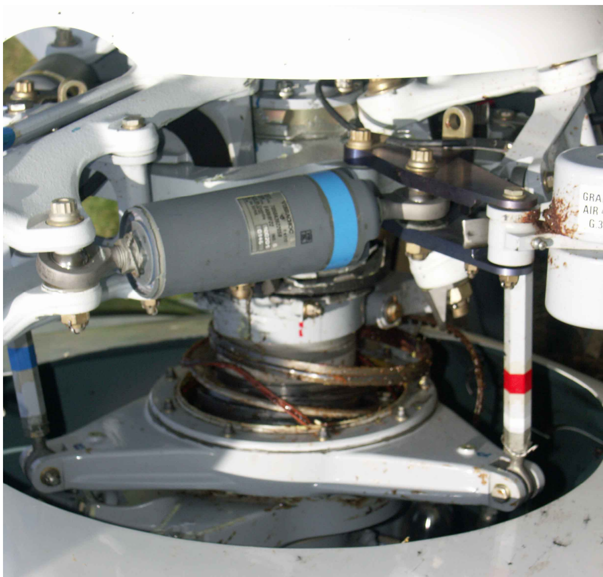
15 – Głowica wirnika głównego w zbliżeniu.
