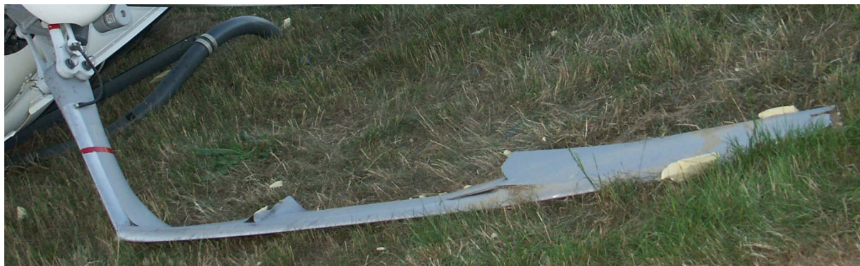
19 – Zniszczona łopata wirnika głównego.
