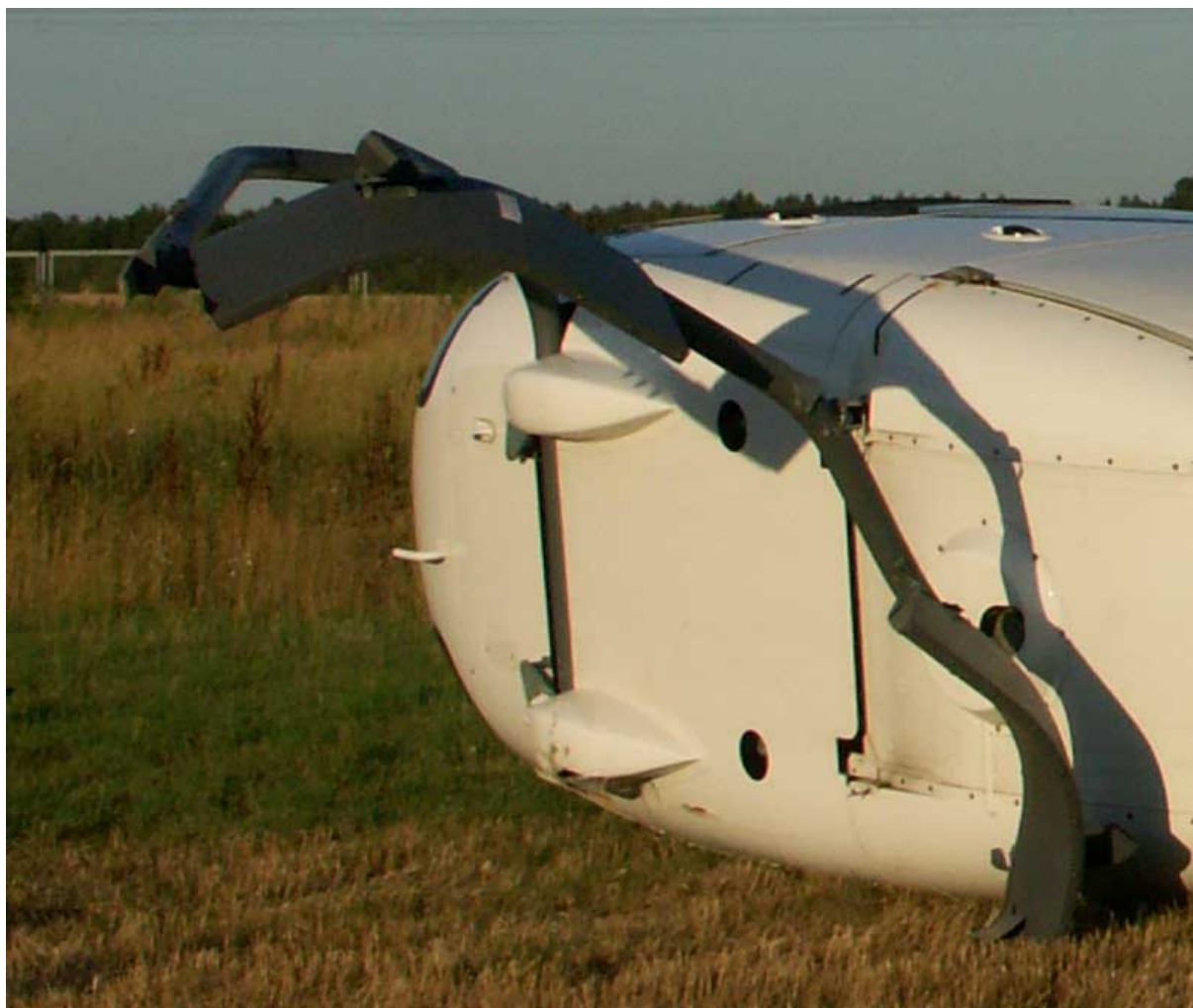
20 – Zniszczone podwozie śmigłowca, widok od tyłu.
