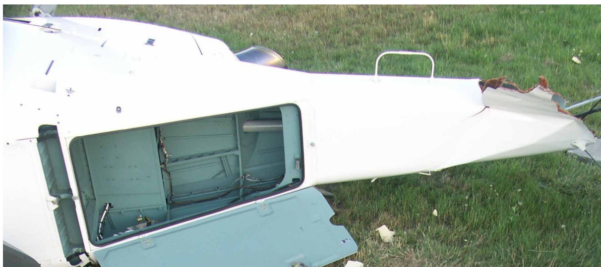
7 – Belka ogonowa i otwarty luk wziernika belki rozbitego śmigłowca.
