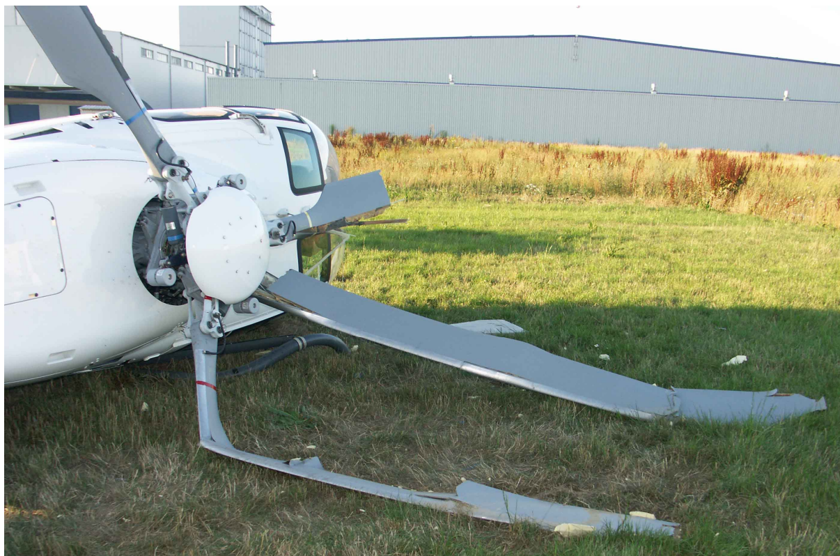
13 – Ogólny widok rozbitego śmigłowca od strony grzbietowej, widoczny zniszczony wirnik główny.
