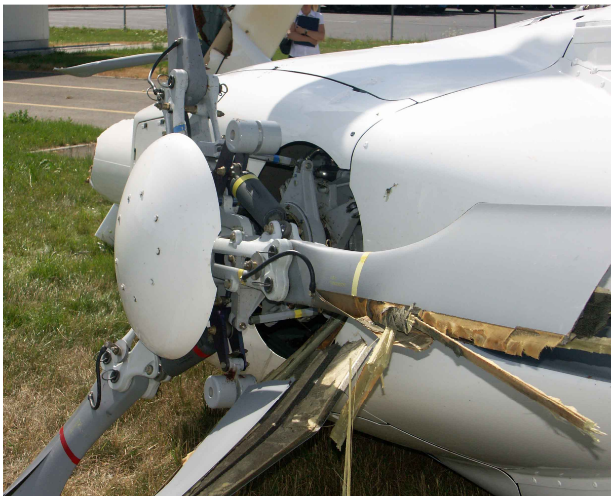
14 – Głowica wirnika głównego, widoczne zamocowania połamanych łopat.
