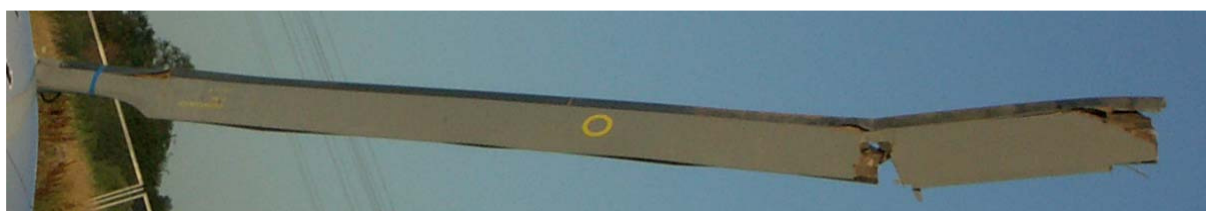
18 – Zniszczona łopata wirnika głównego.
