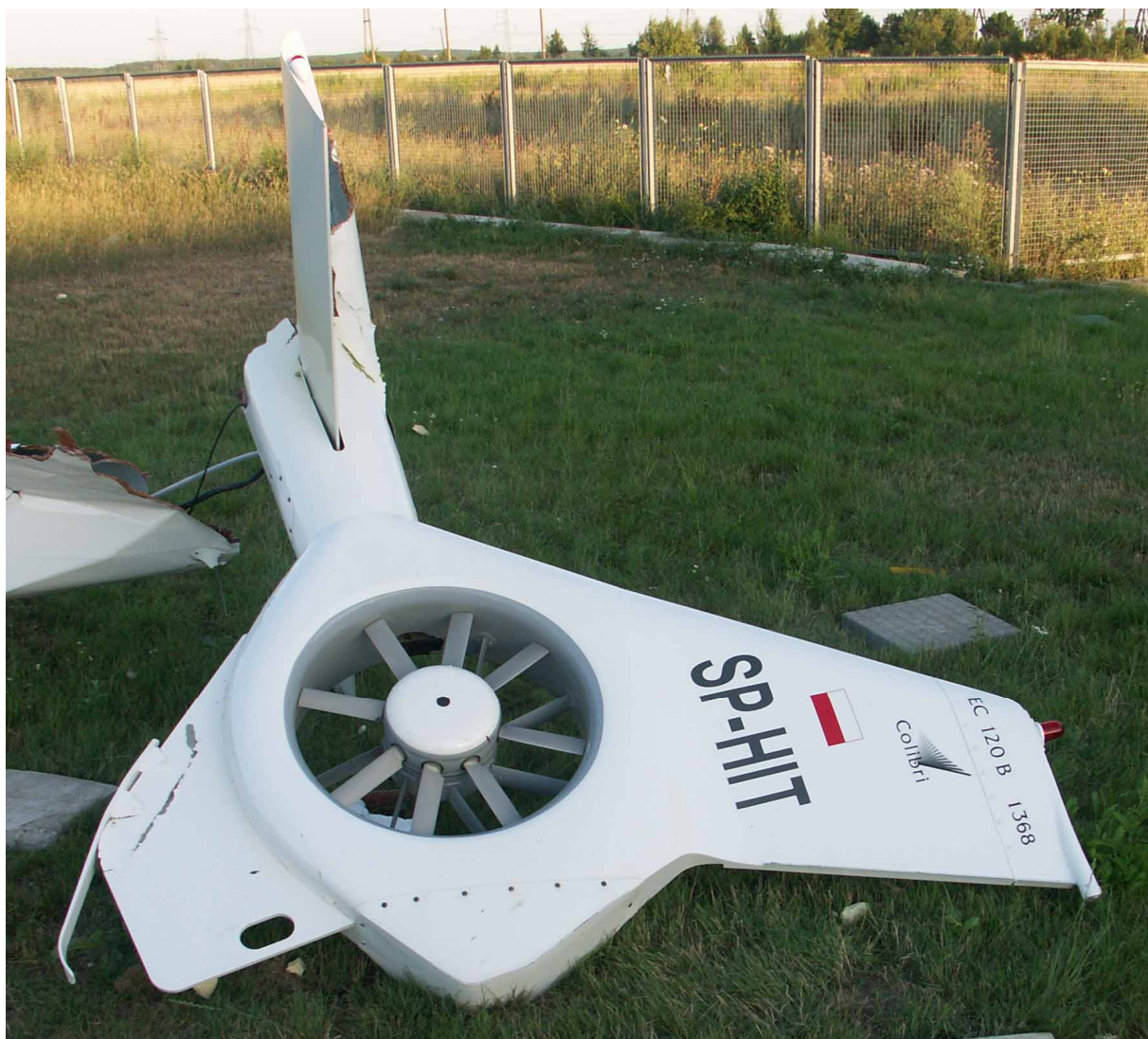
8 – Odłamane usterzenie śmigłowca z wirnikiem ogonowym i fenestronem.
