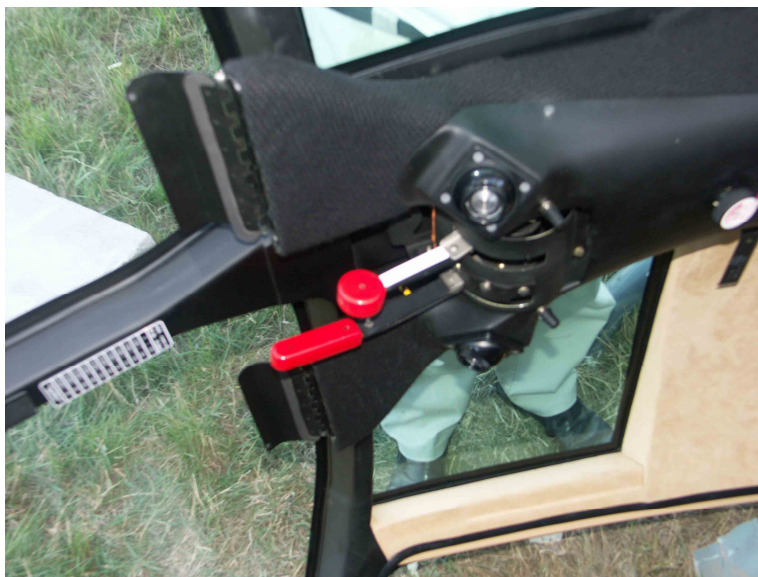
27 – Dźwignia hamulca wirnika (dłuższa) i zaworu odcinającego paliwo (krótsza).
