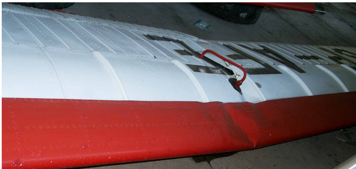
8 – Uszkodzenia pokrycia górnego i slotu.
