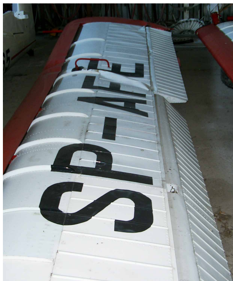
6 i 7 – Uszkodzone skrzydło od strony nasady (po lewej) i od strony końcówki (po prawej).
