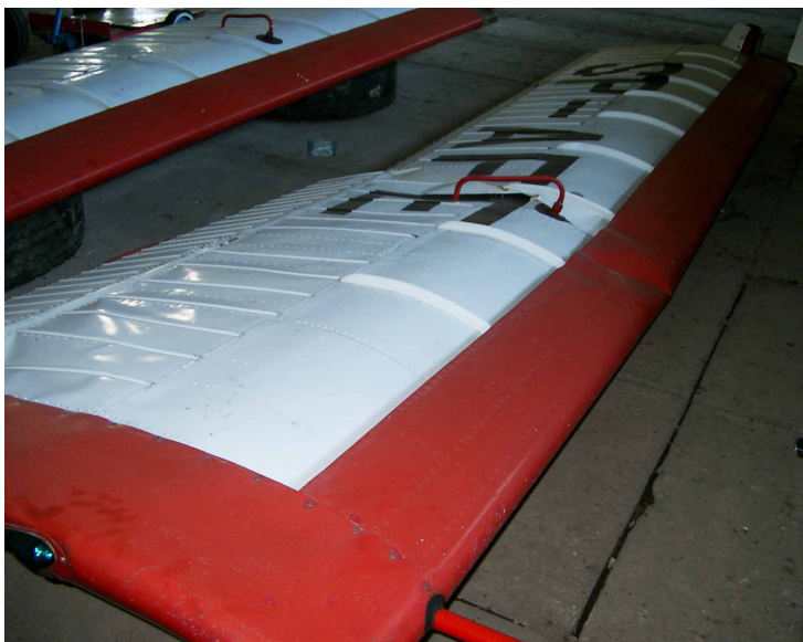
6 i 7 – Uszkodzone skrzydło od strony nasady (po lewej) i od strony końcówki (po prawej).
