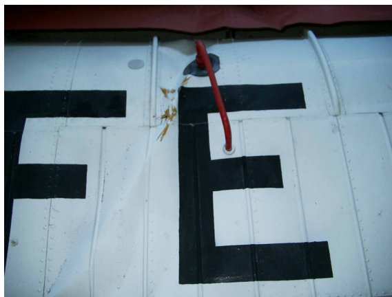
9 i 10 – Uszkodzenia pokrycia górnego i slotu - zbliżenia.
