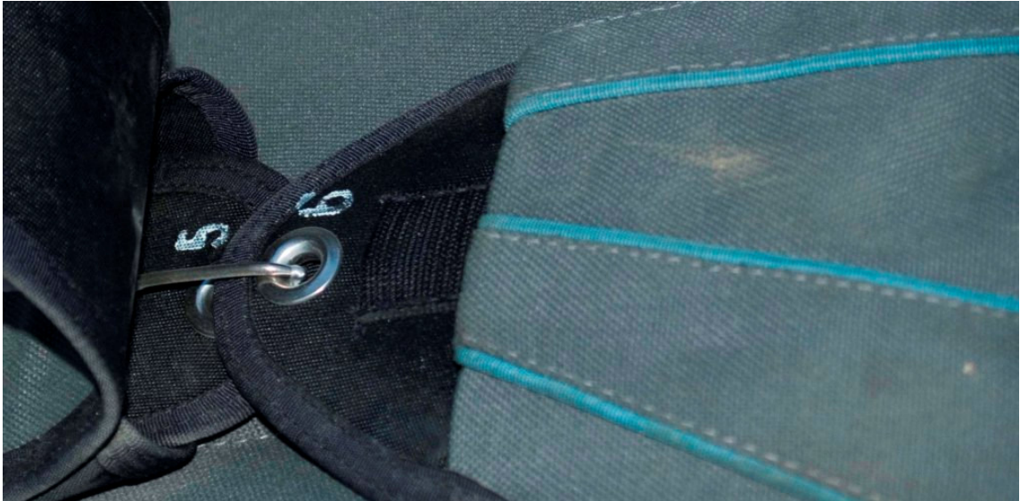
Położenie zawlecзки uchwytu czaszy zapasowej, wysuniętej i zgiętej w wyniku zderzenia z ziemią
