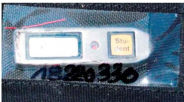
Widok panelu sterowania – brak wskazań na wyświetlaczu ciekłokrystalicznym wskazuje, że automat jest wyłączony.
