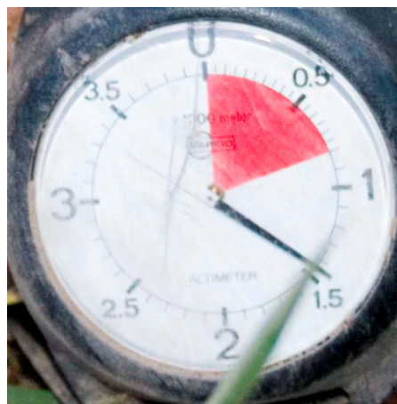
Widok uszkodzonego wysokościomierza analogowego
