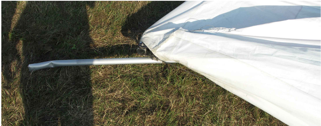
13 – Zniszczony węzeł przedni, widoczny kół złamany przy węźle.
