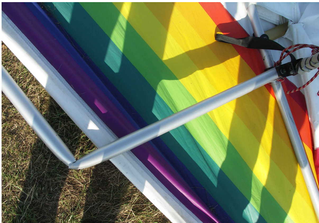
7 – Dźwigar, złamany po lewej stronie.
