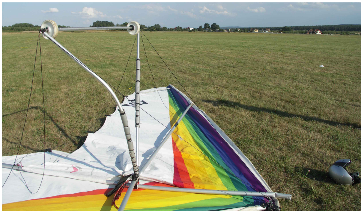
5 – Zbliżenie, widoczne główne węzły struktury lotni.
