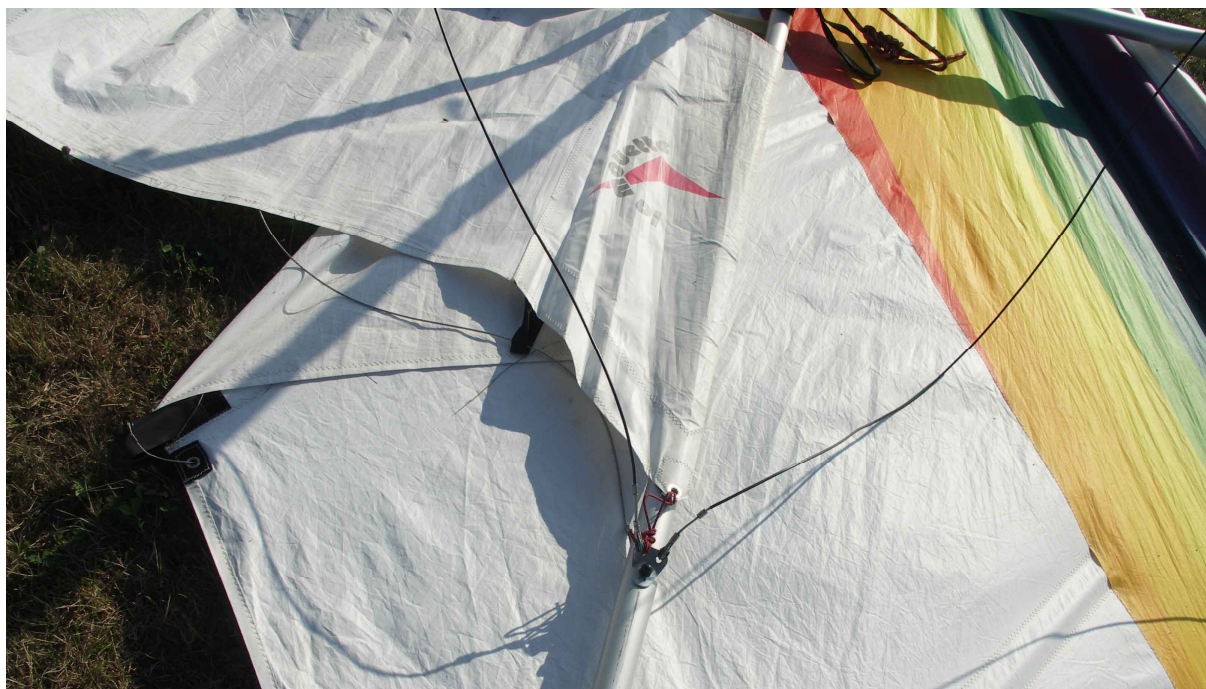
9 – Tkanina pokrycia lotni – widoczna tylna część kila.
