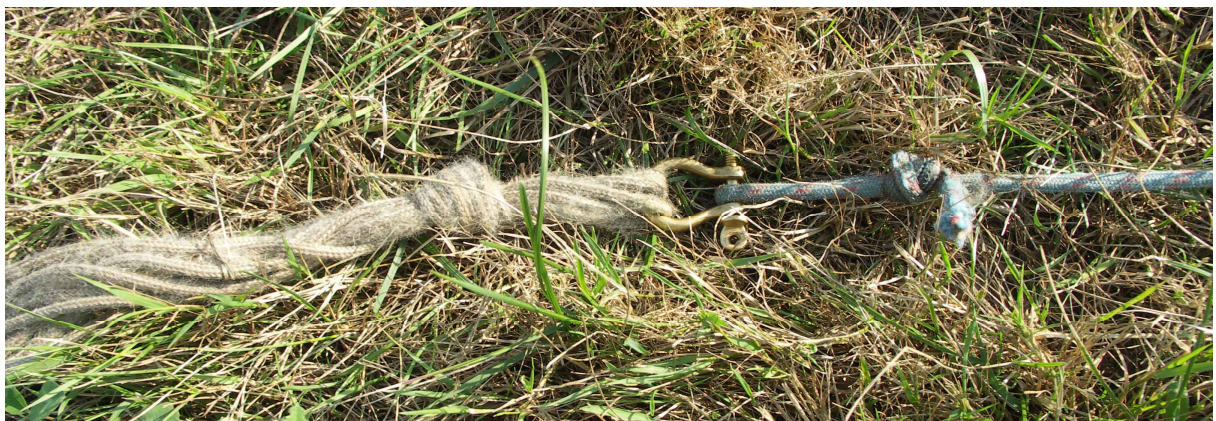
15 – Szekla na połączeniu spadochronika wyciągarki do linki tekstylnej.
