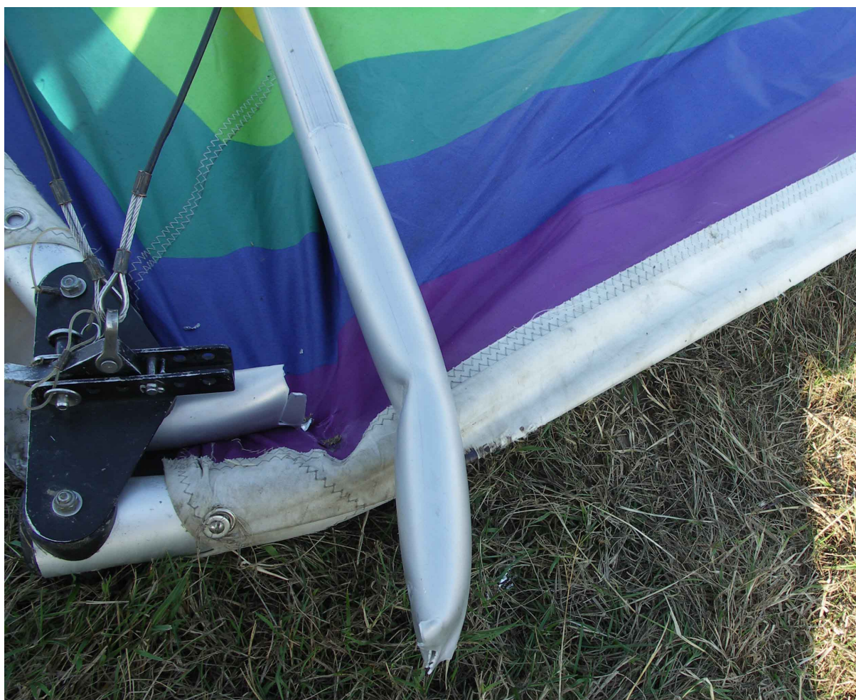
6 – Zniszczony węzeł przedni – widać złamany kil i skrzywioną przy węźle rurę prawej krawędzi natarcia.
