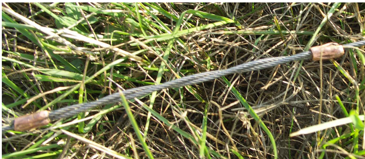
18 – Połączenie dwóch odcinków linki stalowej (holowniczej).
