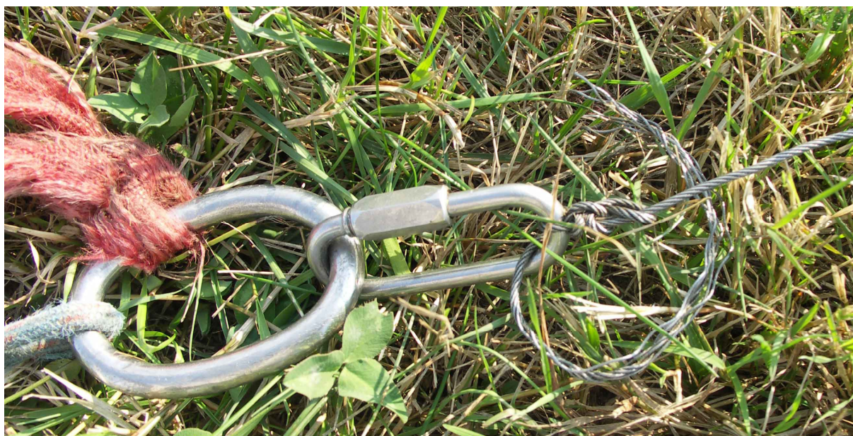
17 – Ognia łączące linkę tekstylną z linką stalową (holowniczą) i węzeł na lince stalowej.
