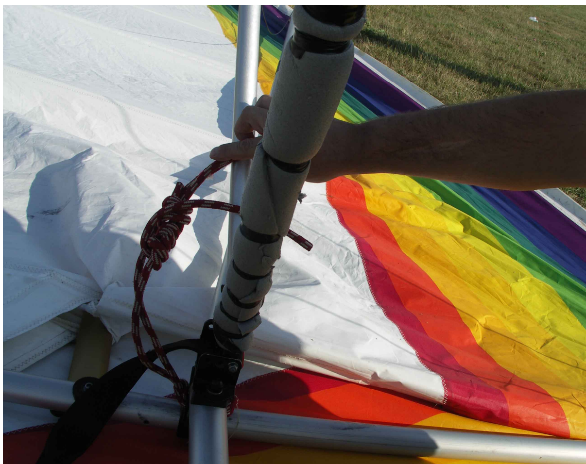
8 – Linka zabezpieczająca w głównym węźle mocowania sterownicy do dźwigara i kila.
