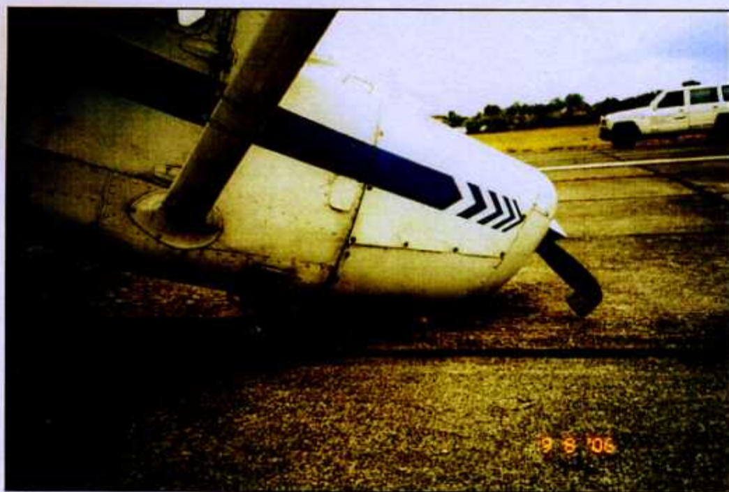
Fot. 11. Stan goleni przedniej i śmigła po wypadku
