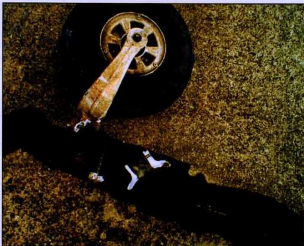
Rozerwane gniazdo widelca przedniego koła
