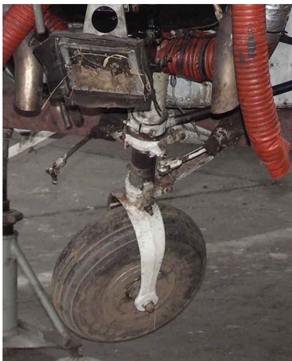
16, 17, 18 i 19 – Wyrwane z zamocowań podwozie przednie, pokazane z różnych stron.
