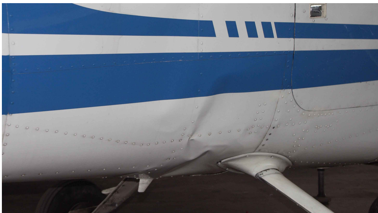
5 – uszkodzenia struktury i zniekształcenia pokrycia z prawej strony kadłuba w okolicy zamocowania podwozia głównego.
