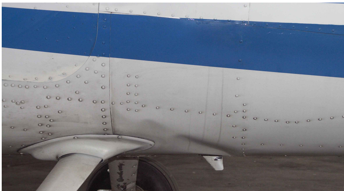
6 – Uszkodzenia struktury i zniekształcenia pokrycia z lewej strony kadłuba w okolicy zamocowania podwozia głównego.
