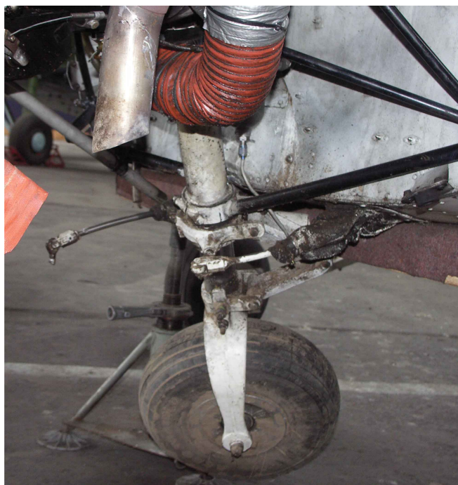
16, 17, 18 i 19 – Wyrwane z zamocowań podwozie przednie, pokazane z różnych stron.
