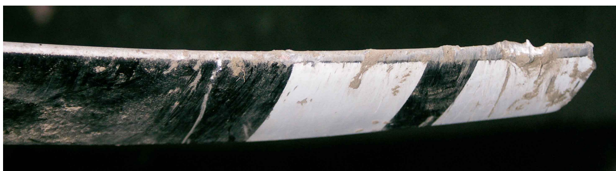
14 i 15 – Uszkodzone końcówki łopat śmigła.
