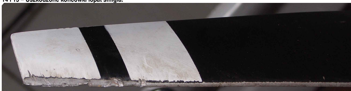
14 i 15 – Uszkodzone końcówki łopat śmigła.
