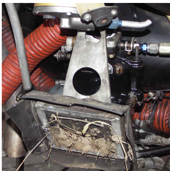
12 i 13 – Oderwany od korpusu silnika gaźnik z filtrem powietrza.
