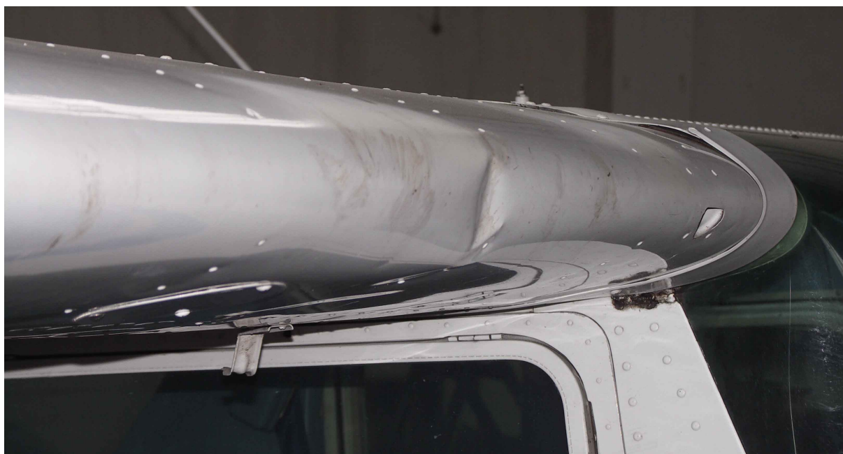
7 – Uszkodzenie noska prawego skrzydła przy nasadzie.
