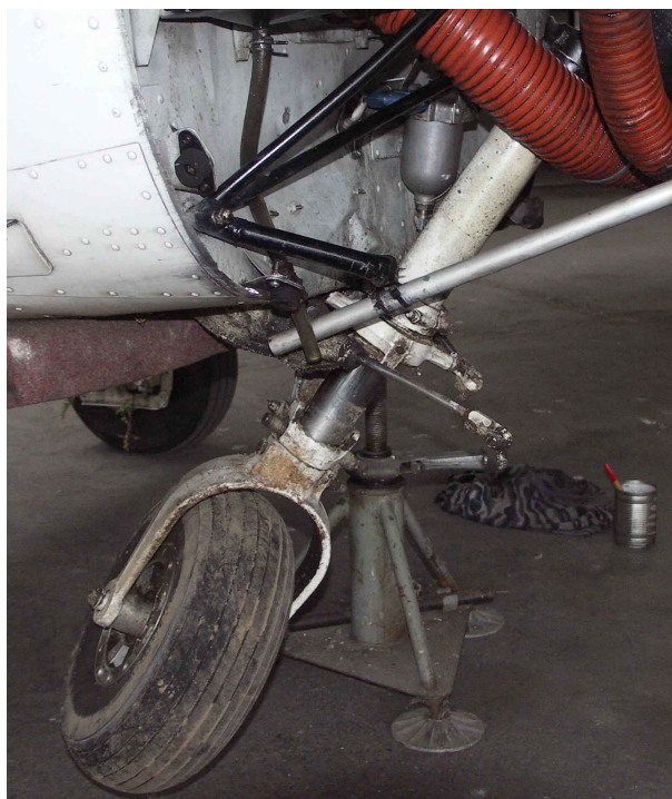
16, 17, 18 i 19 – Wyrwane z zamocowań podwozie przednie, pokazane z różnych stron.
