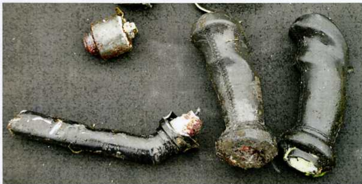
35 – Odłamany fragment prawego drążka i rękojeści obu drążków.
