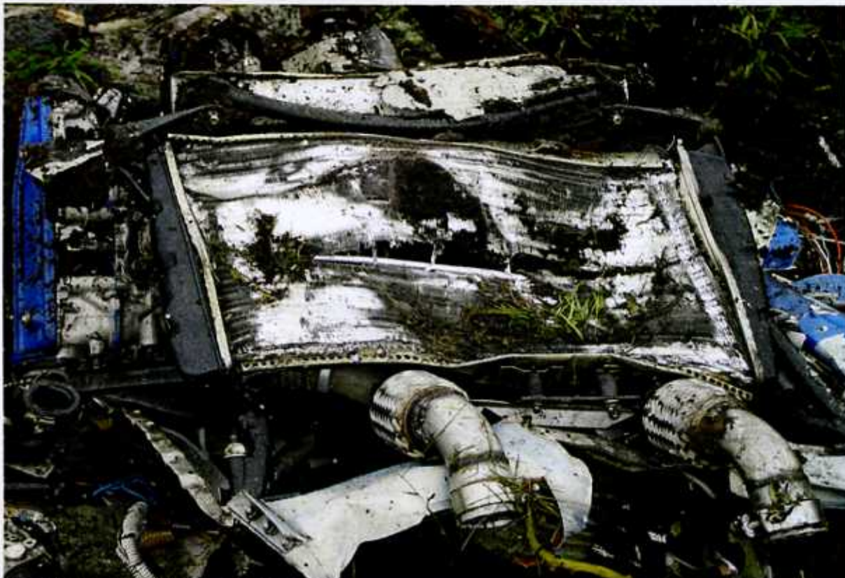
61 – Silnik od dołu – widoczna chłodnica płynu.
