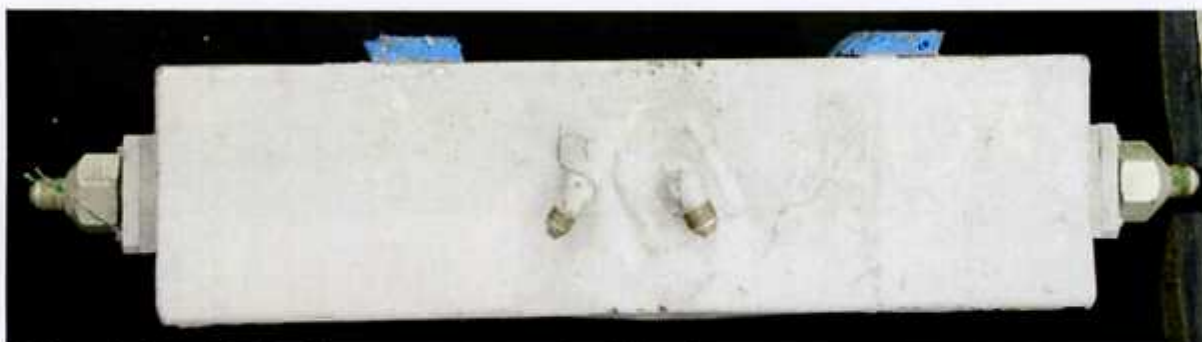
57 – Rozchodowy zbiornik paliwowy po wymontowaniu, widok z góry.
