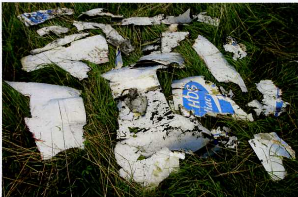
67 – Szczałki zniszczonych osłon silnika.
