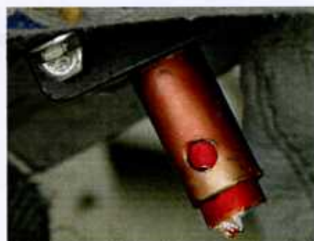
54 – Końcówka cięgna uruchamiania spadochronowego systemu ratunkowego; brak odłamanego uchwytu.
