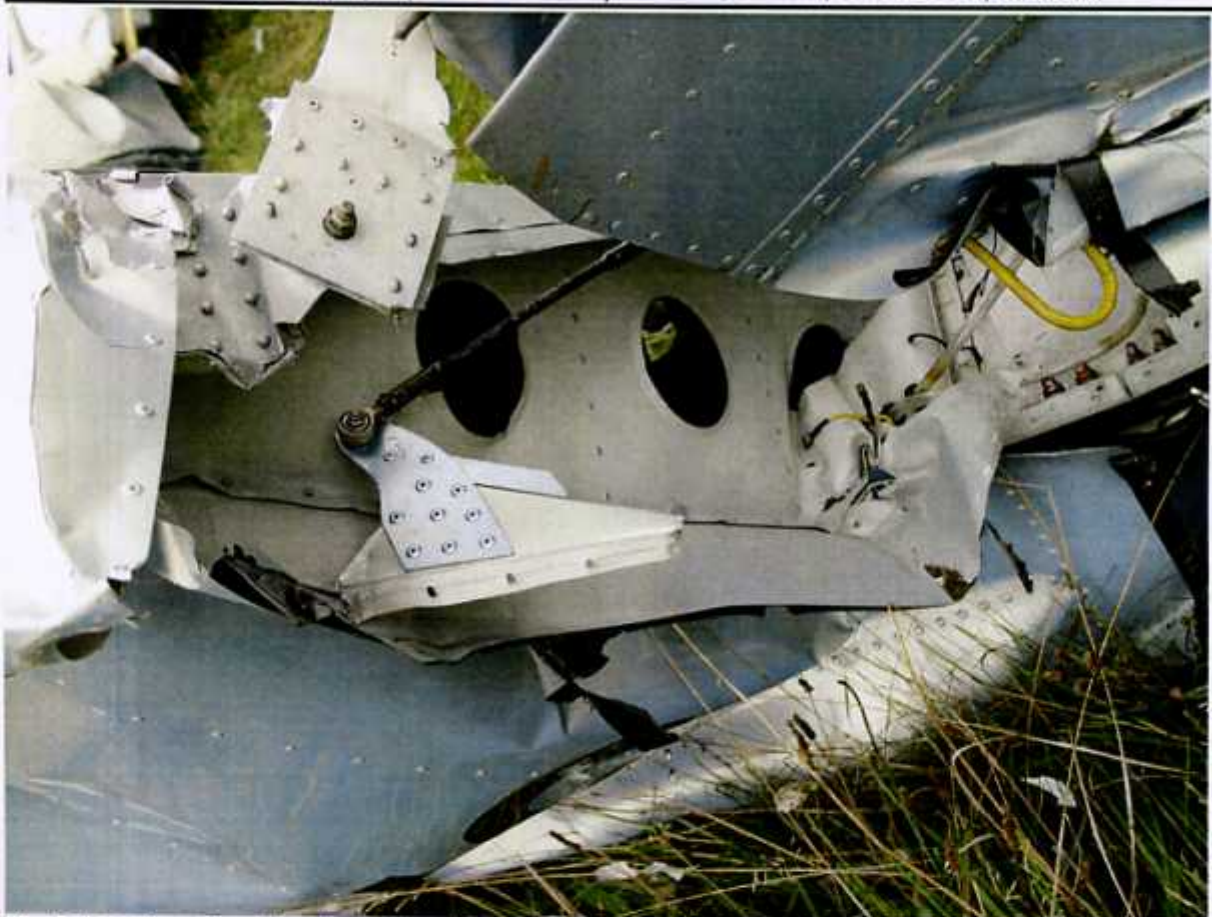
18 – Połączenie centroplata z lewym skrzydłem, widok od dołu. Widoczne oderwane żeberko kłapy z popychaczem napędu i przewód instalacji paliwowej.
