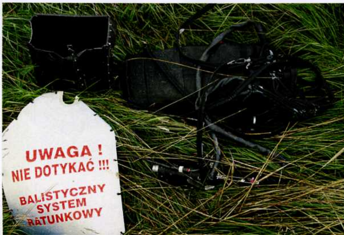
52 – Elementy spadochronowego systemu ratunkowego po wymontowaniu z kadłuba
