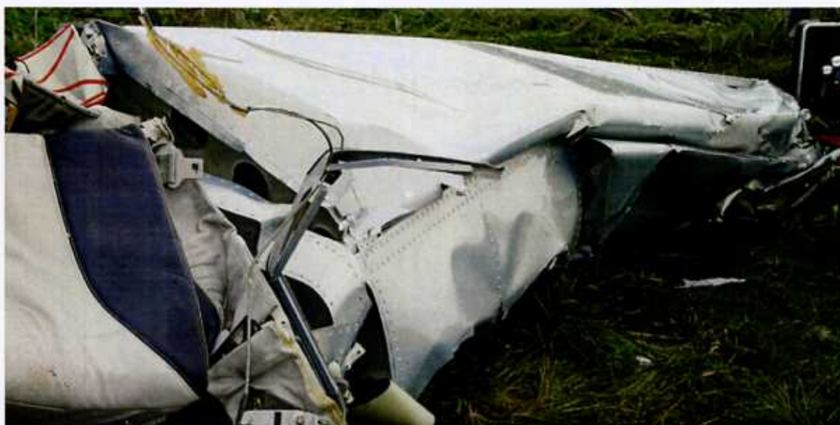
25 – Zniszczone pokrycia noska lewego skrzydła i integralnego zbiornika paliwowego.
