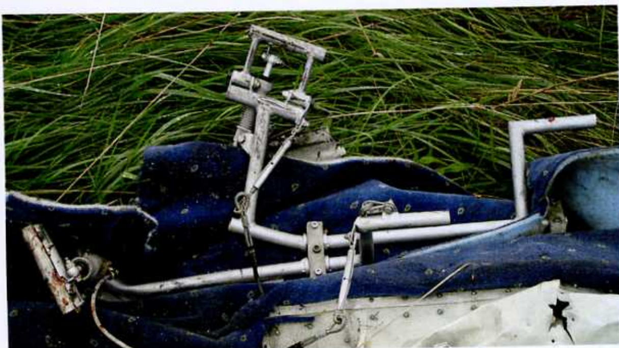
37 - Sterownice nożne po usunięciu ze szczątków kabiny.
