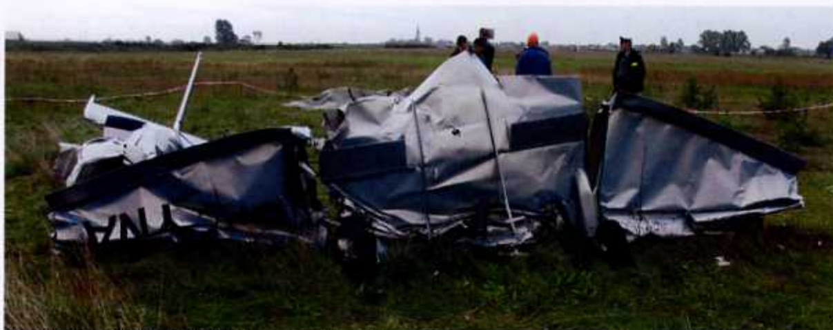
12 – Skrzydła, widok od dołu. Widoczne wychylone klapy.
