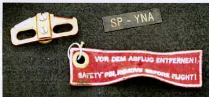
53 – Odłamaný uchwyt uruchamiania spadochronowego systemu ratunkowego, zawleczka z chorągiewką zabezpieczającą uchwyt i tabliczka ze znakami rozpoznawczymi samolotu.
