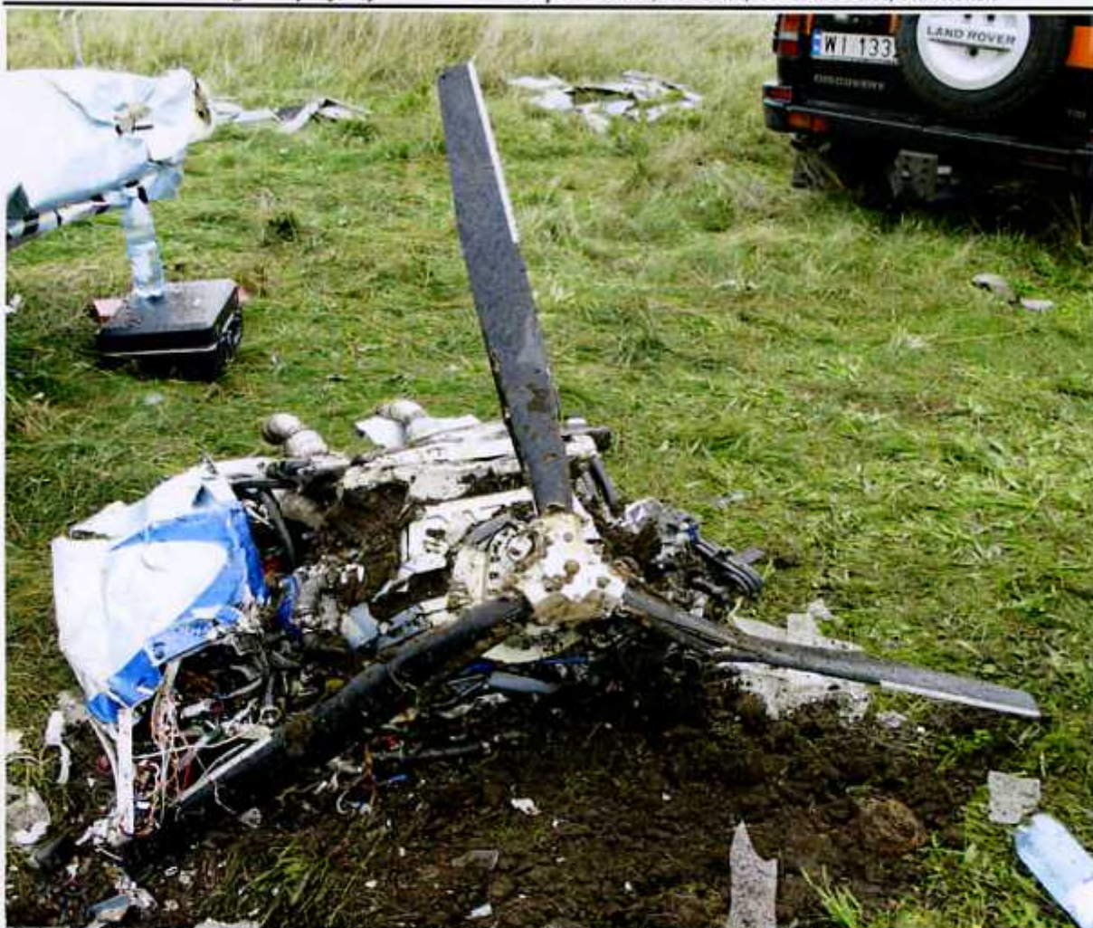
60 – Zespół napędowy po wyciągnięciu z ziemi, dobrze widoczne połamane łopaty śmigła.
