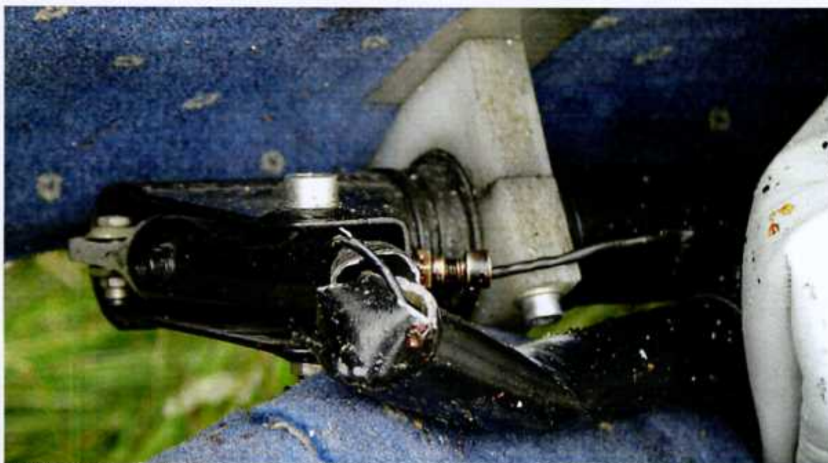
33 – Obsada prawego drążka sterowego, drążek połamany.
