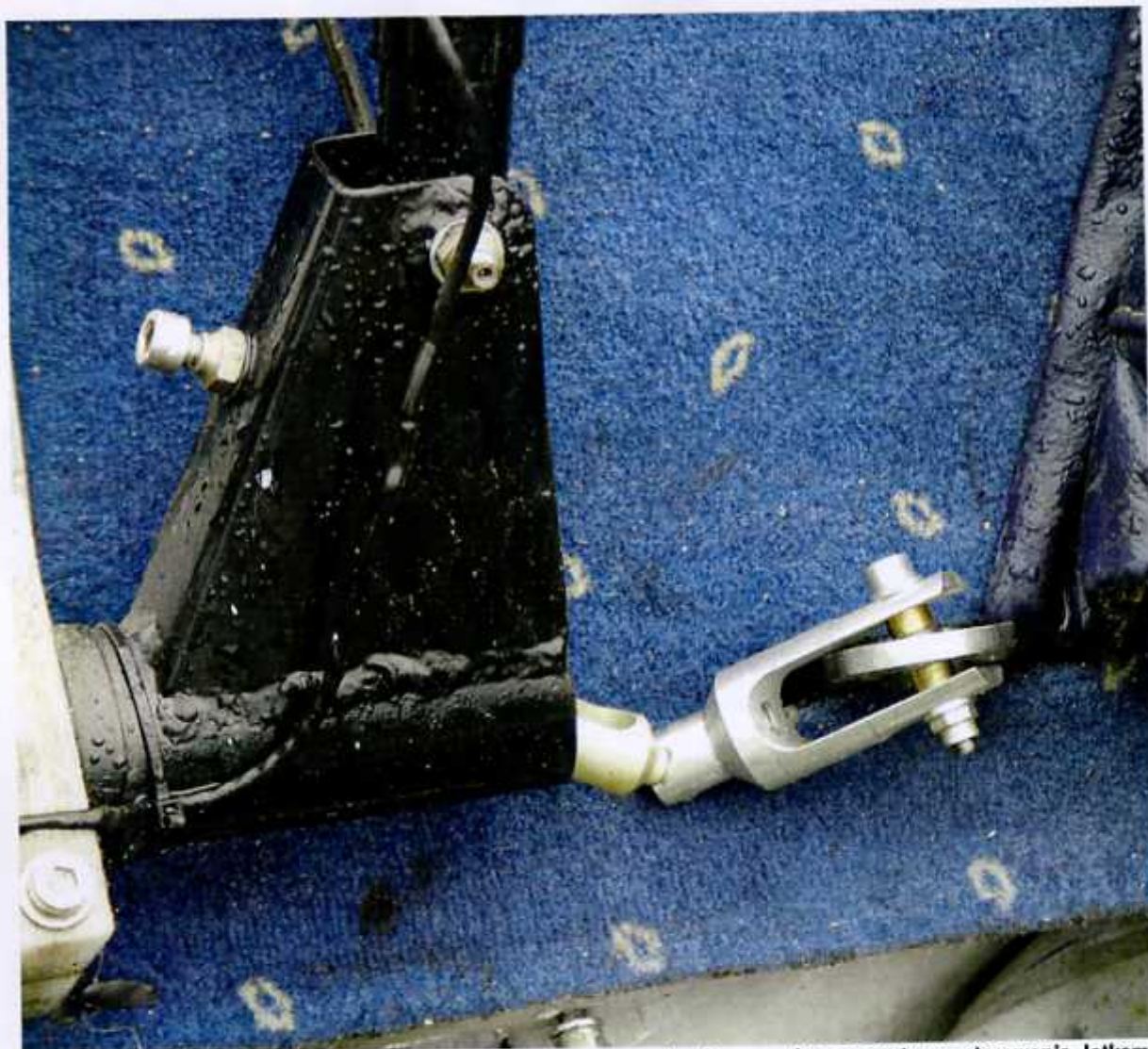
36 - Obsada prawego drążka sterowego, widoczne wyprowadzenie popychacza systemu sterowania lotkami, końcówka popychacza odłamana.
