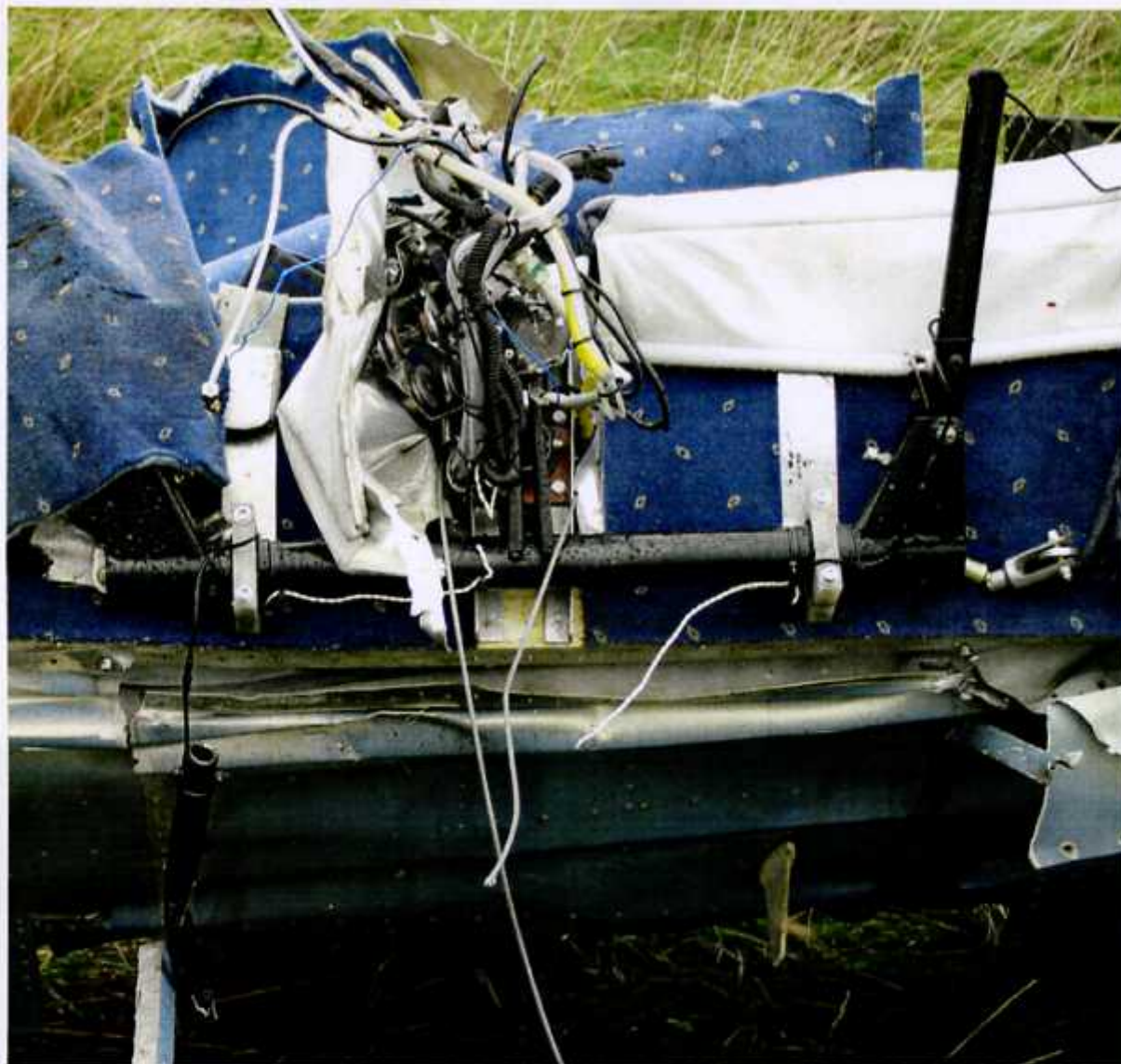
34 – Zespół sterownic ręcznych. Odłamany prawy drążek zwisa na przewodzie. Rękojeści obu drążków odłamane.
