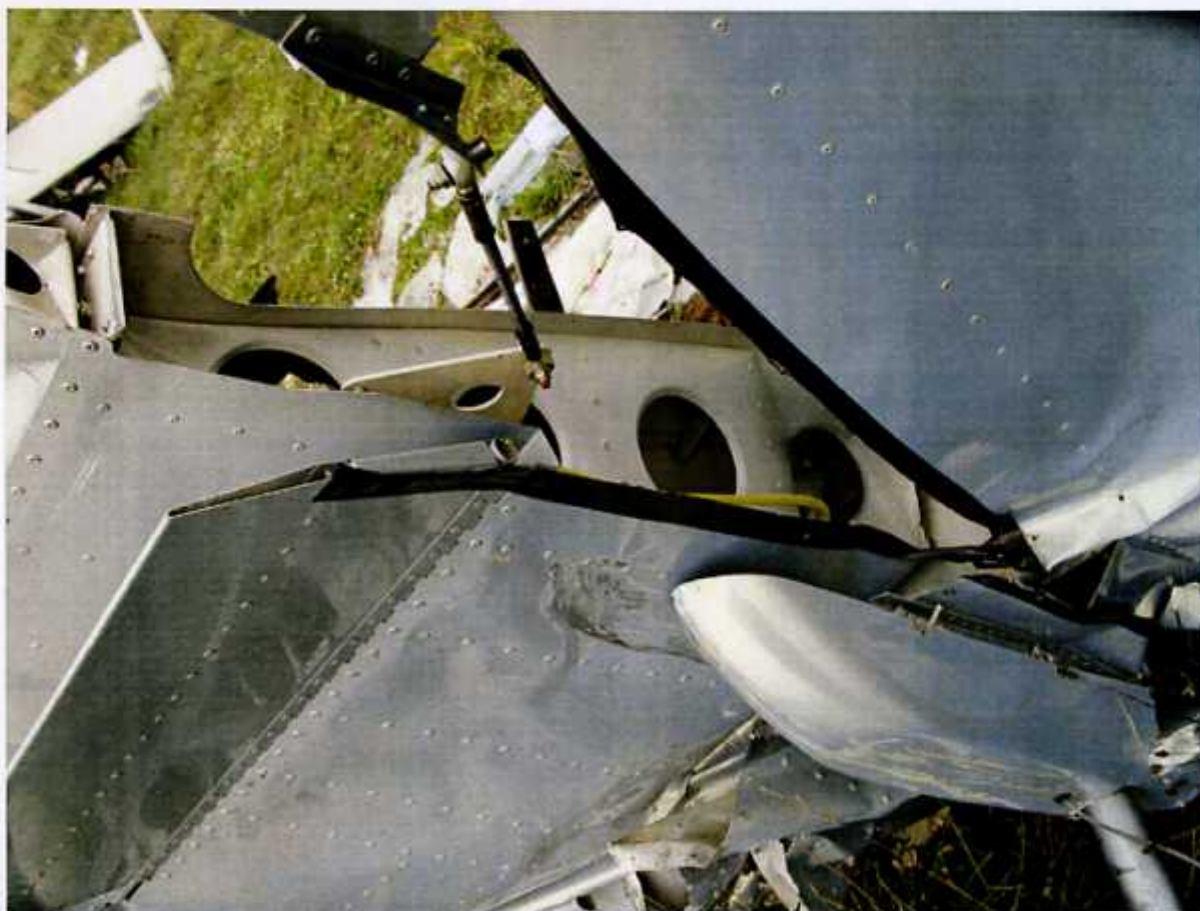
28 – Zniszczone połączenie centroplata z prawym skrzydłem. Widoczna trójkątna dźwignia systemu sterowania lotkami, oderwane żeberko kłapy z popychaczem napędu i przewód instalacji paliwowej.
