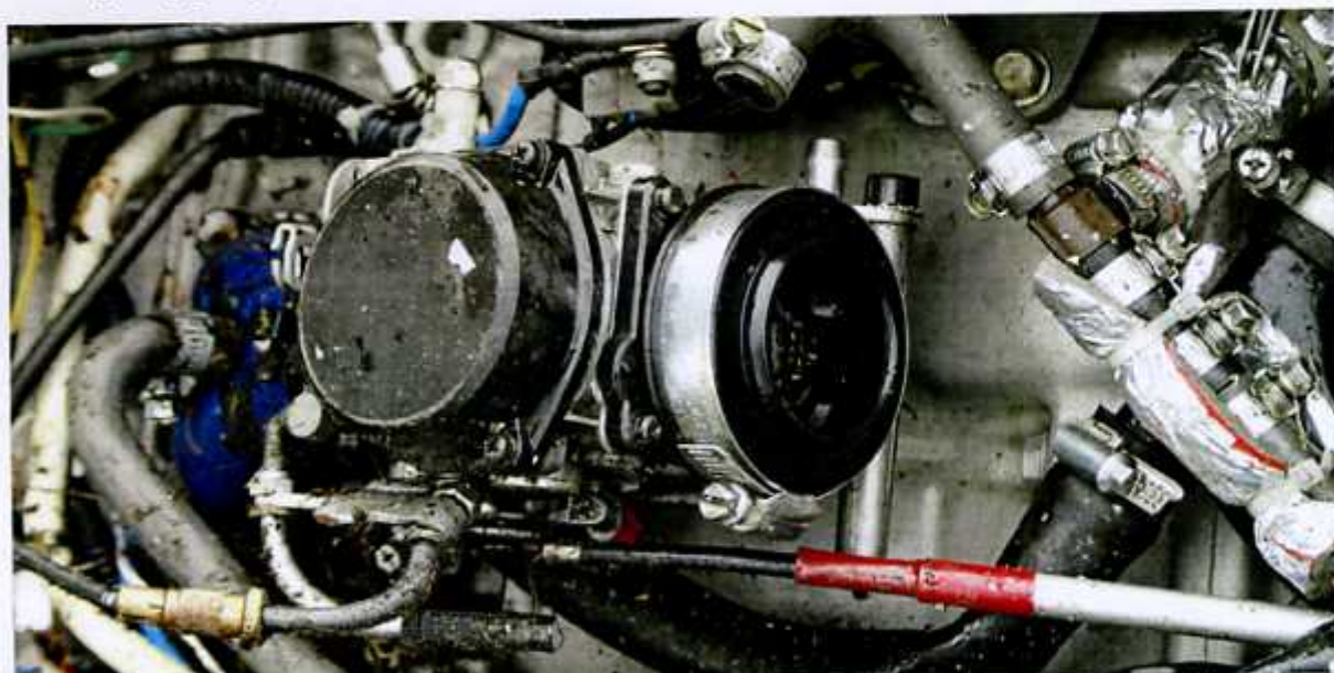
63 i 64 – Jeden z gaźników na silniku (u góry) i po zdemontowaniu (u dołu), obok filtry powietrza gaźników.
