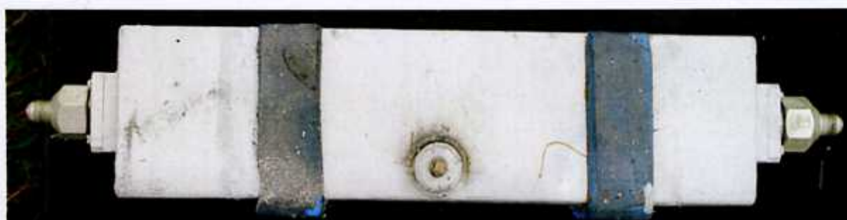
59 – Rozchodowy zbiornik paliwowy po wymontowaniu, widok z dołu.
