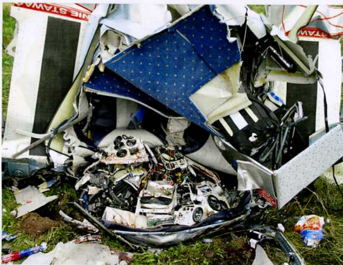
16 – kabinowa część kadłuba i wbity w ziemię silnik.
