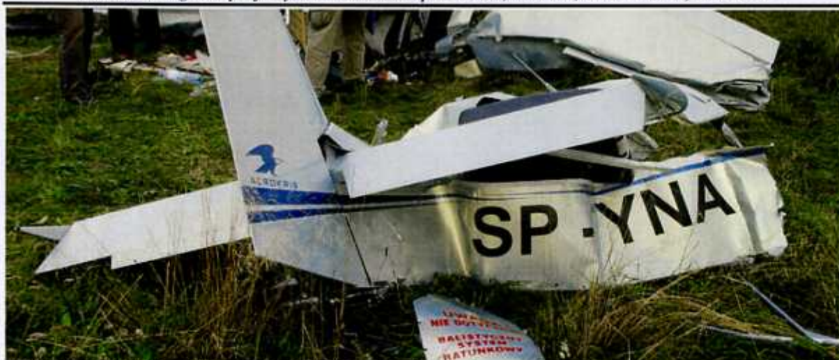
7 – Tylna część kadłuba, odcięta podczas próby ratowania załogi.
