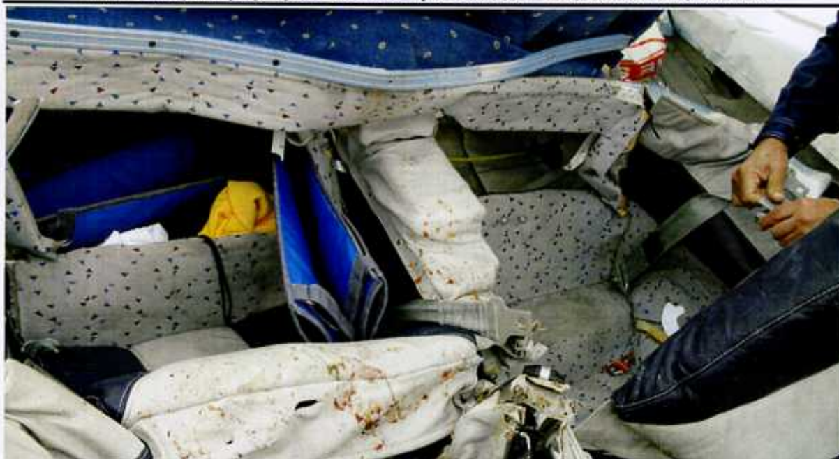
31 – Fotele i biodrowe pasy bezpieczeństwa. Pasy przecięte, zamki pasów rozpięte. Pasów barkowych brak.
