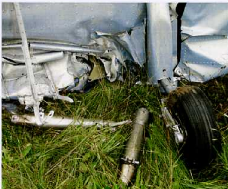
27 – Prawe podwozie główne, obok oderwane kolektory spalin.
