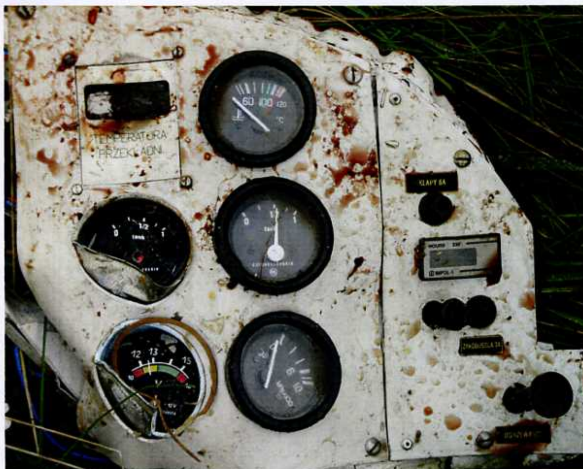
39 – Tablica przyrządów kontroli zespołu napędowego, instalacji paliwowej i instalacji elektrycznej.
