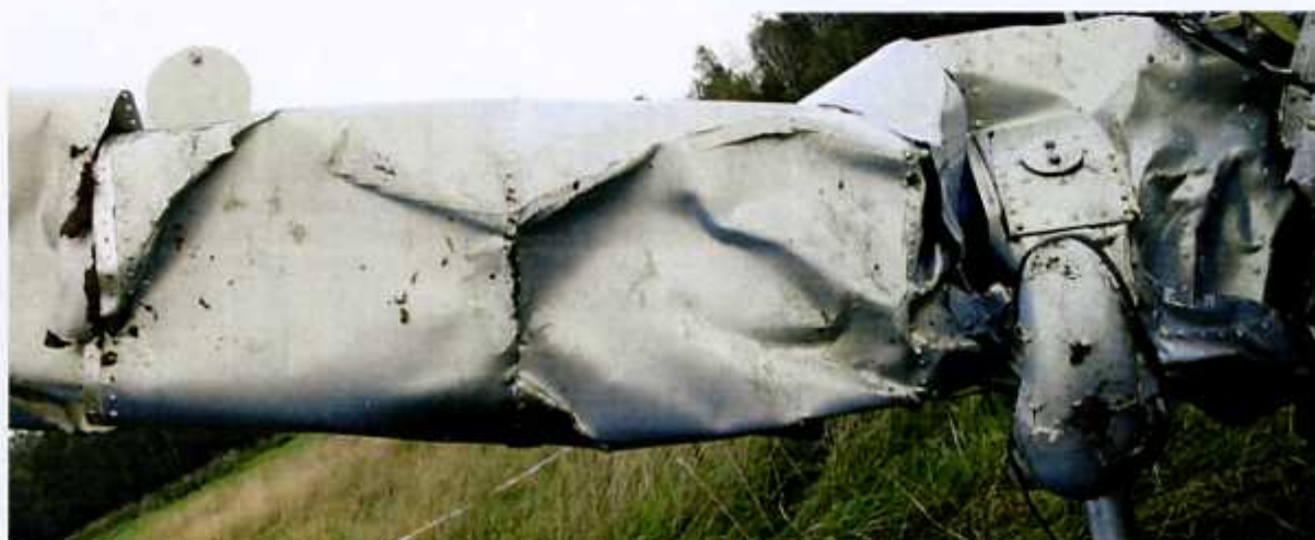
22 – Połączenie prawego skrzydła z centroplatem w widoku od przodu. Widoczne nitowanie wzmocnienia żebra siłowego mocowania goleni podwozia oraz wyprowadzenie goleni, osłonięte okrągłą pokrywką, zniszczony integralny zbiornik paliwowy oraz fragment goleni podwozia.
