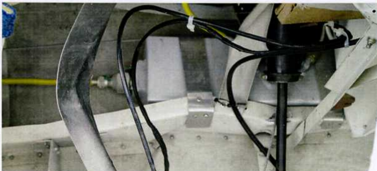
56 – Rozchodowy zbiornik paliwowy w centroplacie, widoczne przewody paliwowe (żółte).
