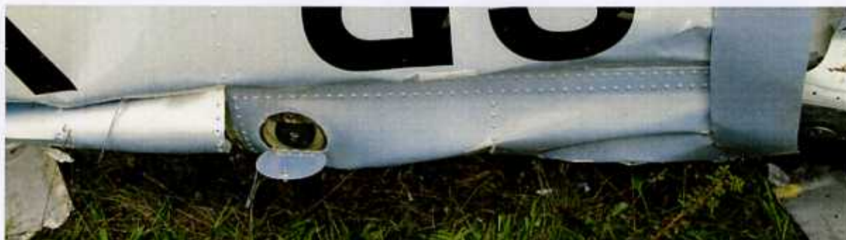
20 – Noskowa część prawego skrzydła ze zniszczonym integralnym zbiornikiem paliwowym, wieczko wlewu otwarte.
