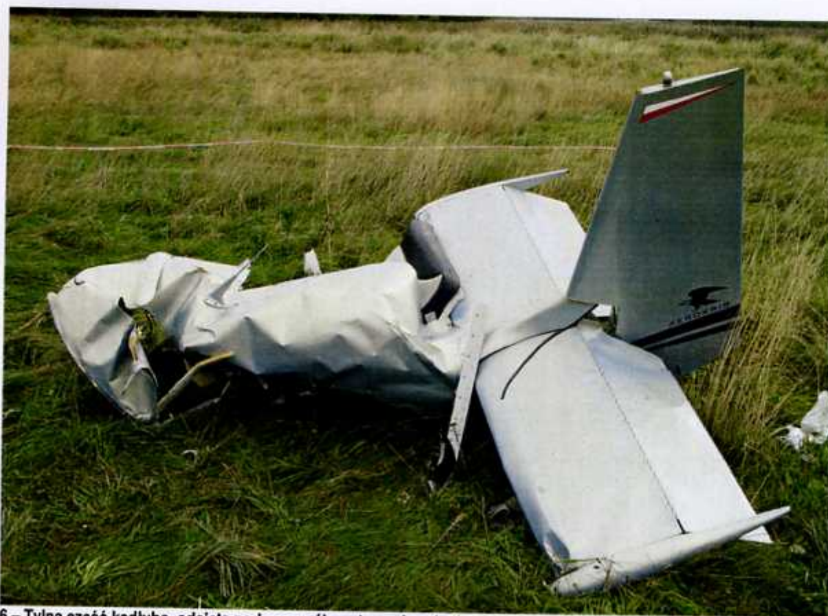
6 – Tylna część kadłuba, odcięta podczas próby ratowania załogi.
