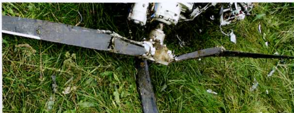
68 – Zniszczone śmigło, widoczny zgięty wał śmigła.
