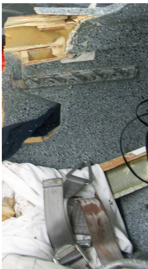
10 – Prawa burta kabiny z listwą blokowania oparcia, widoczne pasy bezpieczeństwa
