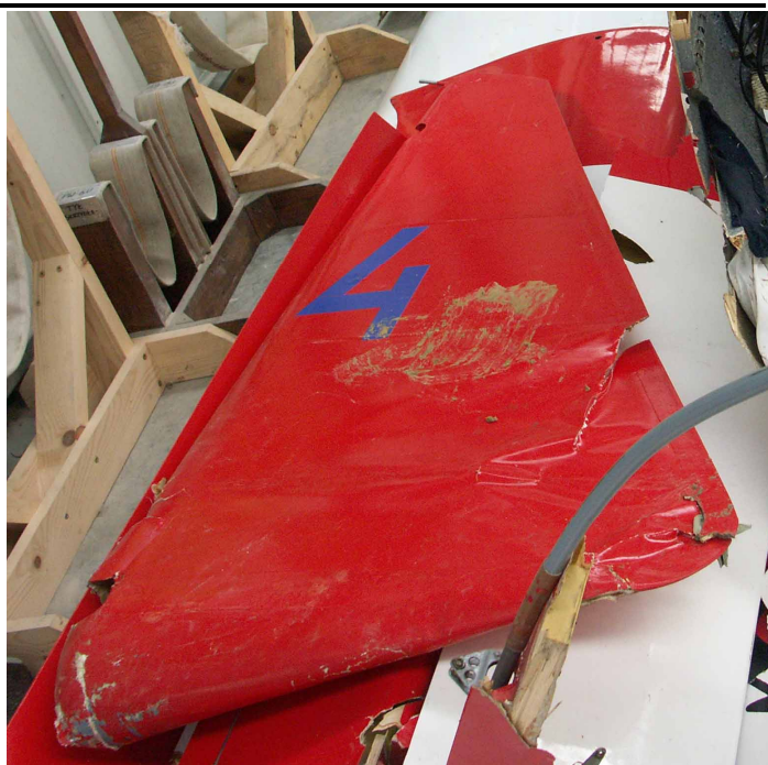
15 -Uszkodzony ster kierunku w szczątkach szybowca.
