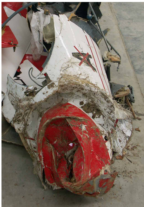
8 – Zniszczony uderzeniem przód kadłuba.
