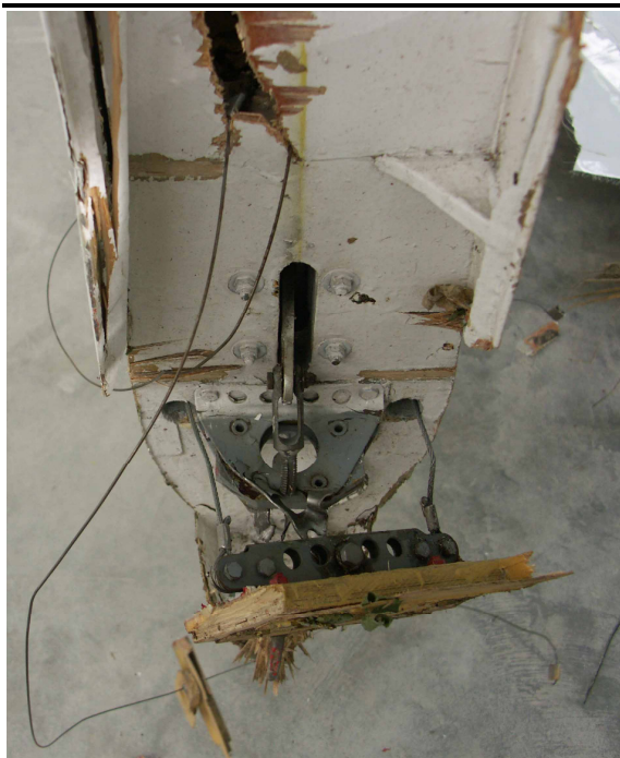
14 – Dolny wspornik steru kierunku na dźwigarze tylnym statecznika pionowego.
