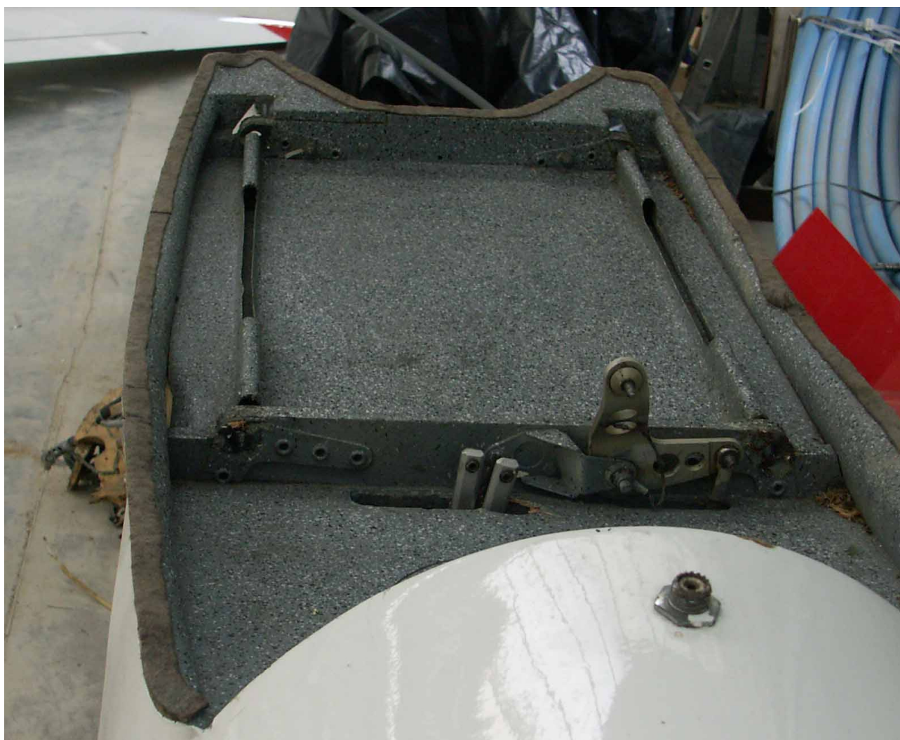
7 – Grzbiet przedniej części kadłuba z okuciami mocowania centroplata.
