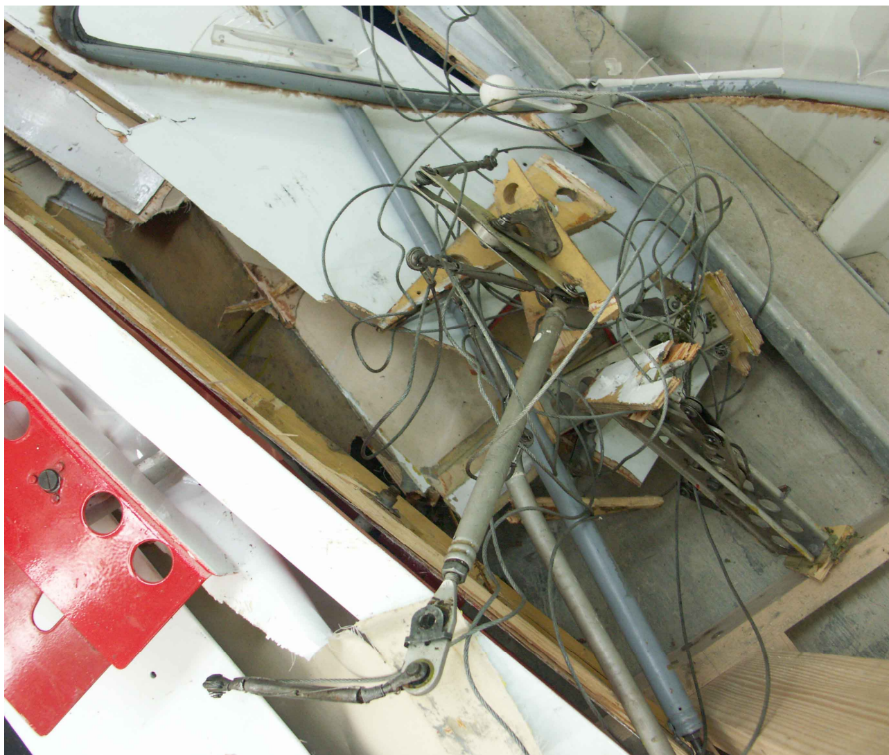
16 – Szczątki układów sterowania lotkami i hamulcami aerodynamicznymi w skrzydle.
