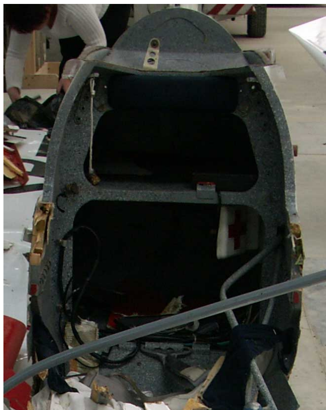
9 – Wręga za kabina pilota.
