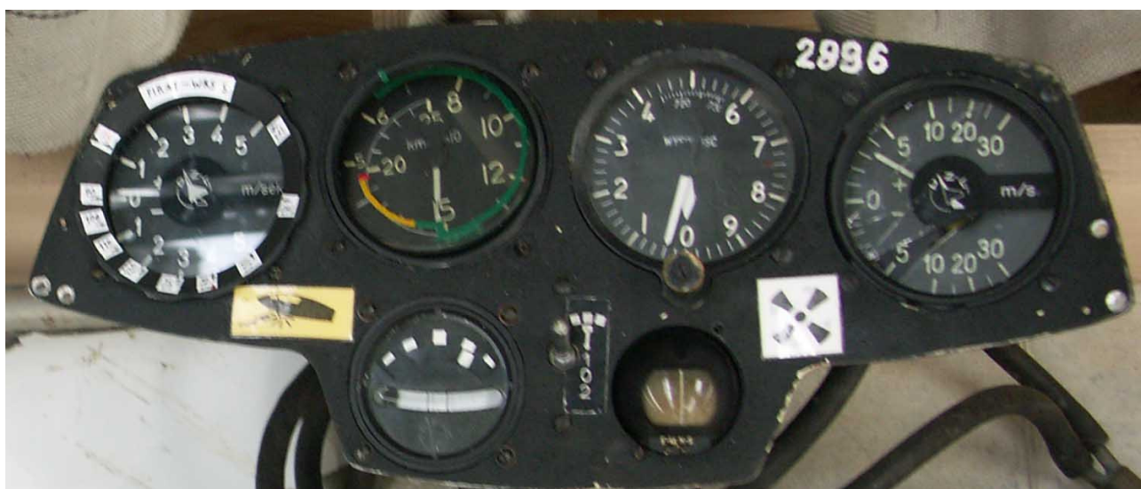
20 – Tablica przyrządów – widoczne zachowane wskazania na niektórych z nich.
