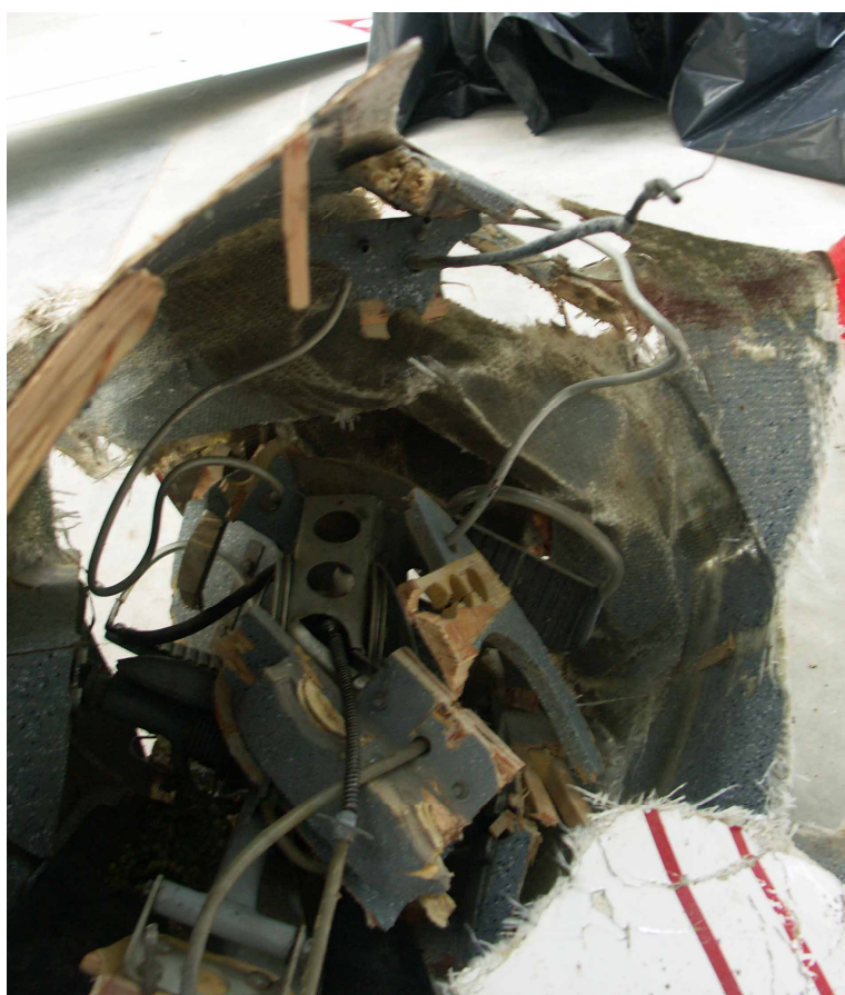
11 – Wnętrze przedniej części kabiny, widoczne szczątki pedałów i układu sterowania sterem kierunku.
