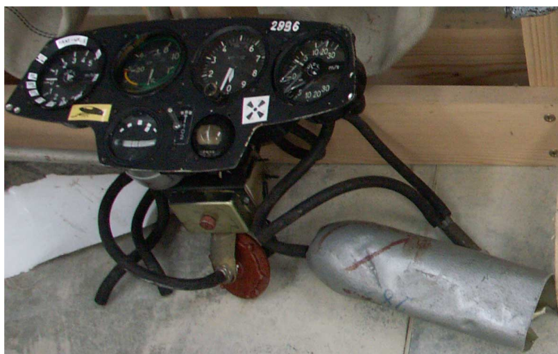
18 – Tablica przyrządów z termosem i przewodami powietrznymi.
