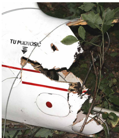
16, 17 i 18 – Zbliżenia przetłomu belki ogonowej kadłuba.
