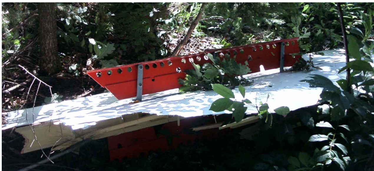
8 – Odłamane prawe skrzydło z wysuniętymi płytami hamulców aerodynamicznych.
