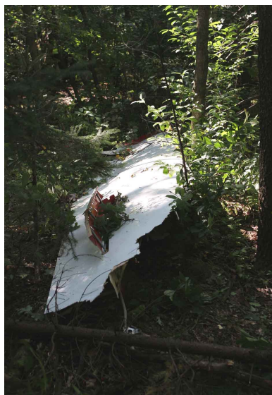
6 i 7 – Prawe skrzydło odłamane wraz z częścią centropłata.
