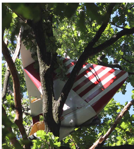
12 i 13 – Usterzenie, odłamane wraz z końcówką belki kadłubowej: po lewej stronie uwięzione między konarami drzewa, po prawej już na ziemi.
