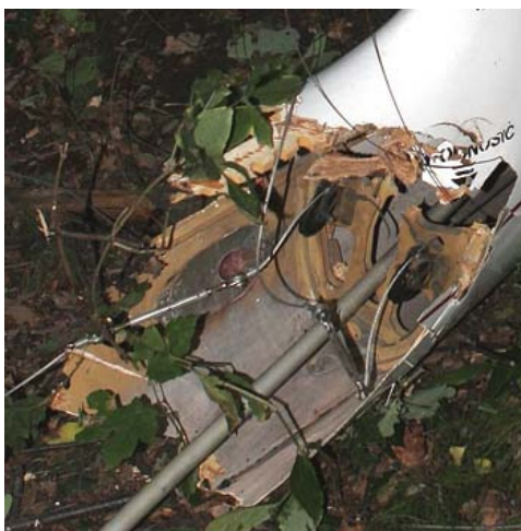
16, 17 i 18 – Zbliżenia przetłomu belki ogonowej kadłuba.
