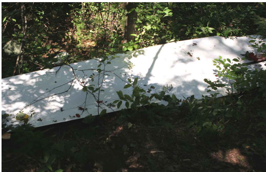
6 i 7 – Prawe skrzydło odłamane wraz z częścią centropłata.
