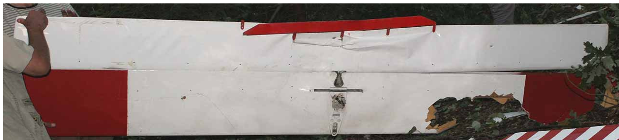
20 – Usterzenie poziome, widok od spodu.
