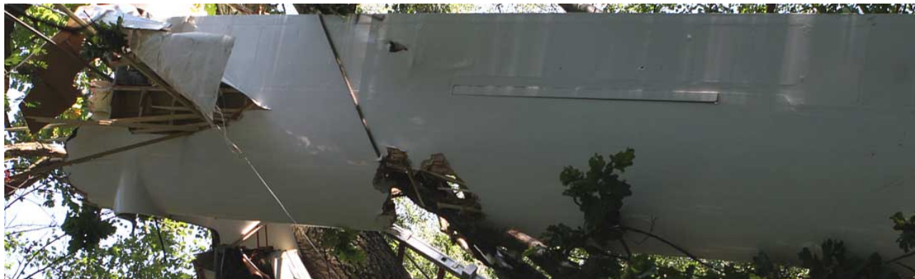
9 – Centropłat z odłamaną prawą częścią.
