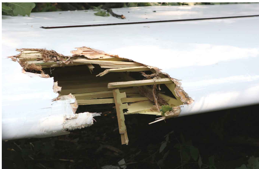
10 – Uszkodzenie krawędzi natarcia centropłat przez konar drzewa.
