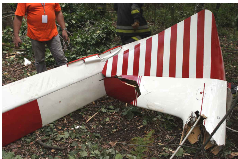
12 i 13 – Usterzenie, odłamane wraz z końcówką belki kadłubowej: po lewej stronie uwięzione między konarami drzewa, po prawej już na ziemi.
