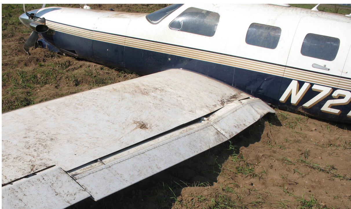
24 – Lewe skrzydło u nasady – widoczne zniekształcenia przy krawędzi spływu i uszkodzona kłapa.
