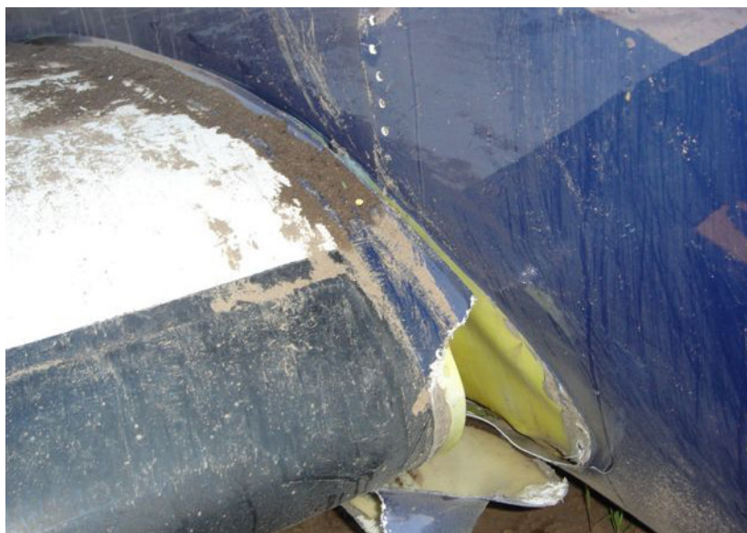
16 – Uszkodzenia prawego skrzydła u nasady przy nosku – widoczne oderwane pokrycie. Widoczny także zerwany szew nitowy wręgi kadłuba na wprowadzeniu przedniego dźwigara prawego skrzydła.
