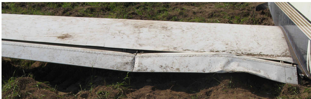
25 – Uszkodzona (połamana) lewa kłapa skrzydłowa.
