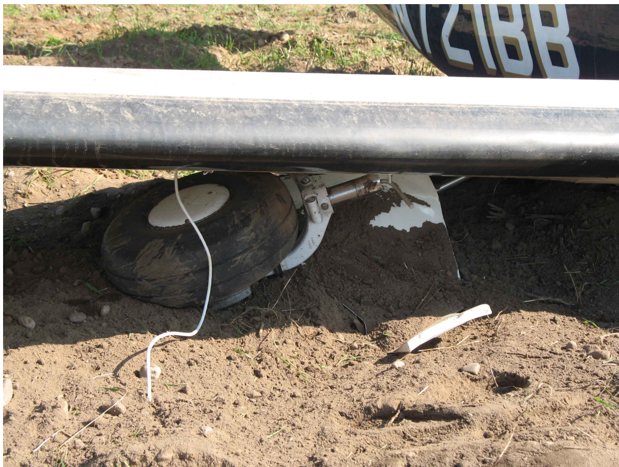
19 – Wyłamane prawe podwozie główne, widoczne zniszczone osłony luku podwozia.
