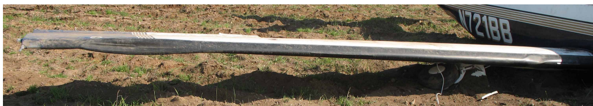
14 – Uszkodzenia noska prawego skrzydła na całej rozpiętości, pod skrzydłem widoczne wyłamane prawe podwozie główne.
