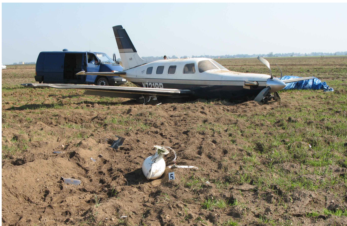
5 – Ogólny widok rozbitego samolotu, w śladzie przyziemienia na pierwszym planie oderwana od skrzydła gondolka radaru meteorologicznego.
