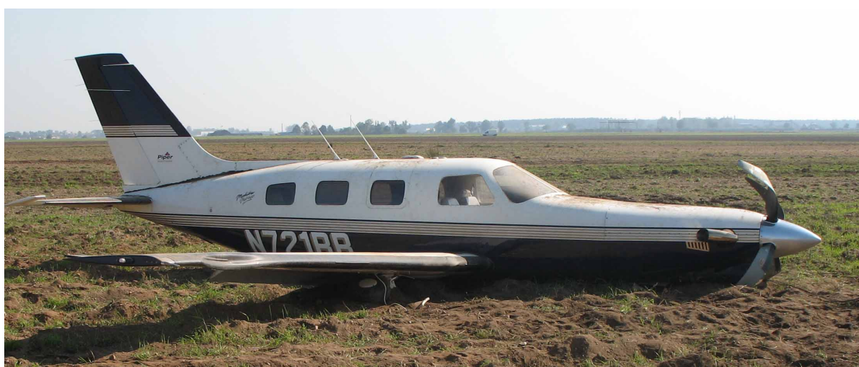
8 – Ogólny widok uszkodzonego samolotu z prawej strony, widoczne uszkodzenia skrzydła.
