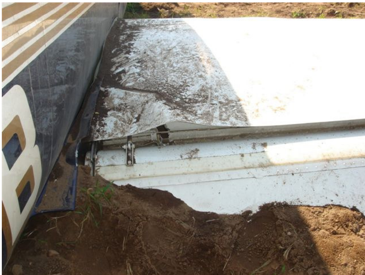
20 – Uszkodzenia prawego skrzydła u nasady, widok od tyłu.
