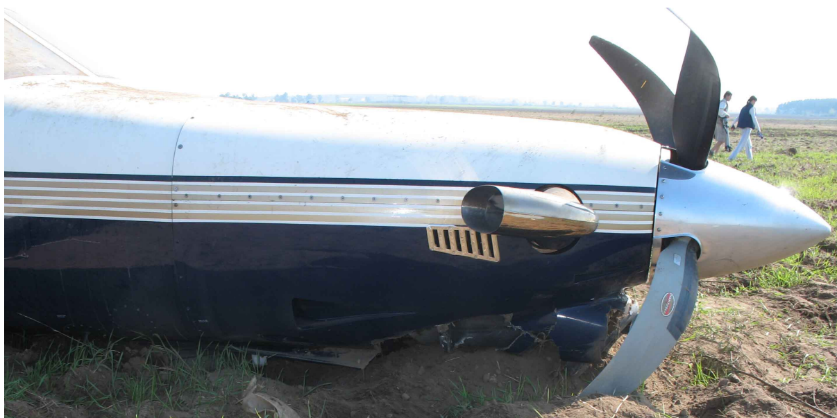
12 – Zniszczone dolne osłony silnika, prawa strona.
