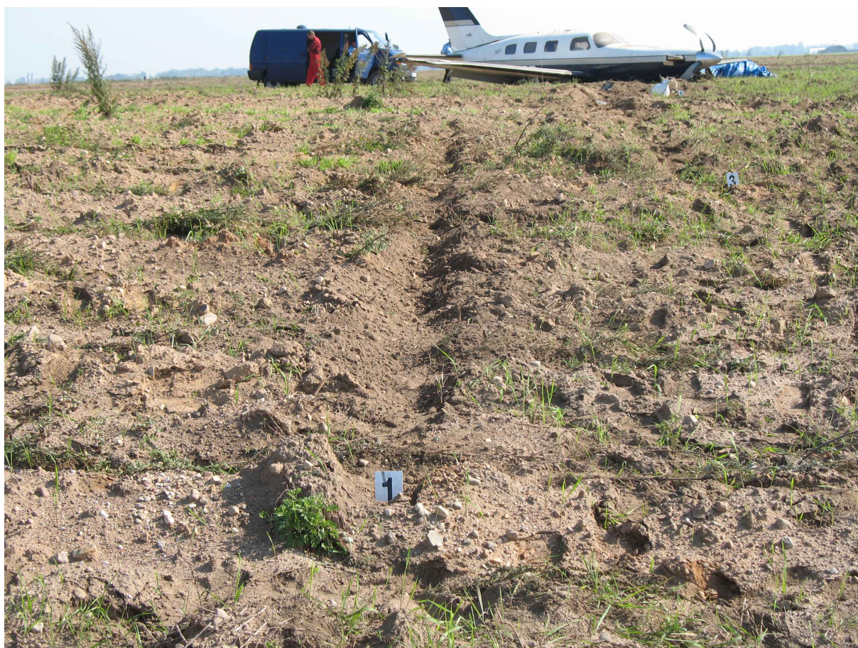
4 – Rozbity samolot i ślady przyziemienia – widać, że samolot w trakcie lądowania wykonał obrót w prawo o ok.270°.
