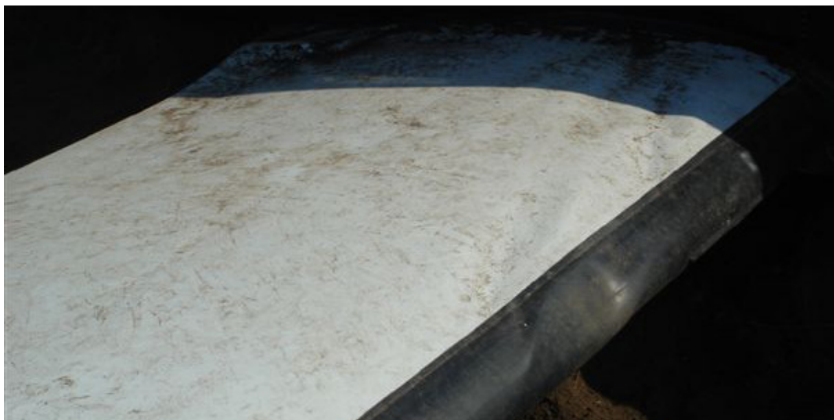
17 – Uszkodzony nosek prawego skrzydła w pobliżu nasady.
