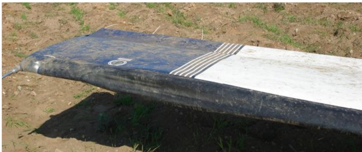
18 – Uszkodzony nosek prawego skrzydła w pobliżu końcówki.
