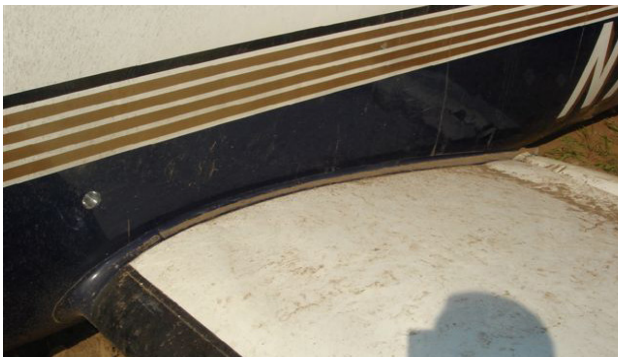
22 – Lewe skrzydło u nasady – widoczne zniekształcenia przy krawędzi spływu.
