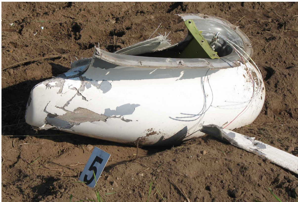
6 - Oderwana od skrzydła gondolka radaru meteorologicznego.
