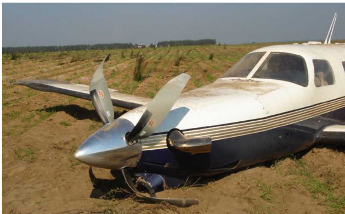
10 – Przednia część samolotu, widoczne zniszczone śmigło i uszkodzenia dolnych osłon silnika.
