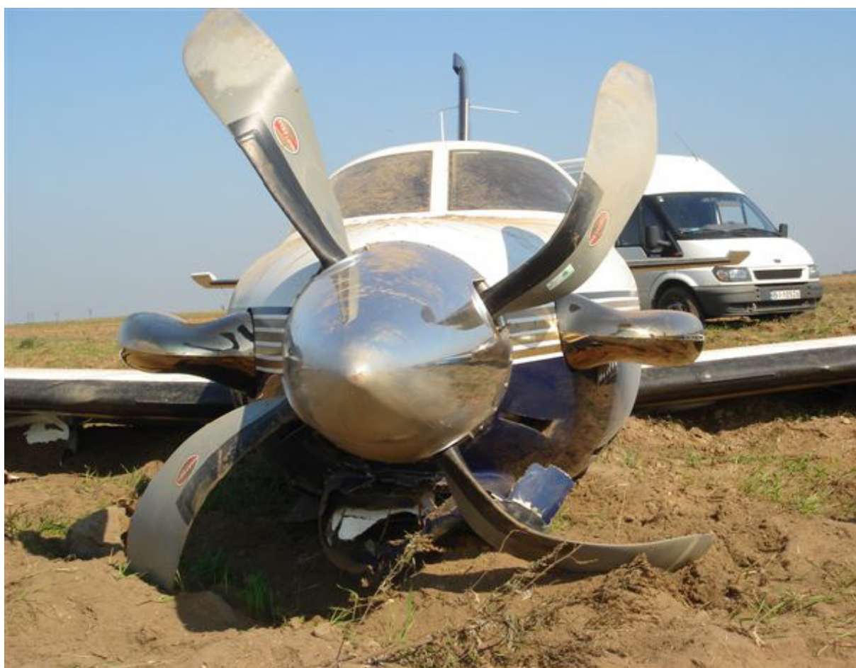
11 – Zniszczone śmigło i dolne osłony silnika.
