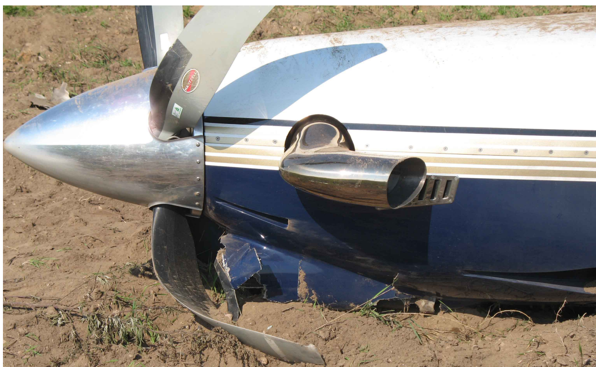
13 – Zniszczone dolne osłony silnika, lewa strona.
