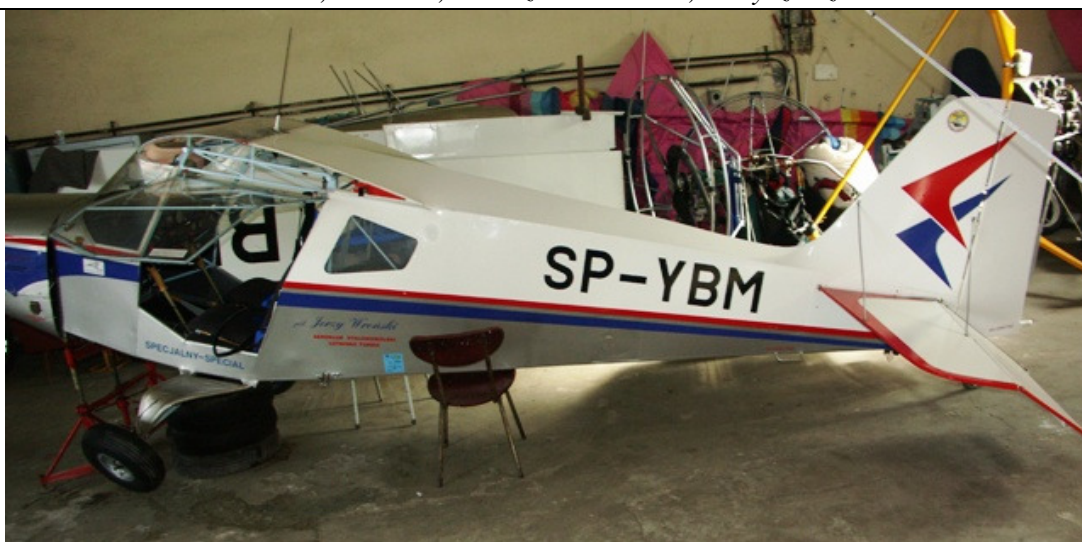
Fot. 6. Samolot w hangarze ze zdjętymi skrzydłami; widać uszkodzone lewe przednie podwozie.
