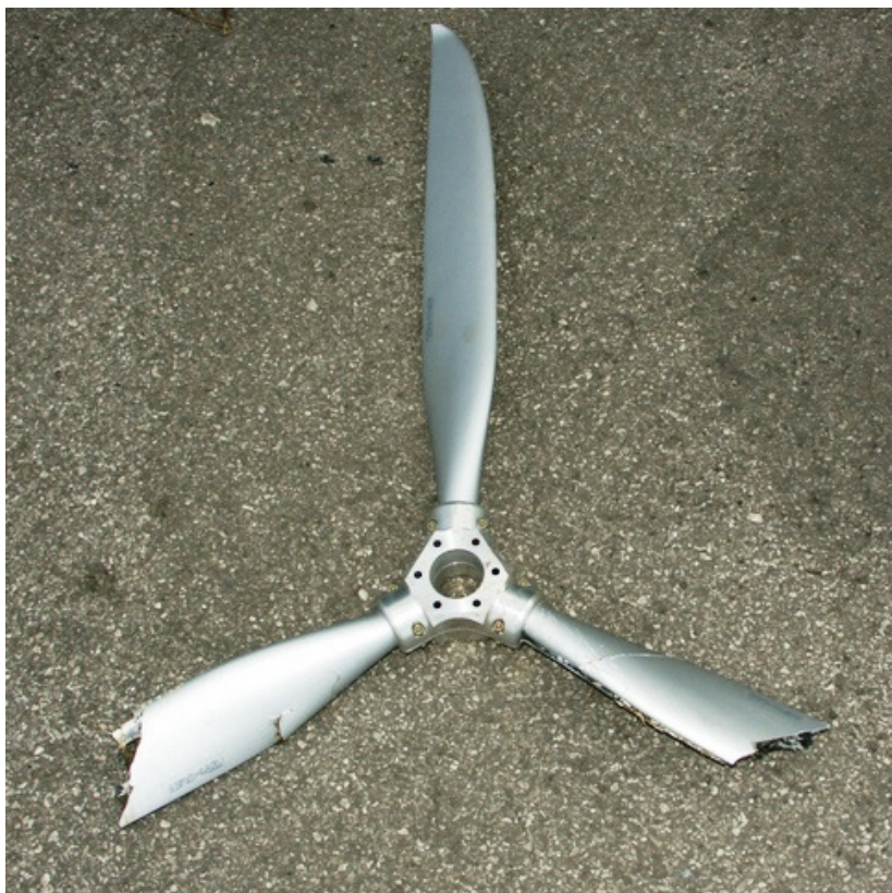
Fot. 16. Uszkodzenia śmigła w wyniku uderzenia w ogrodzenie.
