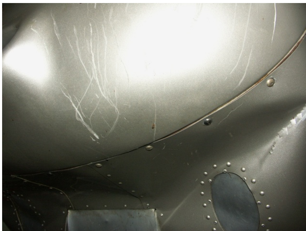
Fot. 11. Wgniecenie przedniej osłony silnika po uderzeniu w ogrodzenie.
