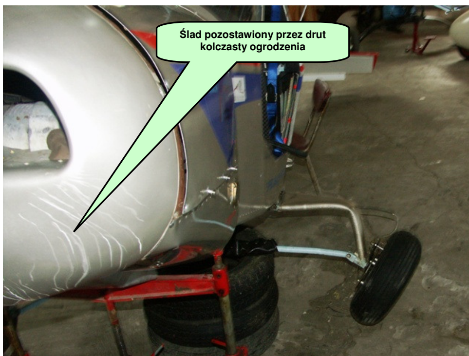
Fot. 8. Na przedniej osłonie silnika widoczne rysy po drucie kolczastym z ogrodzenia, w które uderzył samolot.
