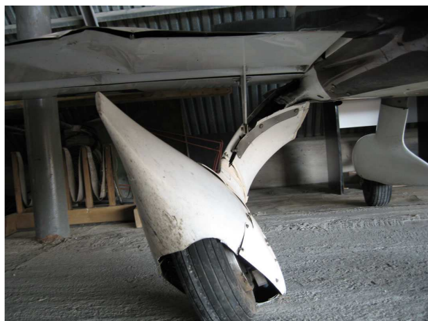
Powyżej: Złamana goleń lewego podwozia głównego i zniszczony przykadłubowy segment lewej klapy.
