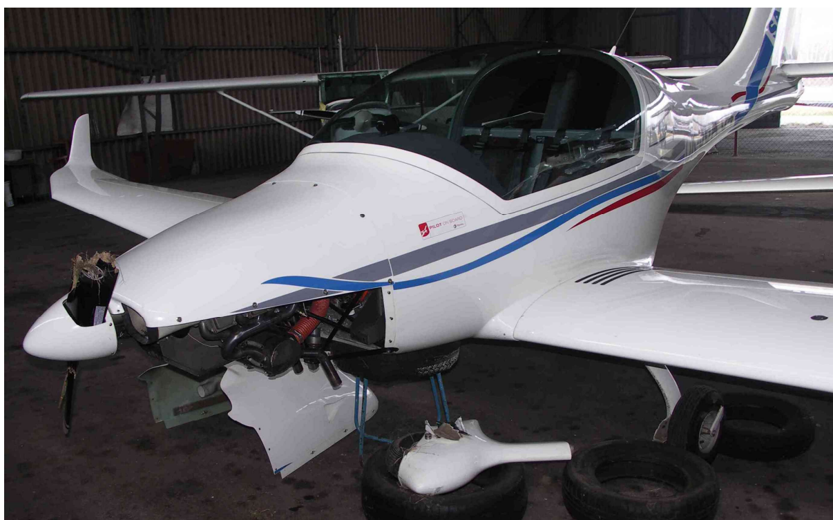
10 – Zbliżenie przedniej części kadłuba, widoczne uszkodzenia podwozia i zniszczone śmigło.
