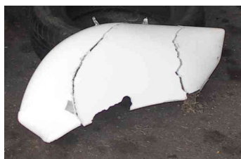
11 – Zniszczona owiewka koła prawego podwozia głównego.
