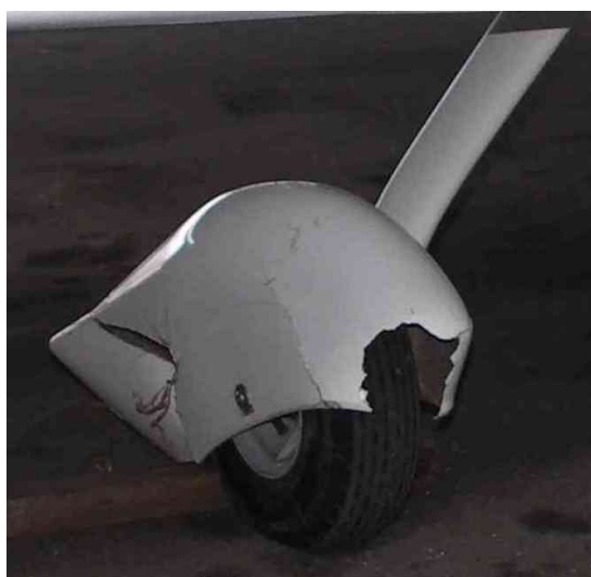
25 i 26 – Prawe podwozie główne – widoczne uszkodzenia owiewki koła.
