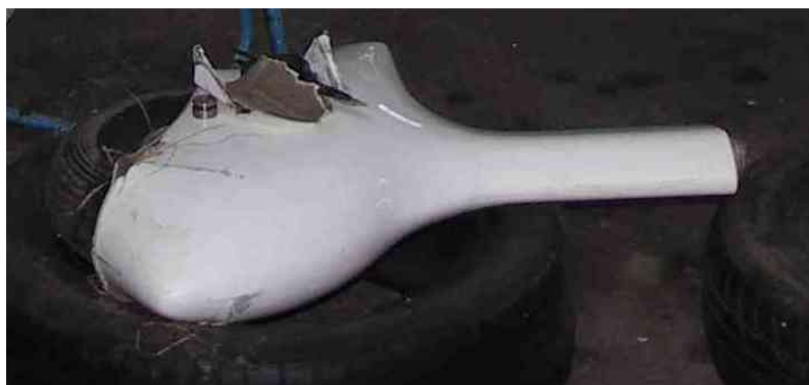
23 i 24 – Wyłamane podwozie przednie – widoczny przełam goleni.
