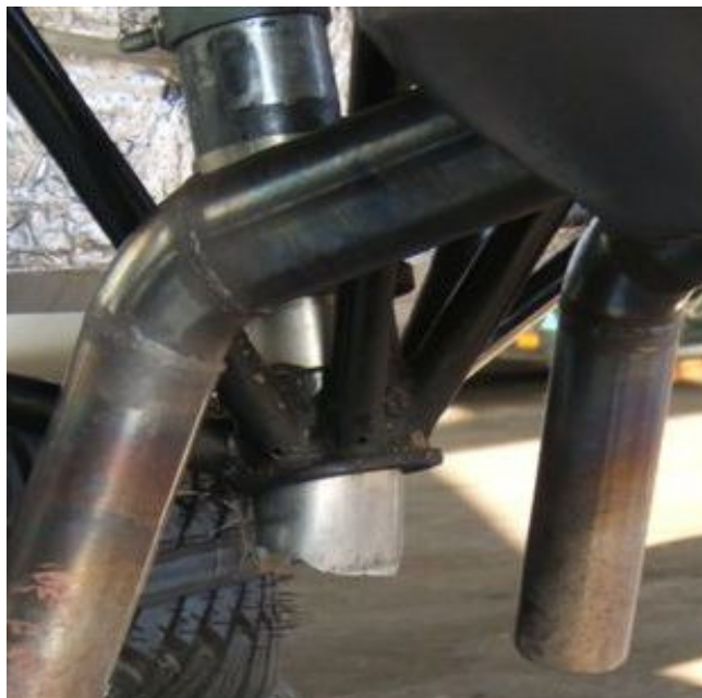
21 i 22 – Łoże silnika z wyłamaną gołenią podwozia przedniego – widoki od tyłu z lewej strony i od przodu z prawej strony.
