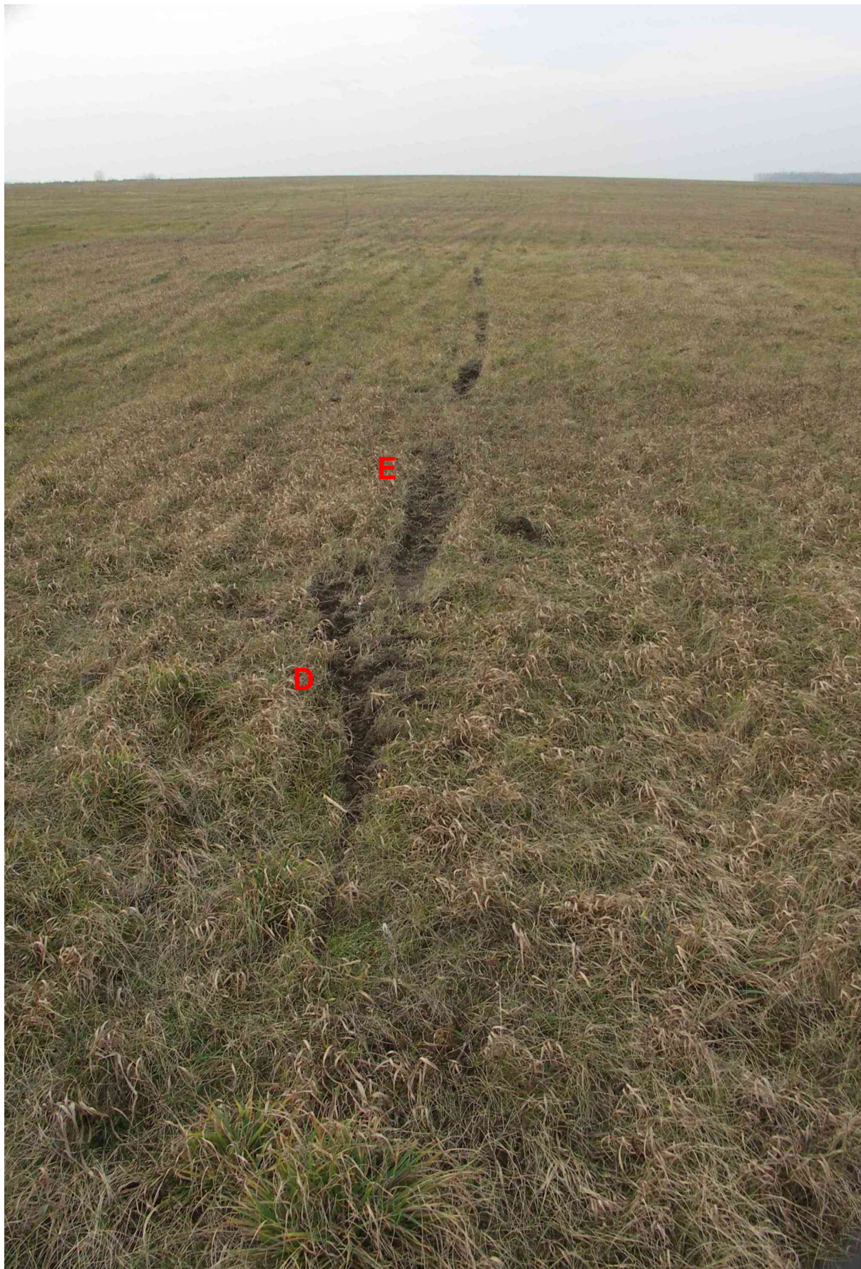
8 – Ślad złamania śmigła [D], dalej ślad rycia dolnej osłony silnika [E].
