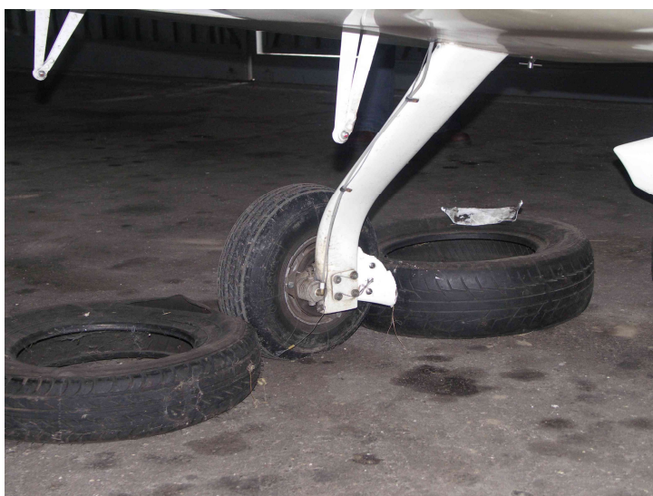
27 i 28 – Lewe podwozie główne – owiewka koła całkowicie odłamana (patrz ilustracja 11).
