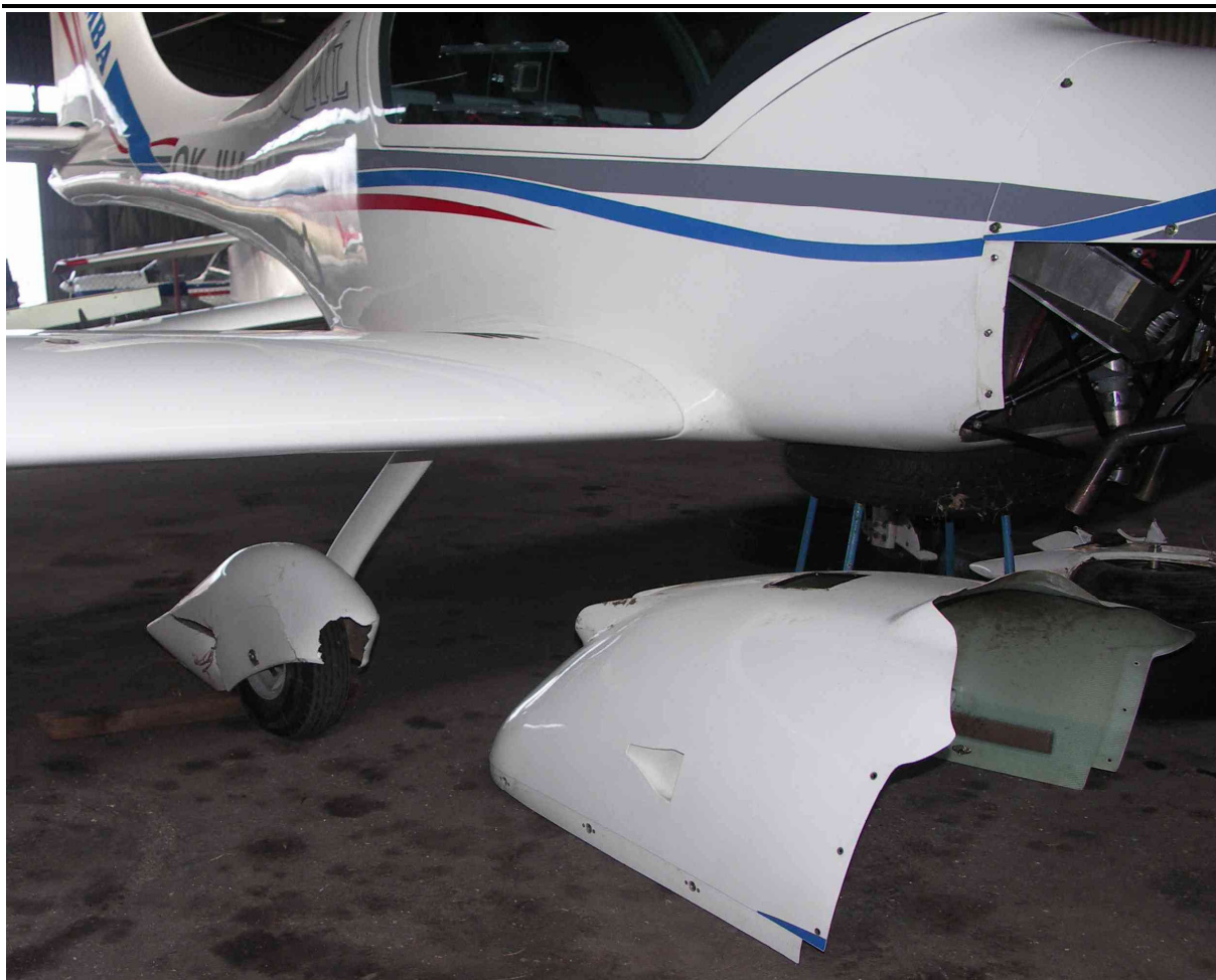
15 – Przednia część kadłuba z prawej strony, widoczne uszkodzenia podwozia i dolnej osłony silnika.
