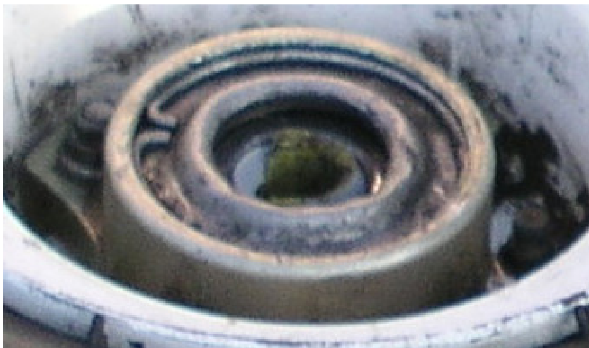
14 – Powiększenie fragmentu piasty, widoczny pierścień osadczy łożyska, nakładka zabezpieczająca łożysko i ułamana oś koła.
