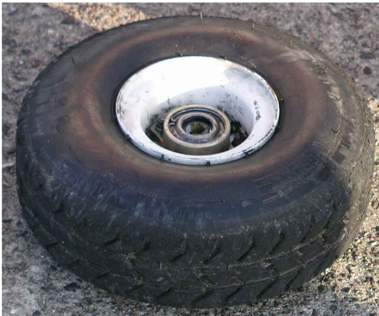
13 – Oderwane koło przednie od strony półwidelca podwozia.
