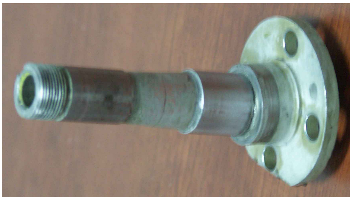
17 – Ułamana oś po zdemontowaniu i złożeniu – widoczny przełom, ubytek kołnierza i otarcia powierzchni elementami łożyska.
