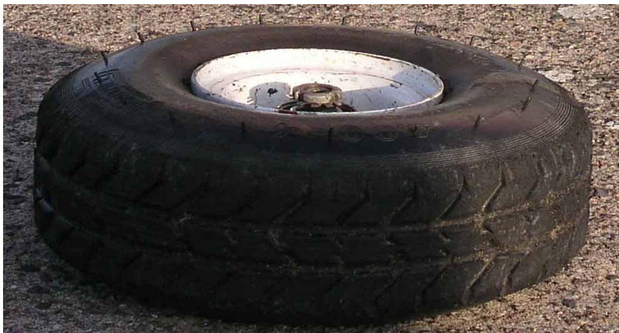
15 – Oderwane koło przednie od strony końcówki osi.
