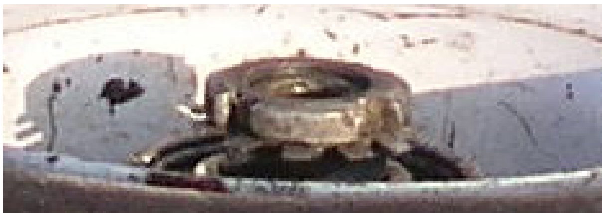
16 – Powiększenie fragmentu piasty, widoczna nakrętka i podkładka łożyskowa na końcówce osi koła.
