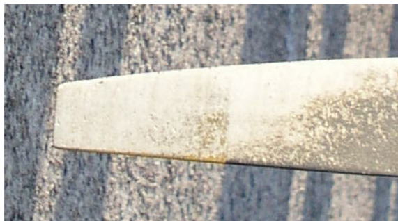
6 i 7 – Końcówki łopat śmigła – brak oznak kontaktu z powierzchnią lotniska.
