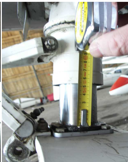
Fig.4 – Wysunięcie gładzi trzonu amortyzatora podwozia przedniego po incydencie.
