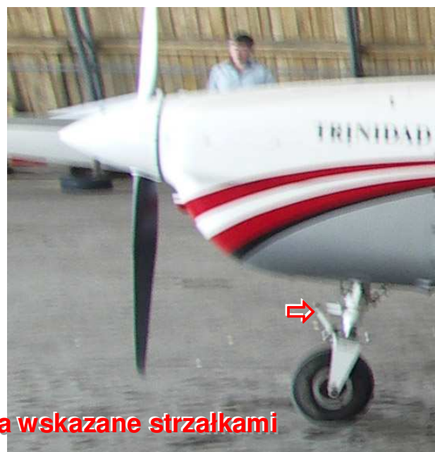
Fig.11 – Powiększenie fragmentu wykonanej w hangarze Aero-klubu Ziemi Piotrkowskiej fotografii samolotu po incydencie. Łatwo zauważyć inne, niż na Fig.10 położenie katowe górnego elementu nożyc przedniego podwozia względem osi jego goleni, wynikające z „dobicia” amortyzatora. Foto: PKBWL
