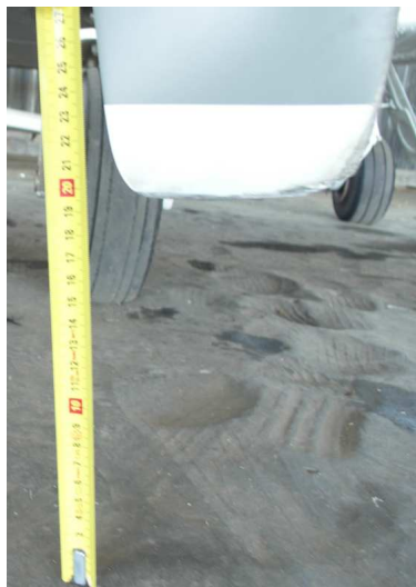
Fig.2 – Prześwit śmigła po incydencie; widoczne uszkodzenie łopaty.
