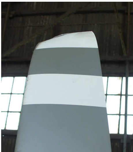
Fig.3 – Uszkodzenia końcówki drugiej łopaty śmigła.
