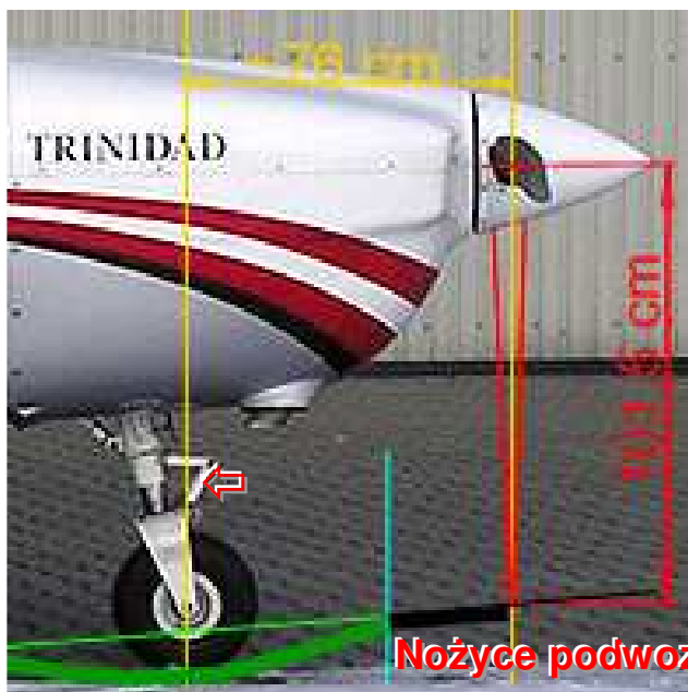
Fig.10 – Na fotografii sylwetki samolotu TB-20 Trinidad (SP-EAS) wykonanej przed incydemt naniesiono (z zachowaniem skali) łopatę śmigła, profil podłoża na linii kołowania oraz odpowiednie wymiary. Linia zielona oznacza podłoże trawiaste, czarna – asfalt. Foto: internet
