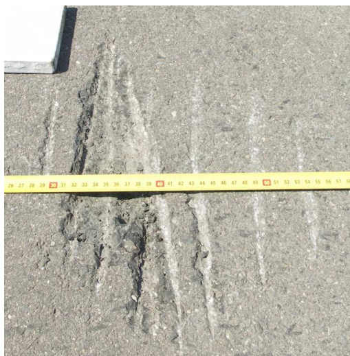
Fig.5 i 6 – Fotografie pomiarów, które posłużyły do wyznaczania prędkości kołowania oraz kąta między kierunkiem linii kołowania samolotu a linią bocznej krawędzi asfaltowej drogi kołowania.
