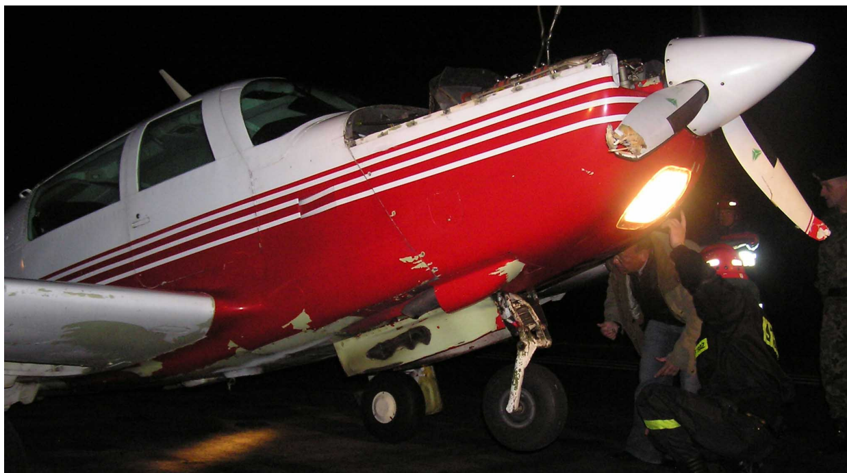
Fot.6 – Spód przedniej części kadłuba podczas unoszenia samolotu, widoczne uszkodzenia pokryć i łopat śmigła.
