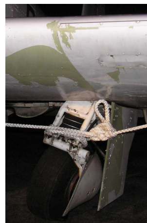
Fot.9 – Częściowo otwarte lewe podwozie główne.
