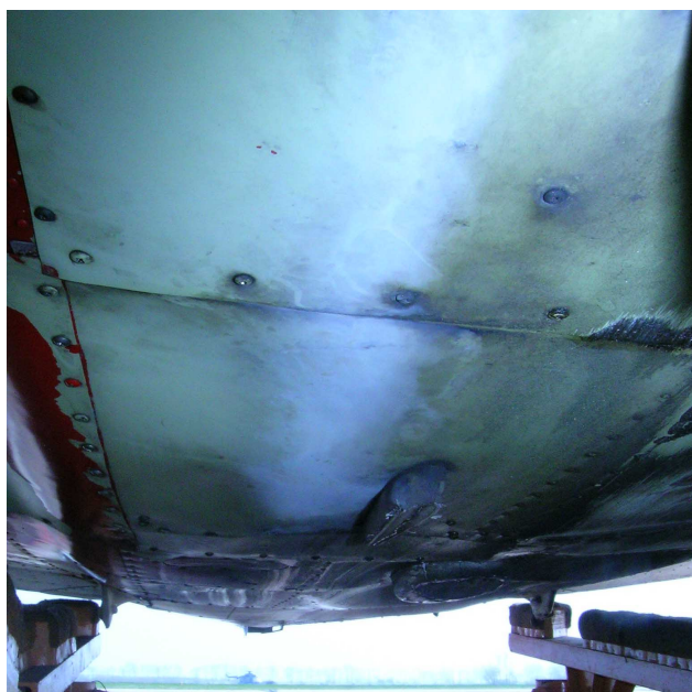
Fot.10 – Uszkodzenia spodu kadłuba.
