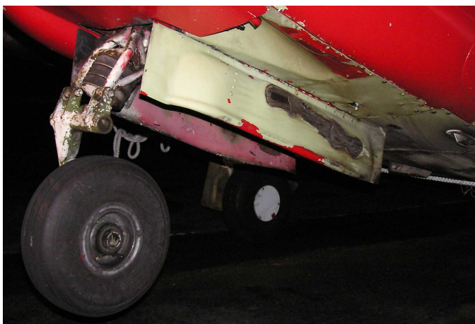
Fot.8 – Widok z lewej strony na podwozie przednie; widoczne uszkodzenia pokryw luku podwozia, pokryć i anten.
