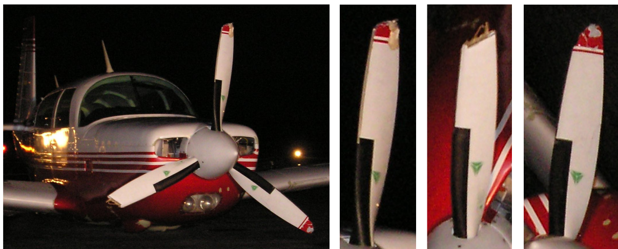
Fot.5a, 5b, 5c, 5d – Widok uszkodzonego samolotu z przodu i zbliżenia uszkodzonych łopat śmigła.
