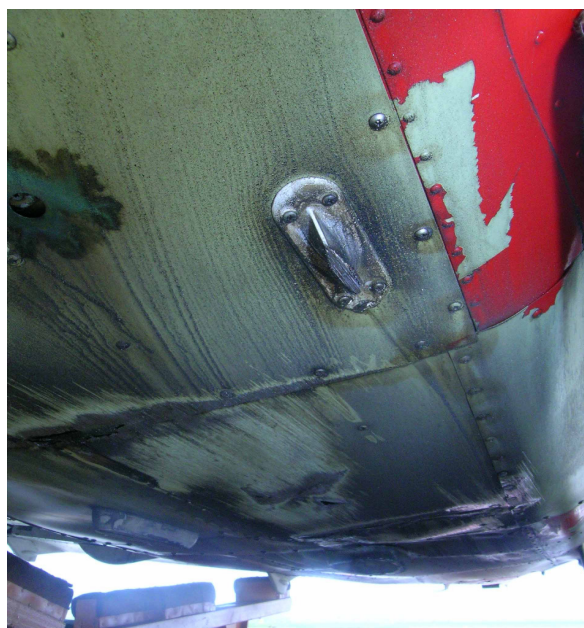
Fot.11 – Uszkodzenia spodu kadłuba.
