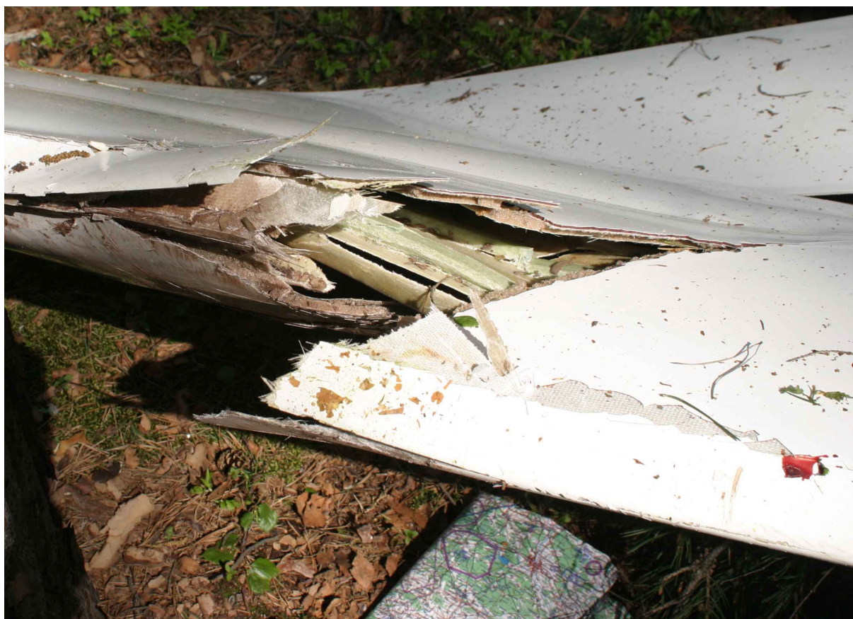
23 – Krawędź natarcia prawego skrzydła zniszczona wskutek kolizji z drzewem, pod skrzydłem mapa, która wypadła z kabiny..
