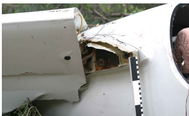
17 – Prawe skrzydło wyłamane u nasady z kadłuba.
