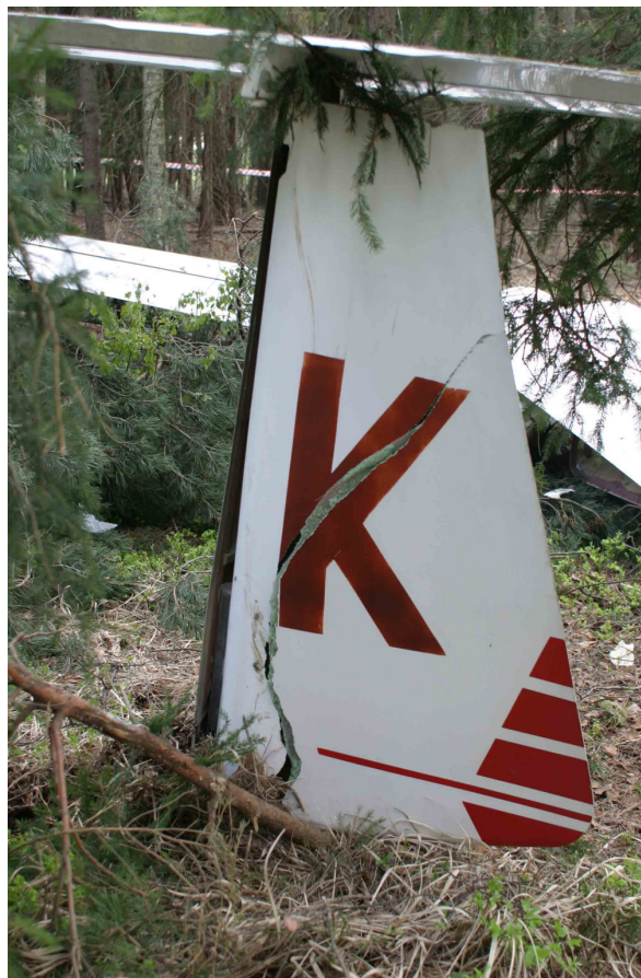
24 i 25 – Usterzenie pionowe z lewej strony; widoczne uszkodzenia steru kierunku.
