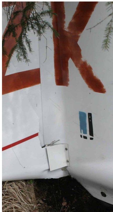
26 i 27 – Usterzenie pionowe z prawej strony; widoczne uszkodzenia steru kierunku i wyłamany fartuch statecznika pionowego.
