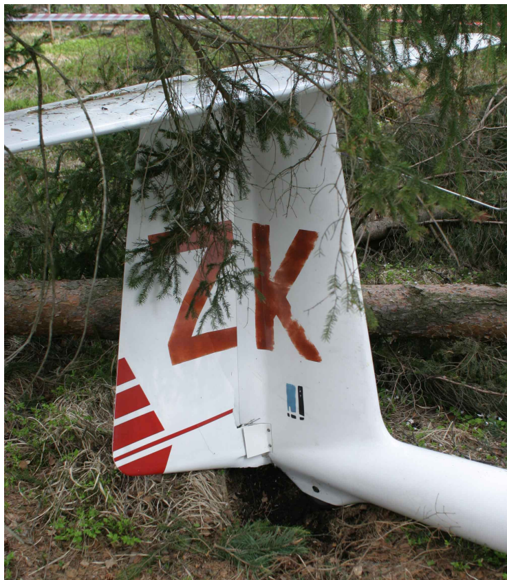
26 i 27 – Usterzenie pionowe z prawej strony; widoczne uszkodzenia steru kierunku i wyłamany fartuch statecznika pionowego.
