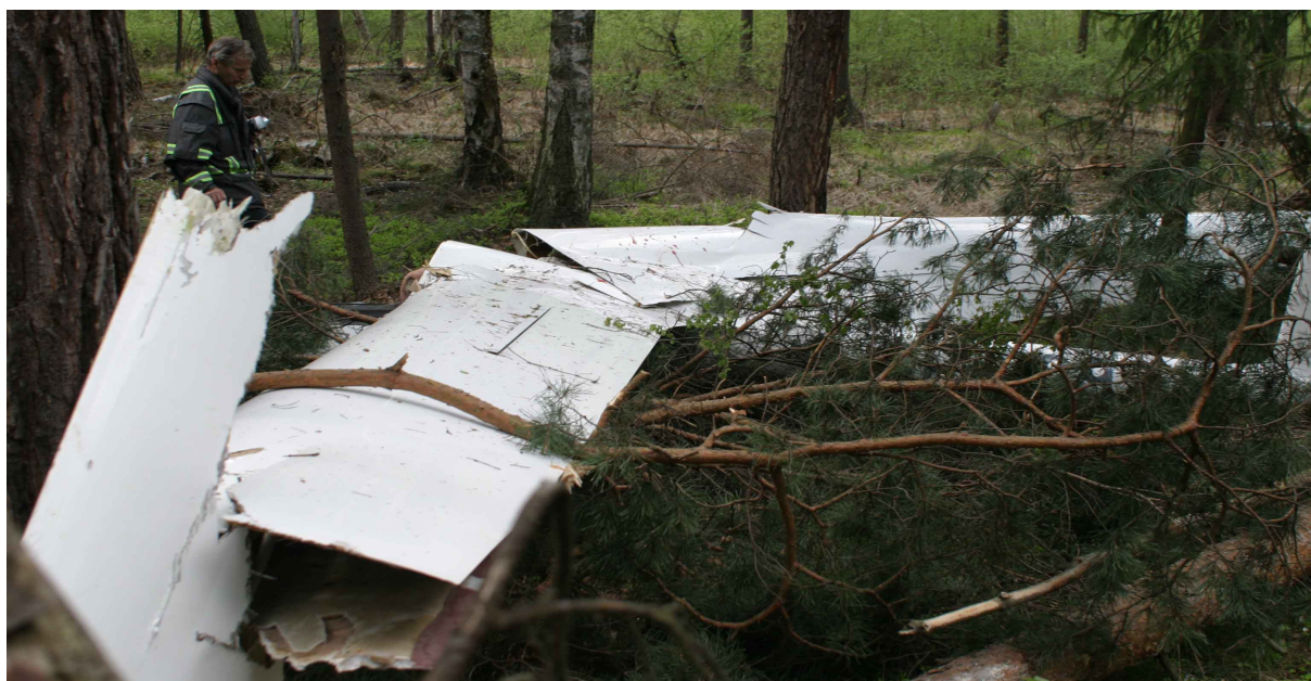
5 – Ogólny widok rozbitego szybowca z lewej strony, widoczne zniszczone lewe skrzydło.
