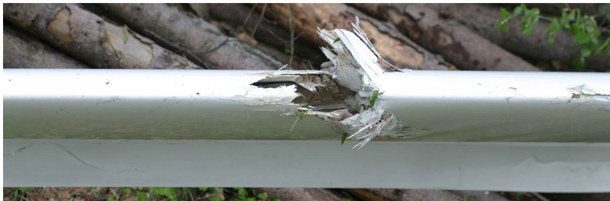
16 – Uszkodzenie krawędzi natarcia prawego skrzydła w rejonie lotki.
