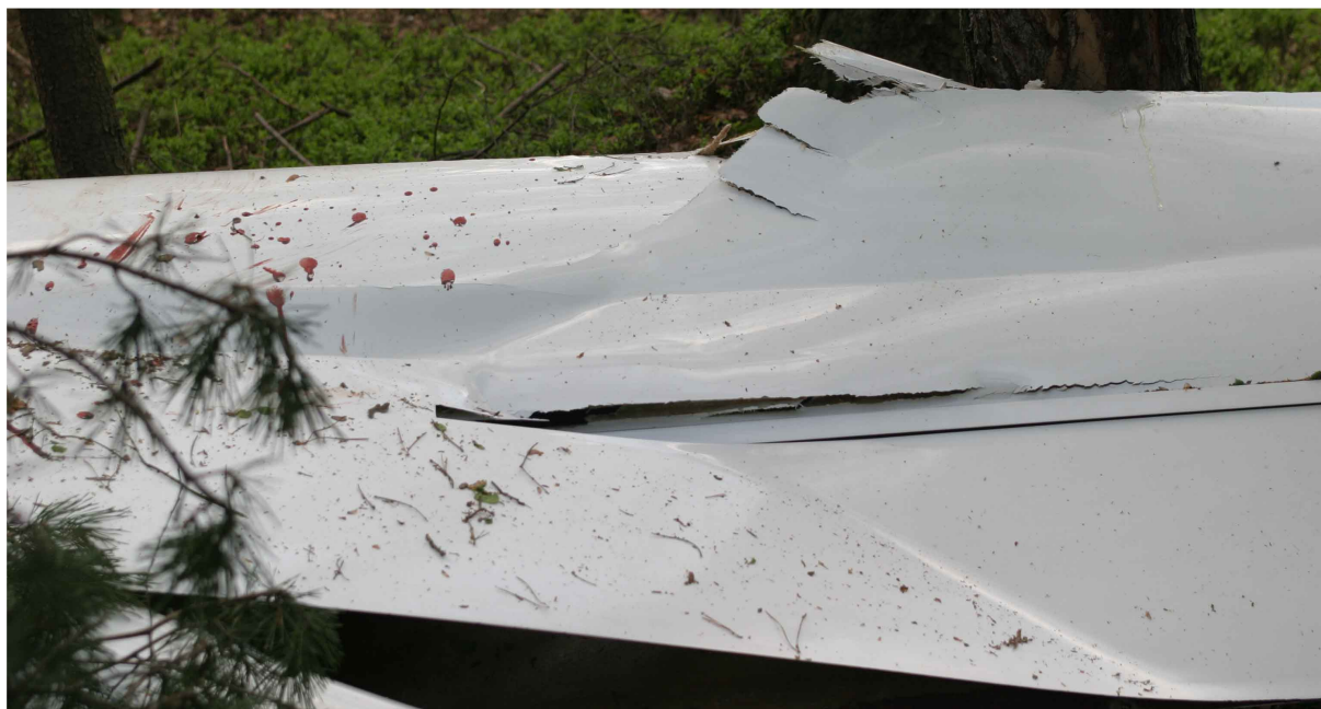
22 – Krawędź natarcia, krawędź spływu i pokrycia kesonu prawego skrzydła zniszczone wskutek kolizji z drzewem. Widoczny hamulec aerodynamiczny.
