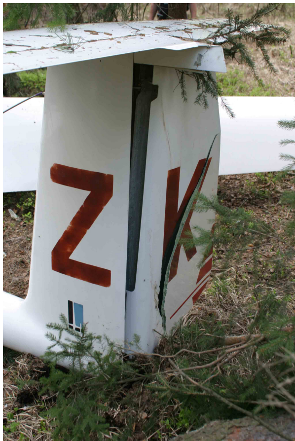
24 i 25 – Usterzenie pionowe z lewej strony; widoczne uszkodzenia steru kierunku.
