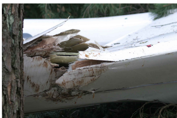
18 – Krawędź natarcia prawego skrzydła zniszczona wskutek kolizji z drzewem.
