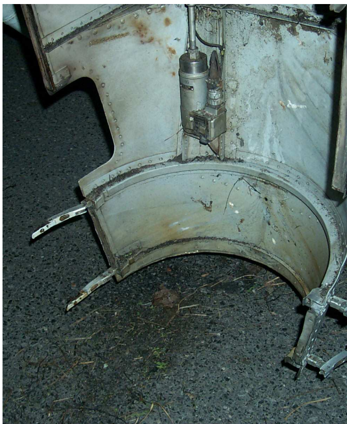
Fot.4 – Spalone resztki ptasiego gniazda, wysypane spod otwartych osłon lewego silnika samolotu. Na wręgach osłon widoczny popiół ze spalonego materiału roślinnego.
