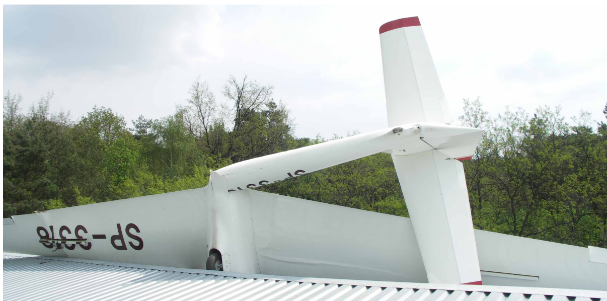
11 – Szybowiec wbity w dach hangaru, widok od spodu.
