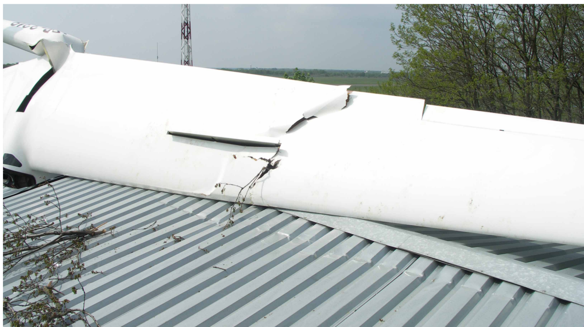
9 – Uszkodzone lewe skrzydło szybowca i gałęzie zerwane przez nie z drzewa, widoczny ślad uderzenia w dach.
