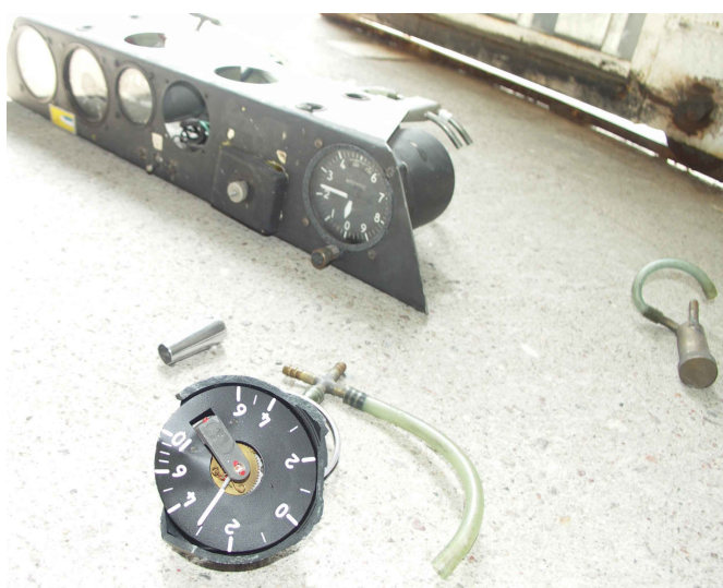
18 – Tylna tablica przyrządów, wyrwany z przedniej tablicy wariometr i resztki przewodów systemu pomiaru prędkości.
