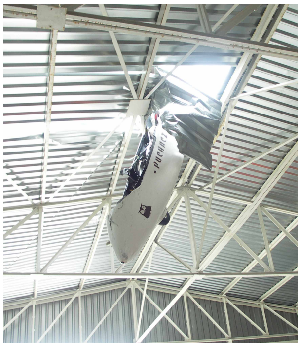
15 i 16 – Kabinowa część kadłuba szybowca wewnątrz hangaru po przebiciu dachu, z lewej i prawej strony.
