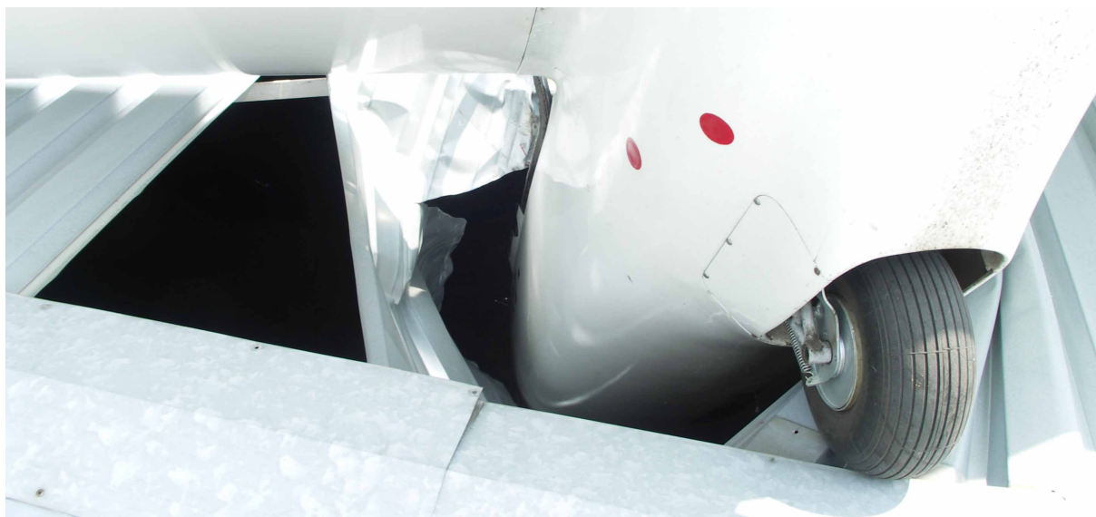
12 - Miejsce wbicia się kadłuba szybowca w dach hangaru od strony podwozia.
