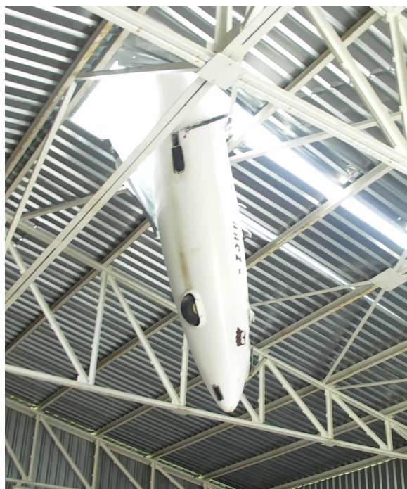
15 i 16 – Kabinowa część kadłuba szybowca wewnątrz hangaru po przebiciu dachu, z lewej i prawej strony.
