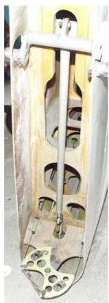
24 i 25 – Statecznik pionowy po zdjęciu steru kierunku (z lewej) i uszkodzenia dolnego pokrycia lewego skrzydła przez gałąź drzewa; widoczna wysunięta płyta hamulca aerodynamicznego.
