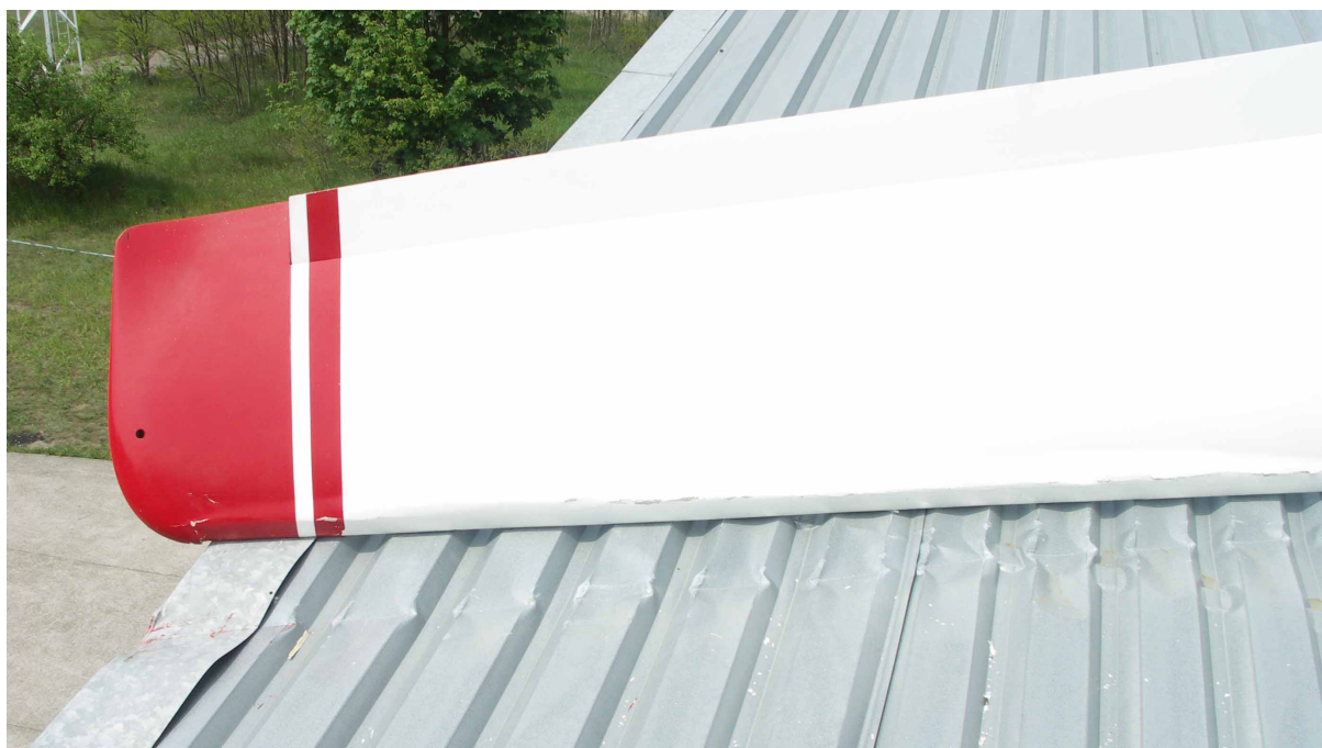
5 – Końcówka prawego skrzydła i ślad uderzenia skrzydłem na blachach dachu.
