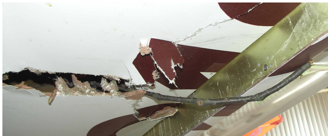
24 i 25 – Statecznik pionowy po zdjęciu steru kierunku (z lewej) i uszkodzenia dolnego pokrycia lewego skrzydła przez gałąź drzewa; widoczna wysunięta płyta hamulca aerodynamicznego.
