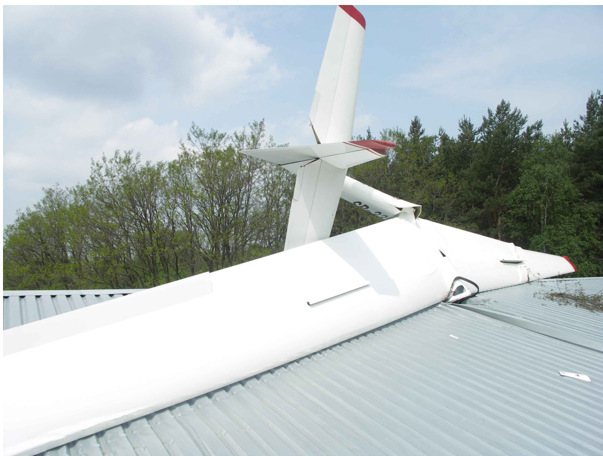
4 – Szybowiec na dachu hangaru, prawa strona. Widoczny ślad uderzenia skrzydłem na blachach dachu.
