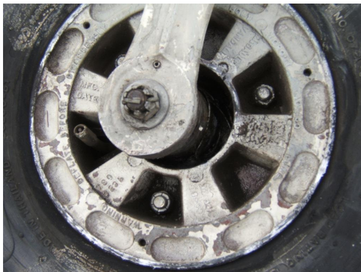
18 – Koło podwozia przedniego, oderwane wraz z widelcem.
