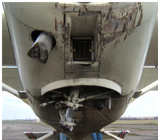
15 – Uszkodzenia osłon silnika i rury wydechowej od przodu. Widoczna goleń podwozia przedniego i jej uszkodzenia.
