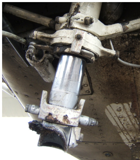
19 – Złamane podwozie przednie od przodu.
