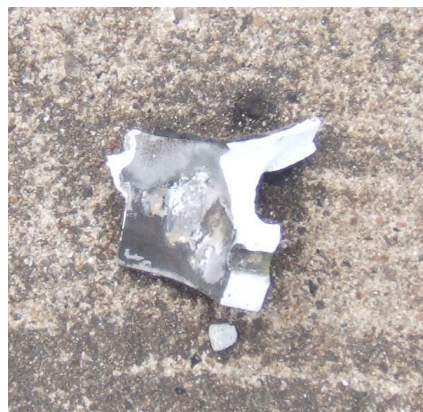
9 – Odłamek kołnierza widelca podwozia przedniego [3]
