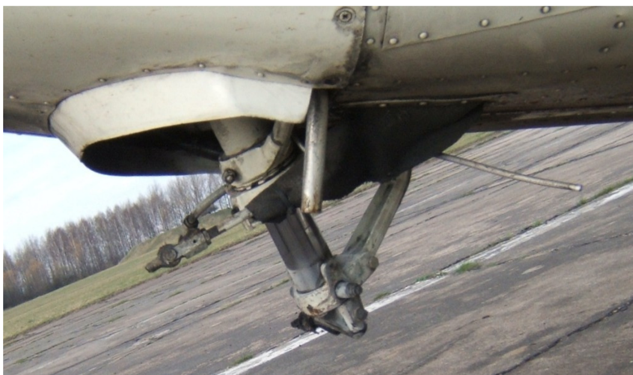
22 – Złamane podwozie przednie, lewa strona.
