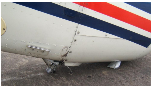
13 – Prawa strona osłon silnika, część dolna – widoczne uszkodzenia.
