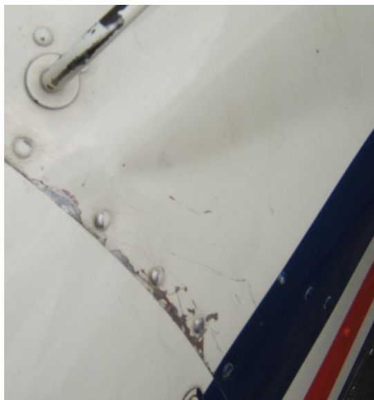
17 – Zafalowanie górnego pokrycia kadłuba za przegrodą ogniową po lewej stronie.
