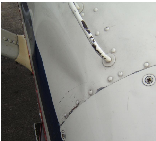
16 – Zafalowanie górnego pokrycia kadłuba za przegrodą ogniową po prawej stronie.
