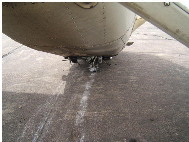
14 – Spód przedniej części kadłuba od tyłu – widoczne zniszczone przednie podwozie i rysa na betonie.
