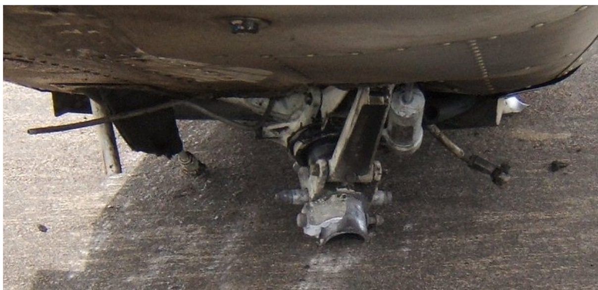
20 – Złamane podwozie przednie od tyłu.
