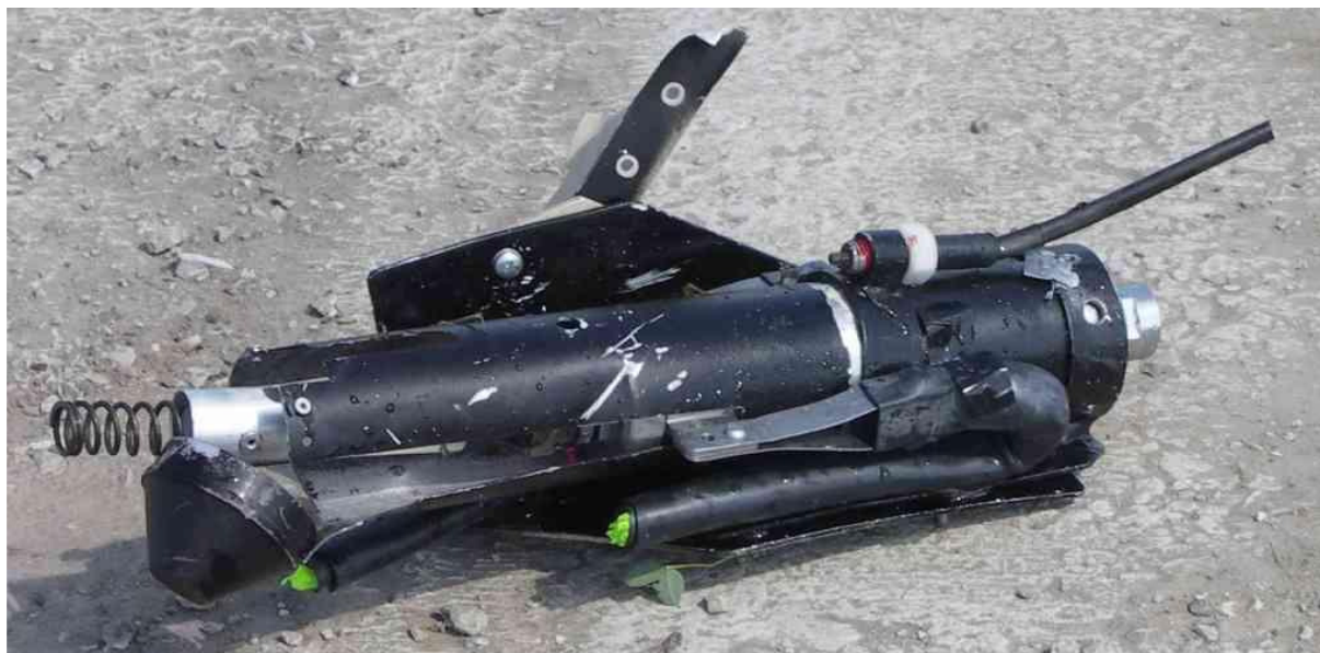
30 – Rakieta systemu ratunkowego Galaxy po odcięciu od wraku samolotu.
