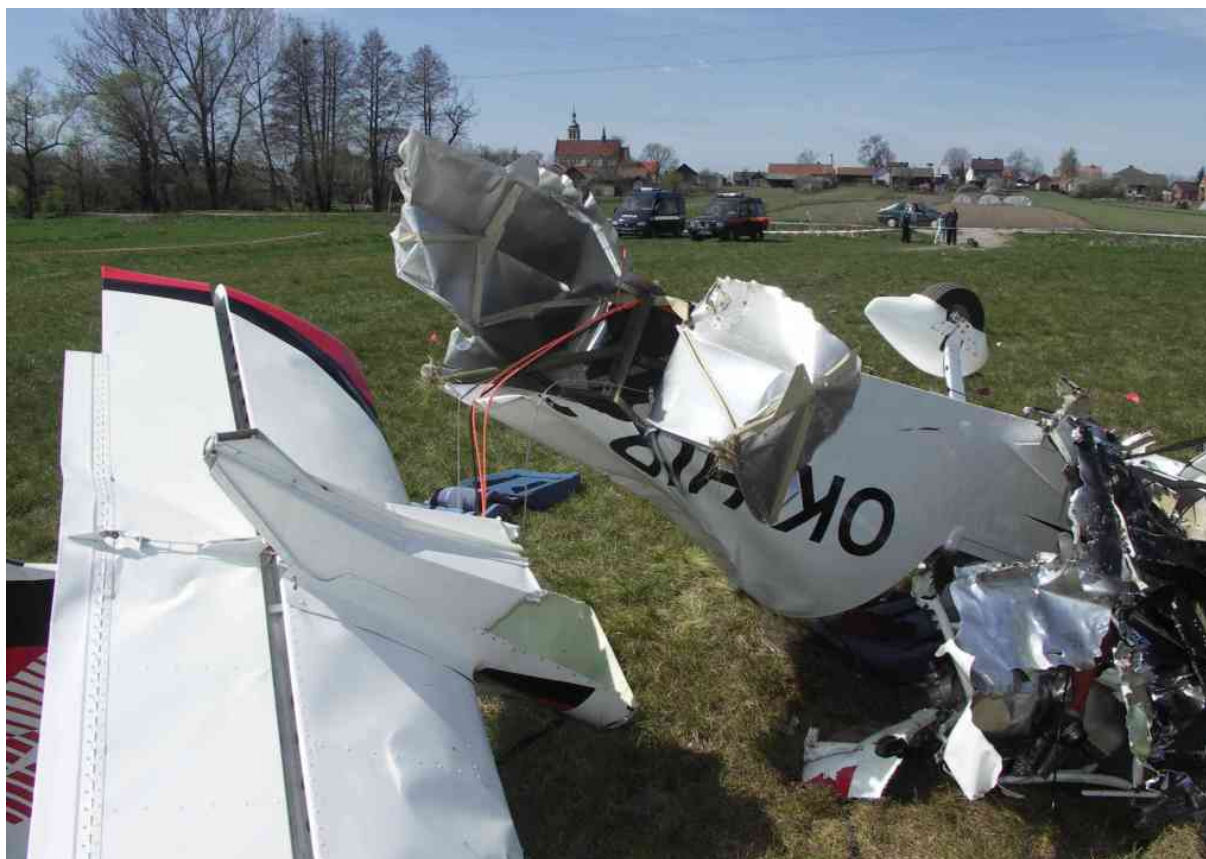
15 – Miejsce rozerwania tylnej części kadłuba. Widoczne zachowane (nie zerwane) linki systemu sterowania.
