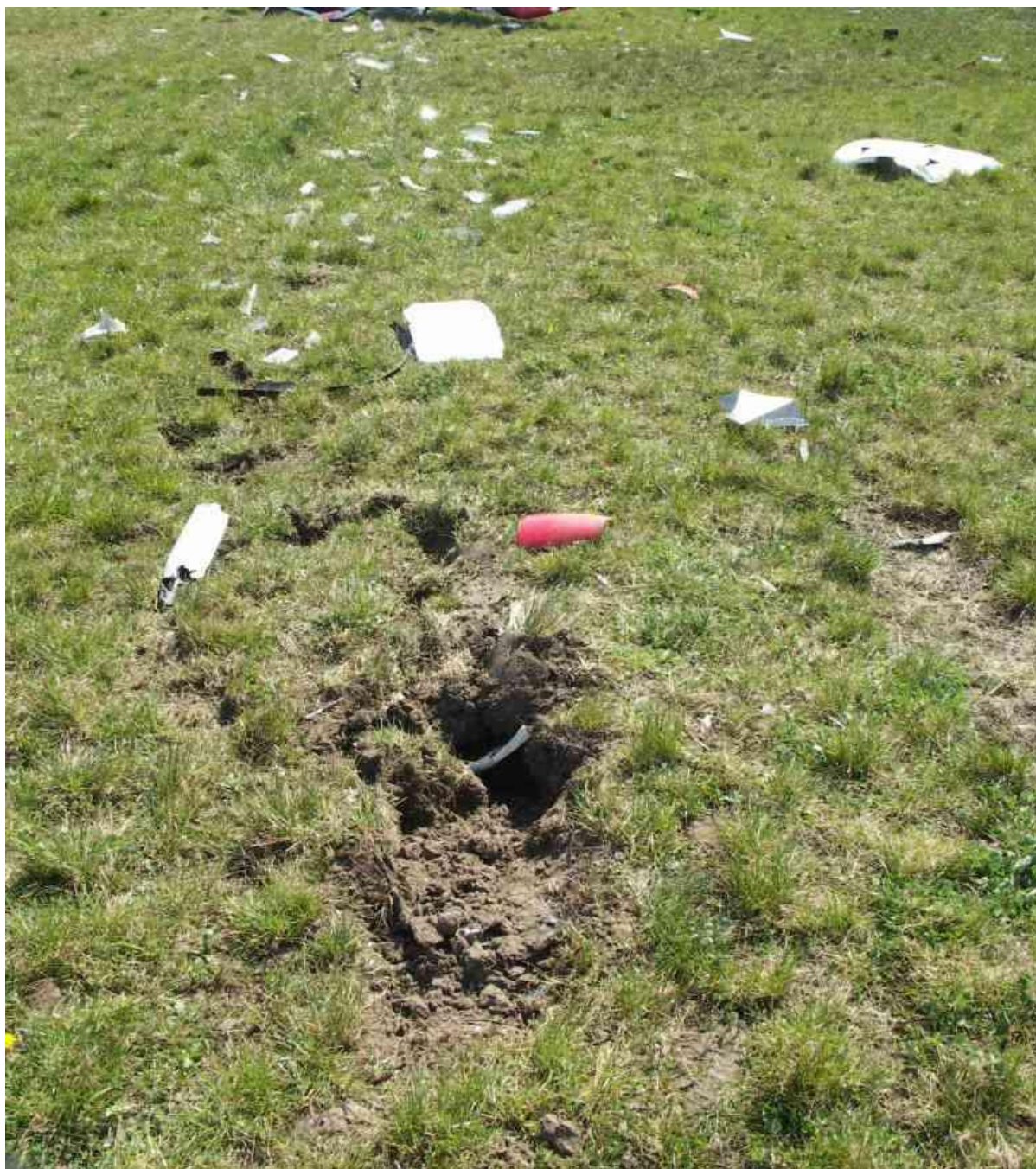
3 – Ślad uderzenia przednim podwoziem w ziemię, dalej rozsypane szczątki samolotu.
