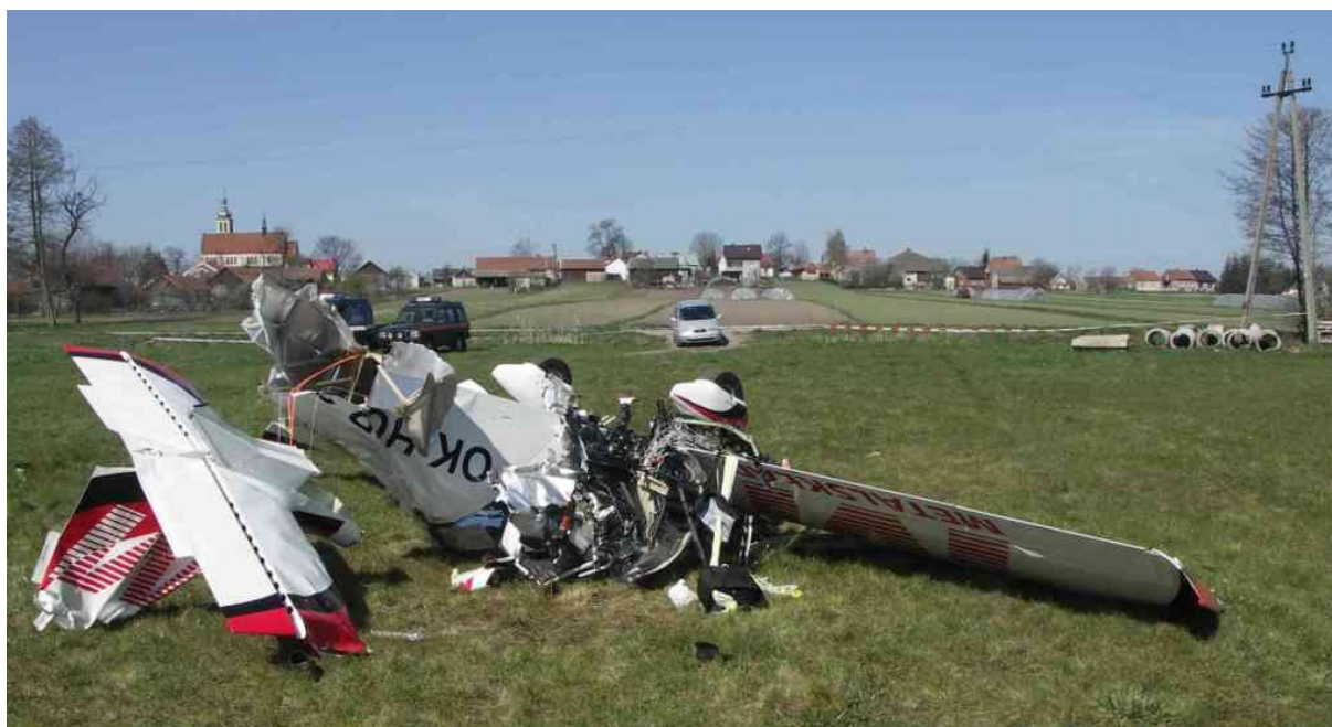
14 – Rozbity samolot, lewa strona od tyłu. Widoczne usterzenie oderwane wraz z tylną częścią kadłuba oraz szczątki przegrody ogniowej, wyłamany wraz z łożem silnik i zasobnik spadochronu systemu ratunkowego Galaxy. Widok w kierunku przeciwnym do kierunku podejścia.
