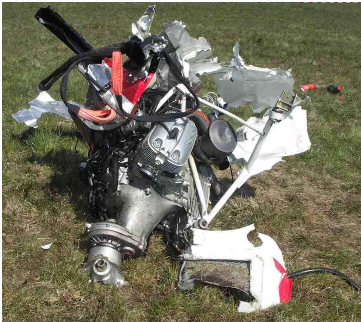
21 – Silnik wraz z łozem po odcięciu od rozbitego samolotu. Na pierwszym planie widoczna piasta śmigła ze szczątkami nasad łopat i resztki kompozytowej osłony silnika.
