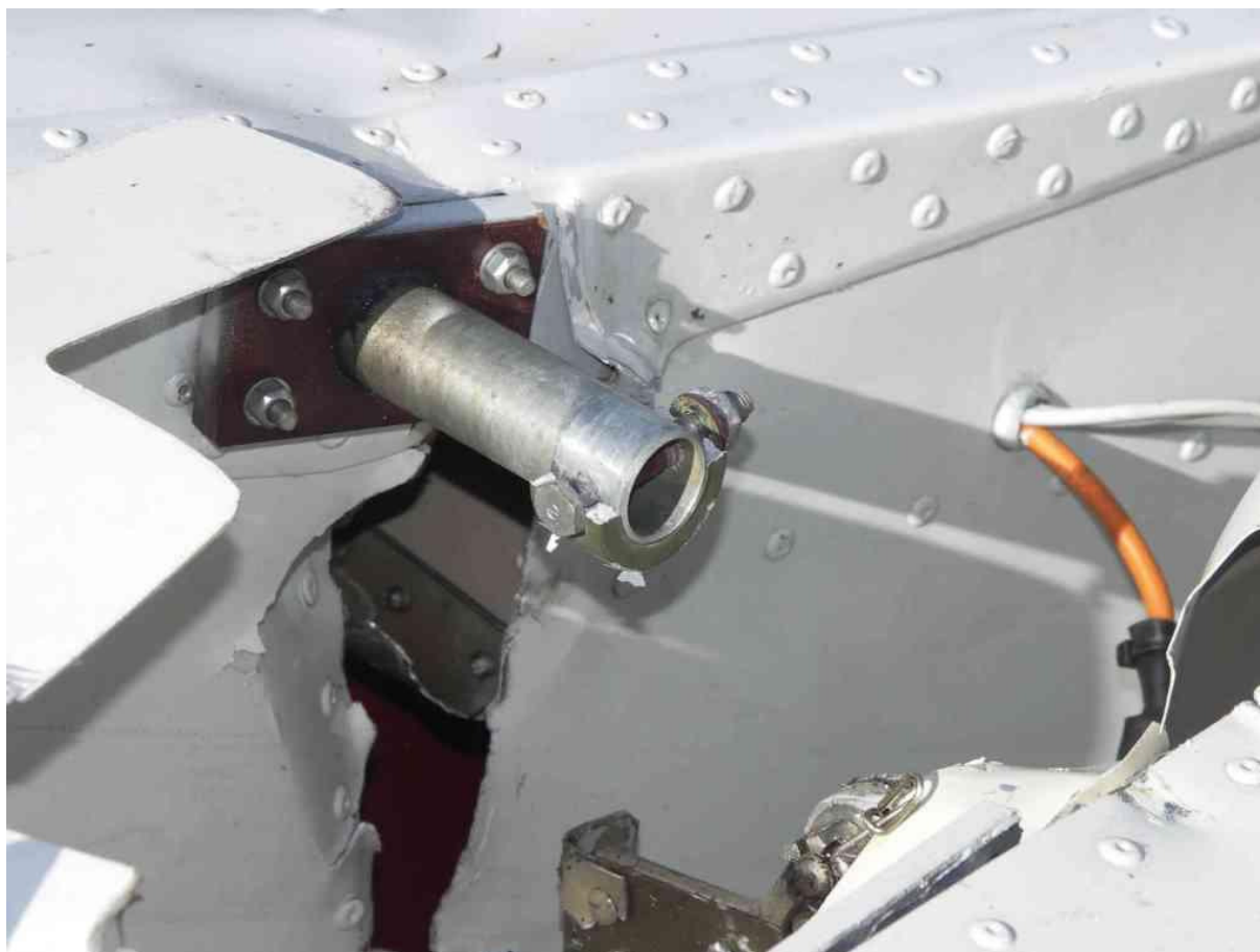
23 – Prawa końcówka wałka napędu kłap z resztkami dźwigni napędu prawej kłapy skrzydłowej.
