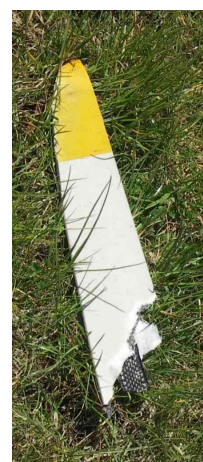
4a, 4b, 4c – Rozsypane szczątki – kolejno od lewej łopata śmigła, dolna osłona silnika i odłamany fragment łopaty śmigła.
