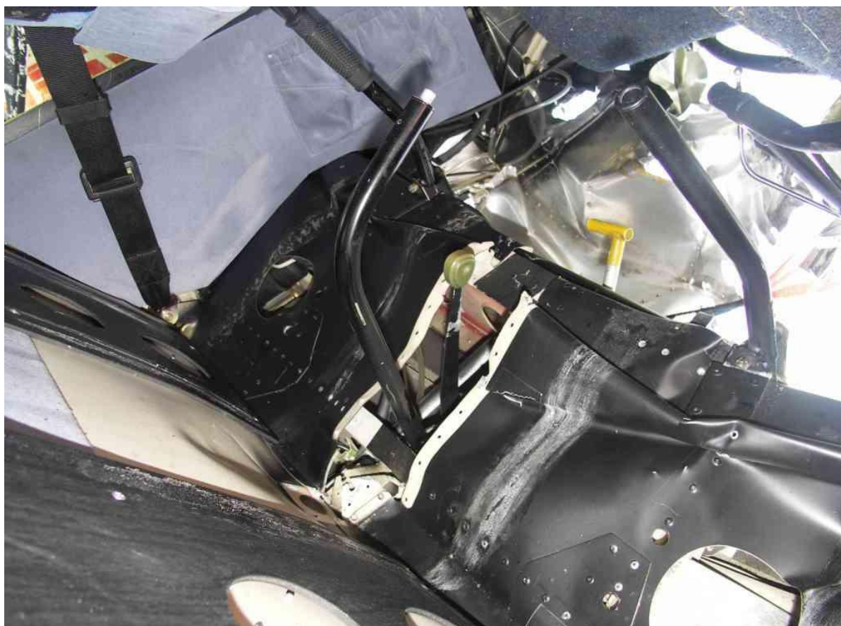
29 – Wnętrze kabiny – widoczne drążki sterowe i położenie dźwigni klap. Poduszki siedzisk i oparcie foteli usunięte.
