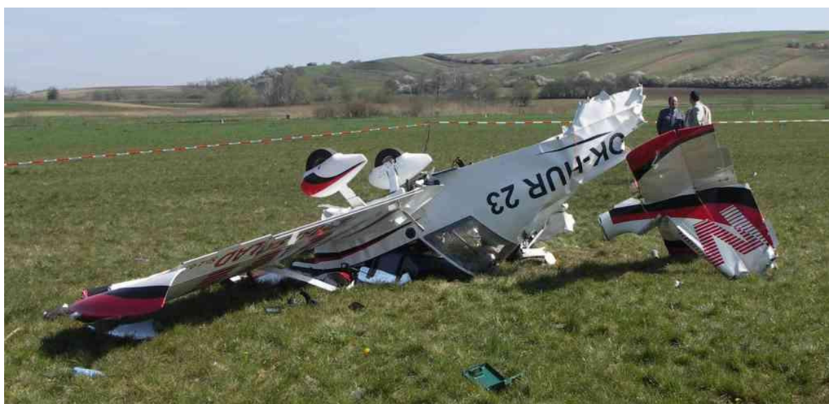
12 – Rozbity samolot po wypadku, prawa strona. Widoczne usterzenie oderwane wraz z tylną częścią kadłuba.
