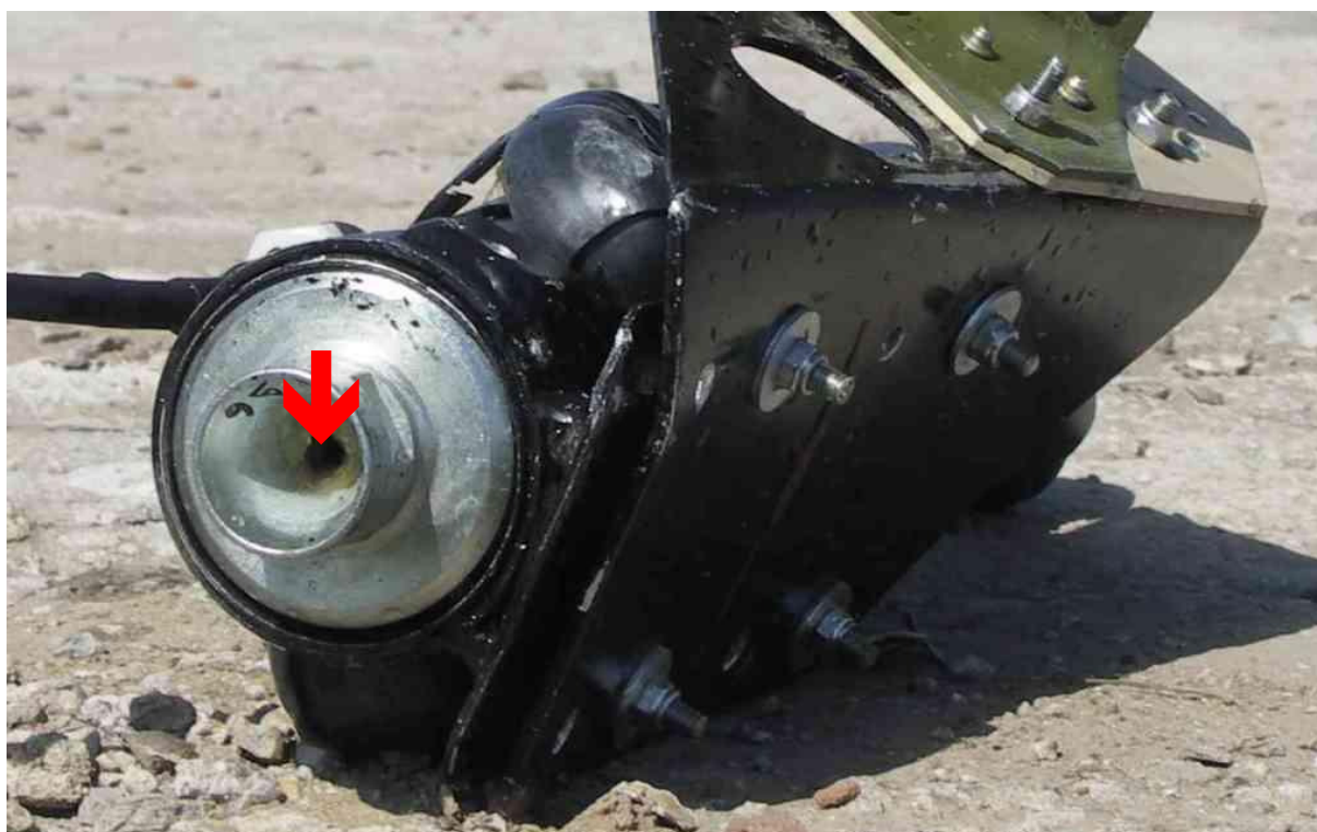
31 – Rakieta systemu ratunkowego Galaxy odcięta od wraku samolotu. Strzałką wskazana membrana w dyszy rakiety, przebita w celu neutralizacji ładunku pirotechnicznego wodą.
