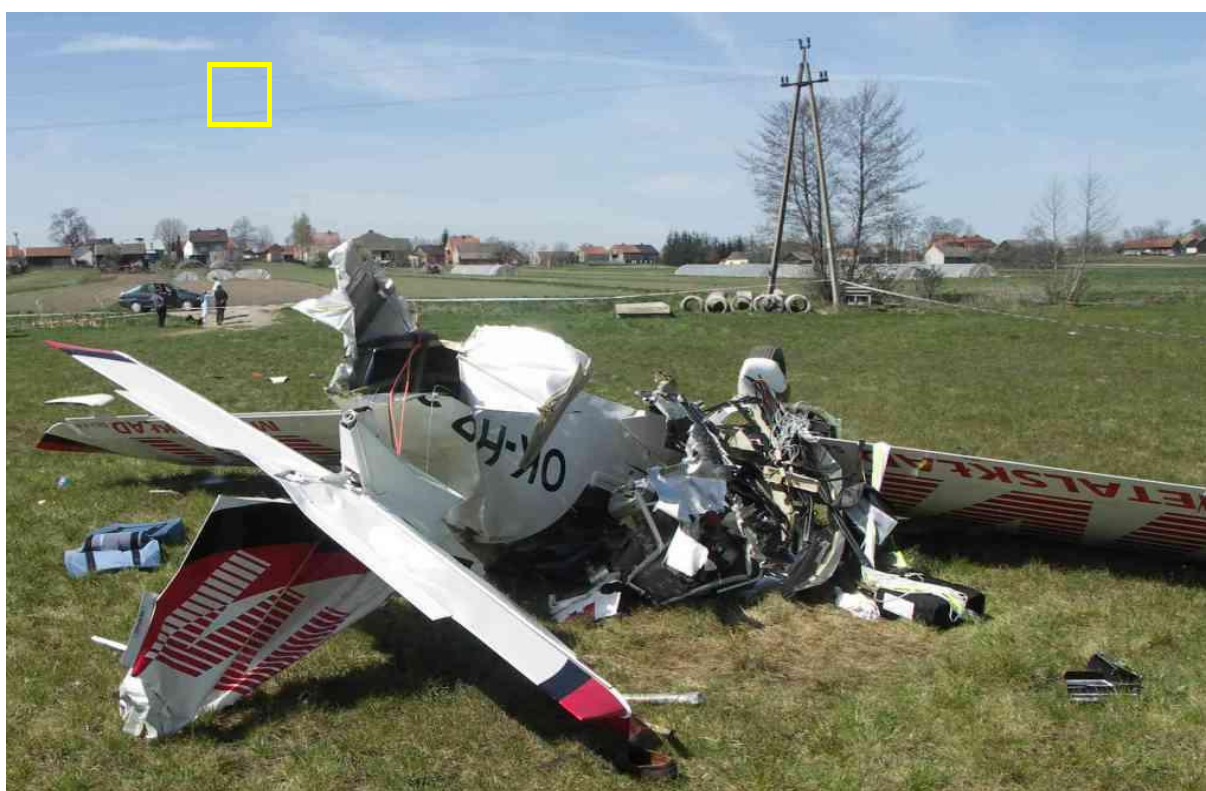
6 – Widok miejsca wypadku w kierunku przeciwnym do kierunku podejścia; żółtym kwadratem oznaczone miejsce uszkodzenia linii energetycznej. Kierunek przebiegu linii energetycznej ulega zmianie na widocznym słupie o kształcie litery A.
