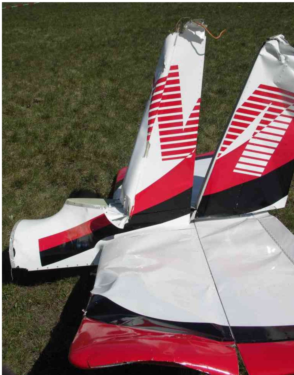
27 – Tylina część kadłuba oderwana od reszty płatowca wraz z usterzeniem. Dobrze widoczne ślady zderzenia z przewodami linii energetycznej u nasady i przy końcówce statecznika pionowego oraz przy końcówce steru kierunku.
