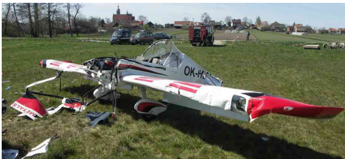
22 – Przednia część kadłuba ze skrzydłami po odwróceniu na koła na miejscu wypadku.
