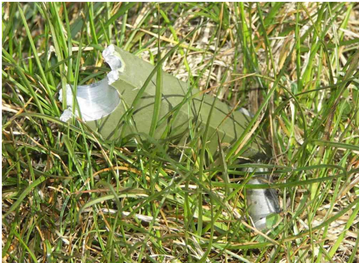
24 – Dźwignia napędu prawej kłapy, odłamana z końcówki wałka napędu kłap.
