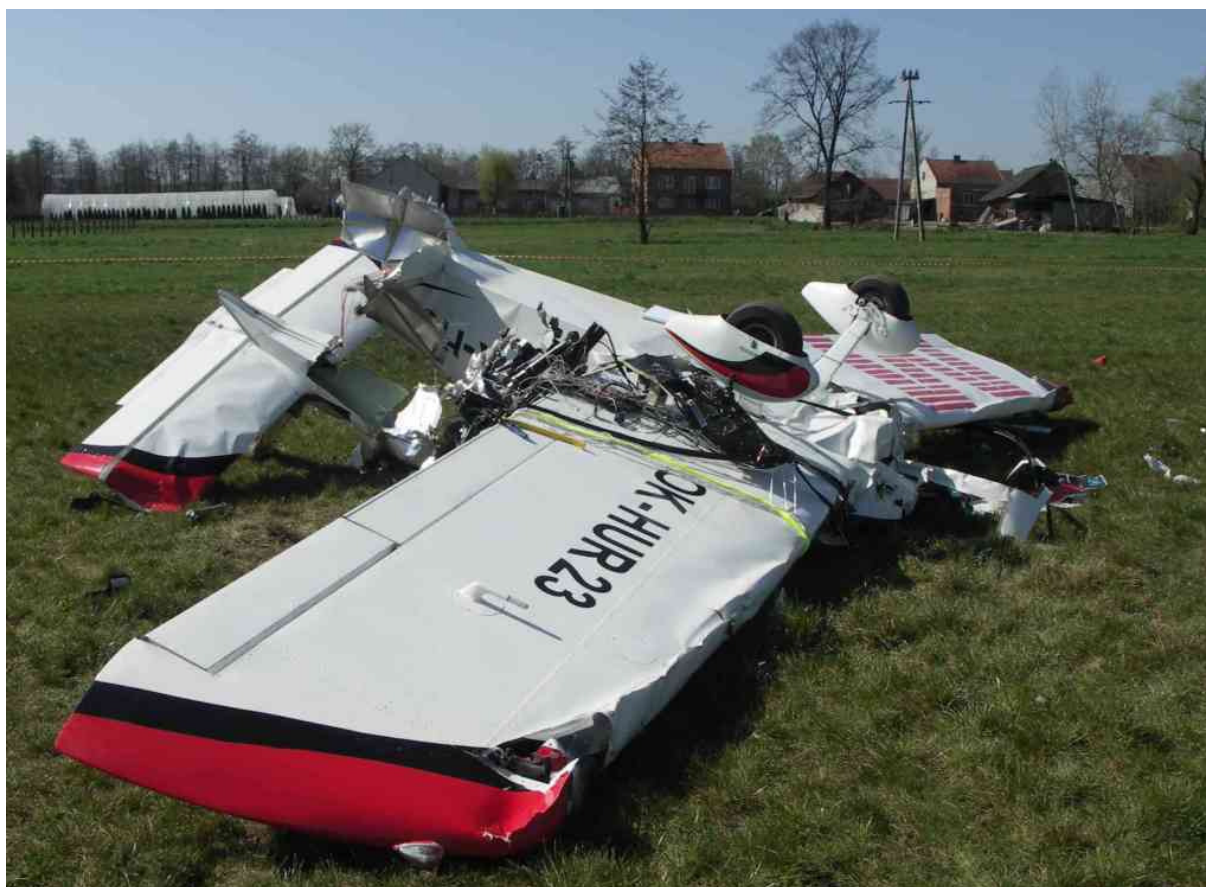
13 – Rozbity samolot, lewa strona od przodu. Widoczne usterzenie oderwane wraz z tylną częścią kadłuba oraz leżąca na lewym skrzydle tablica przyrządów wyrwana z zamocowań.
