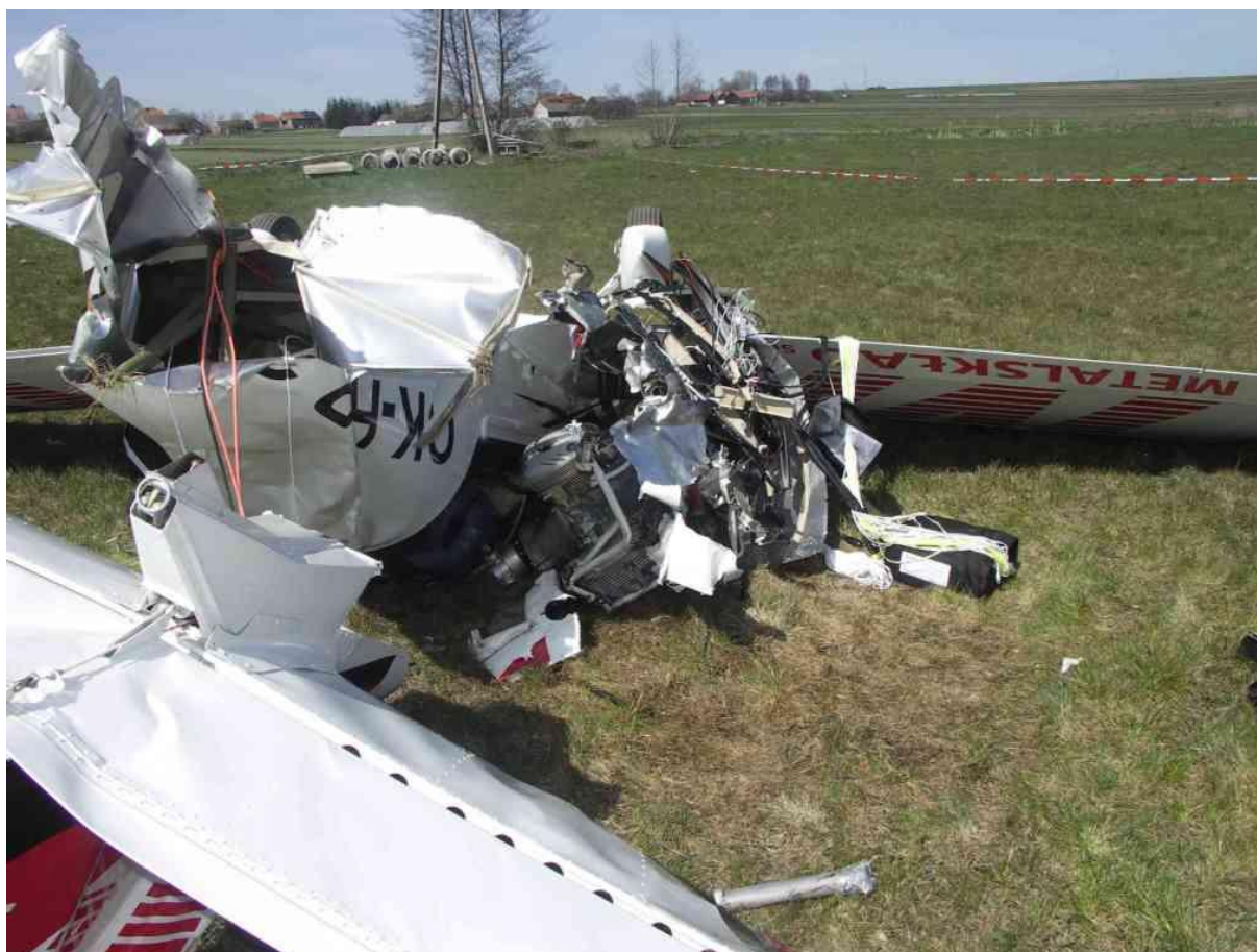
16 – Zbliżenie rozbitego samolotu od tyłu. Widoczne miejsce rozerwania tylnej części kadłuba oraz wyłamany silnik i szczątki przegrody ogniowej. Po prawej stronie od nich leży zasobnik spadochronu systemu ratunkowego Galaxy.
