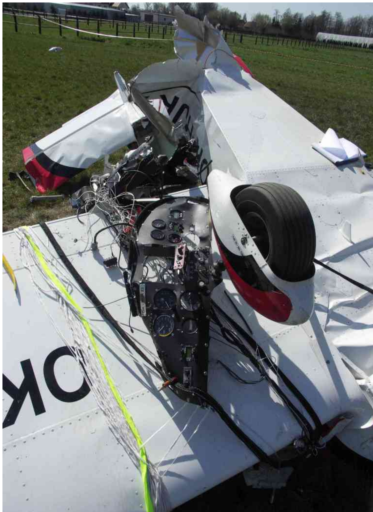
17 – Zbliżenie na tablicę przyrządów, leżącą na spodzie lewego skrzydła. Obok częściowo wyplecione linki spadochronu systemu ratunkowego Galaxy.
