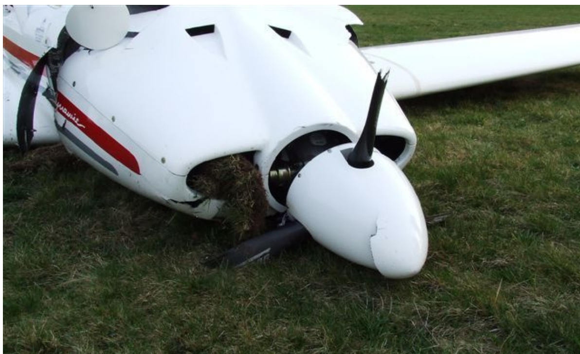
10 – Uszkodzenia zespołu napędowego. Widoczne zniszczone śmigło, uszkodzony kołpak śmigła i osłony silnika.
