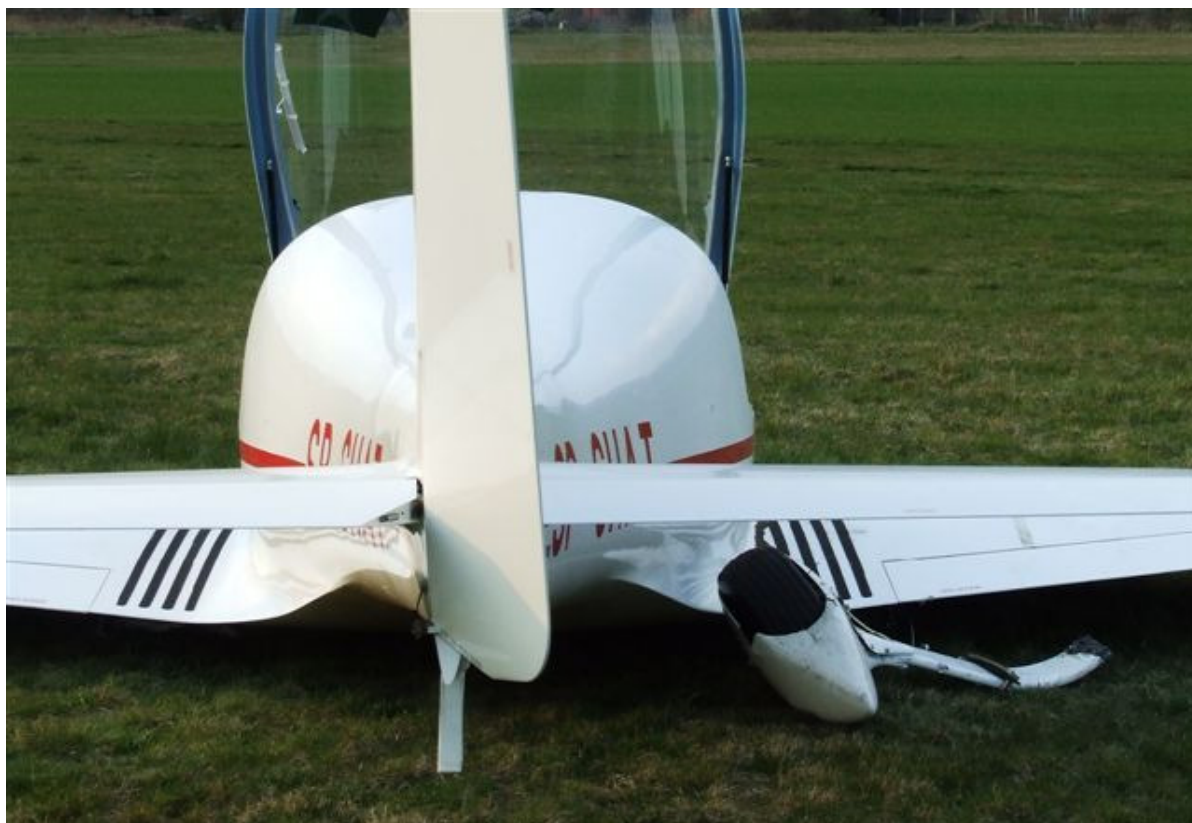
14 – Samolot na miejscu wypadku w widoku od tyłu. Widoczne wytłamane prawe podwozie główne.
