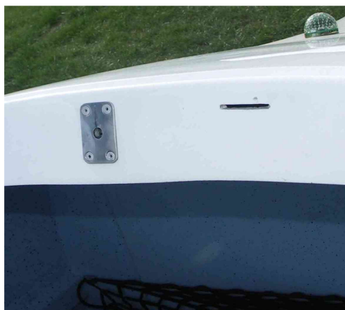
20 - Elementy zamka na kompozytowej wrędze kadłuba. Po lewej stronie widoczna metalowa nakładka z otworem pod rygiel, po prawej szczelina, w którą wsuwa się języczek zamka (zamykanego kluczykiem).
