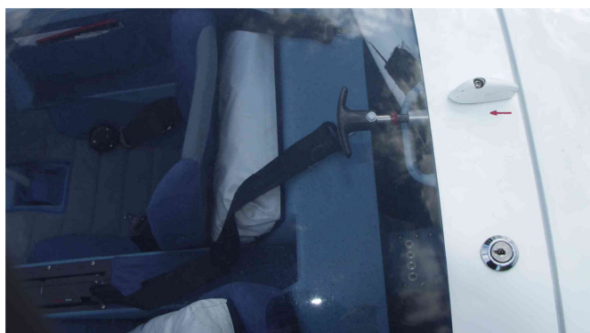
18 i 19 – Widoki z zewnątrz od góry na zamek nie domkniętej osłony kabiny.
