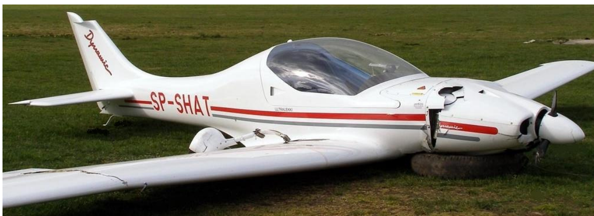
7 – Rozbity samolot w widoku \frac{3}{4} z prawej od przodu. Za prawym skrzydłem wylamana goleń podwozia.
