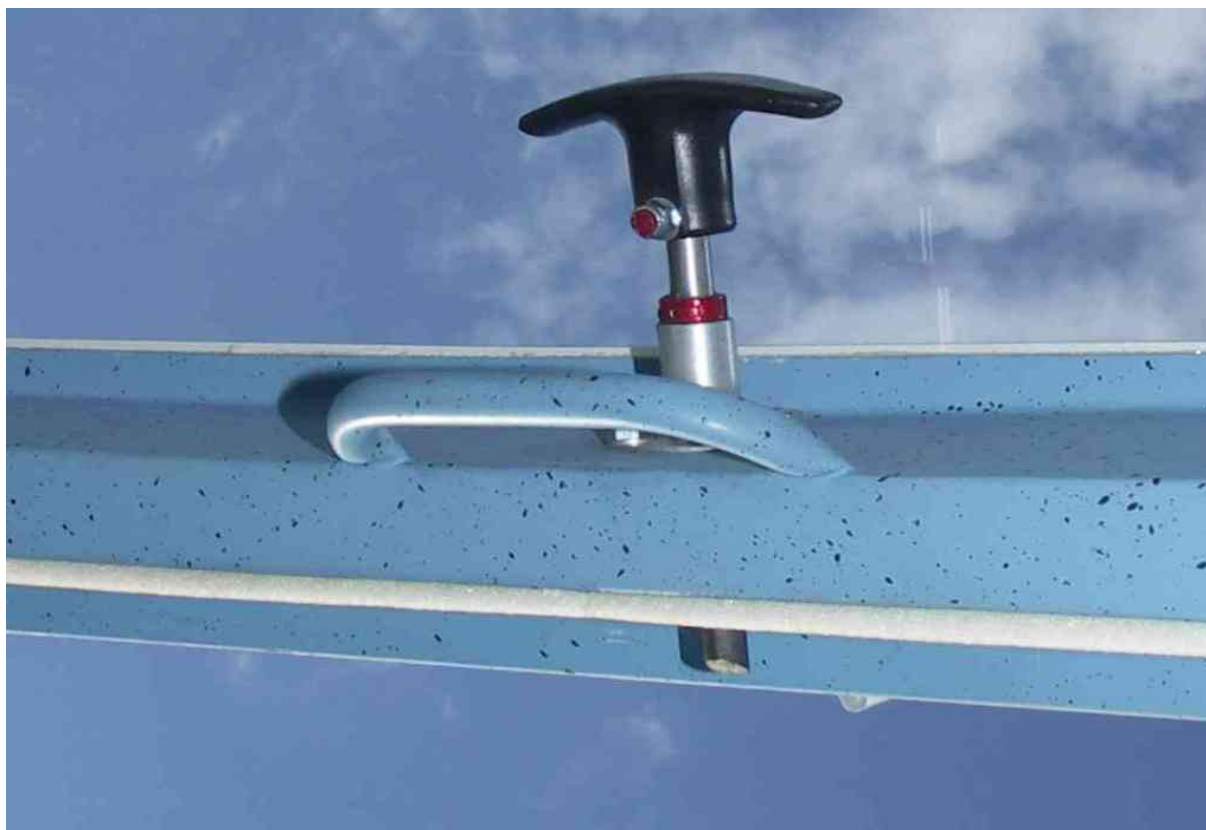
22 – Widok elementów zamka na osłonie kabiny od wewnątrz. Widoczny wewnętrzny uchwyt osłony i uchwyt rygla (czarny); rygiew w położeniu tylnym (jak przy zamkniętej osłonie) – widać wysunięty rygiew, a czerwony pierścień na rygiew przylega do tulejki prowadzącej.
