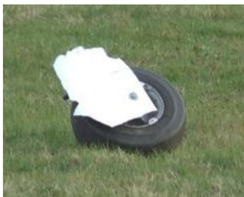
11 – Koło wyłamanego podwozia przedniego.
