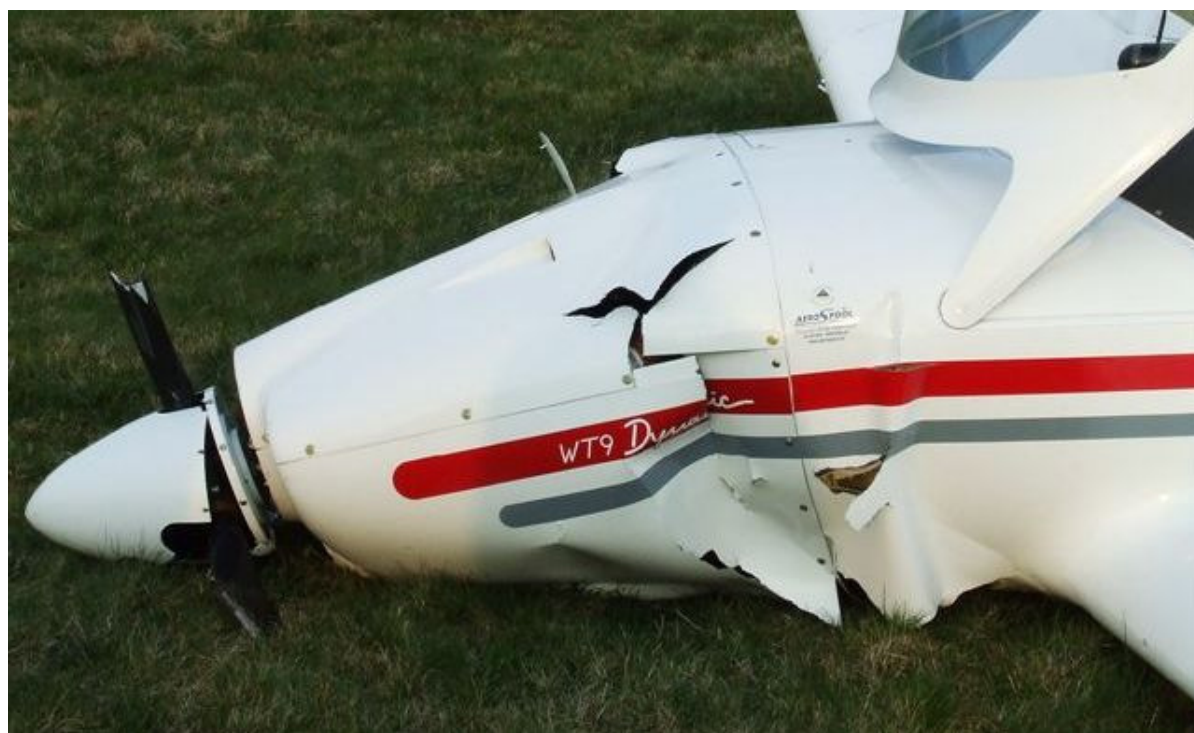
8 – Uszkodzenia przedniej części kadłuba, lewa strona. Widoczne zniszczone śmigło, uszkodzone osłony silnika, kołpak śmigła i struktura kadłuba w rejonie przegrody ogniowej. Znaczne odkształcenie przedniej części kadłuba sugeruje zniszczenie też silnika. Zdjęcie z miejsca wypadku.
