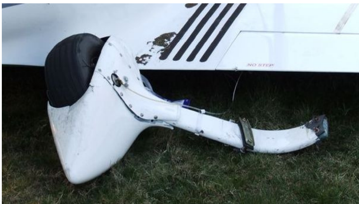
13 – Wyłamane prawe podwozie główne u nasady prawego skrzydła. Zdjęcie z miejsca wypadku.
