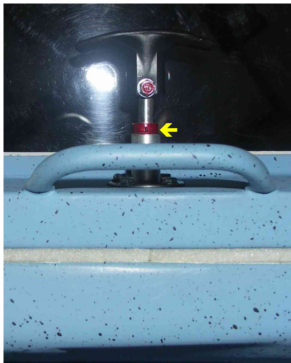
24 – Widok elementów zasuniętego rygiew po zamknięciu osłony z wnętrza kabiny – o tylnym położeniu rygiew świadczy pozycja wskazanego strzałką czerwonego pierścienia na rygiew, który przylega do tulei prowadzącej.
