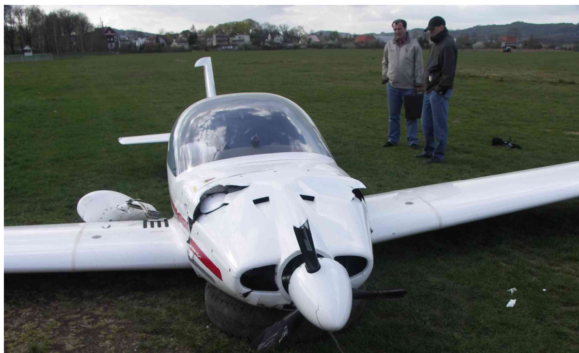
9 – Uszkodzenia przedniej części kadłuba, widok z przodu. Widoczne zniszczone śmigło, uszkodzony kołpak śmigła i osłony silnika. Za prawym skrzydłem widoczne wyłamane prawe podwozie główne.
