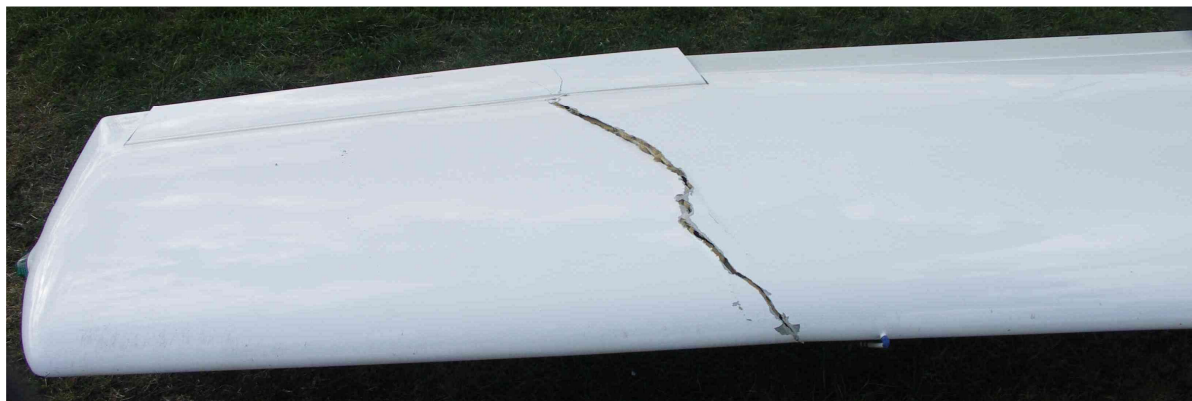
15 – Uszkodzenia prawego skrzydła – złamanie w rejonie lotki.
