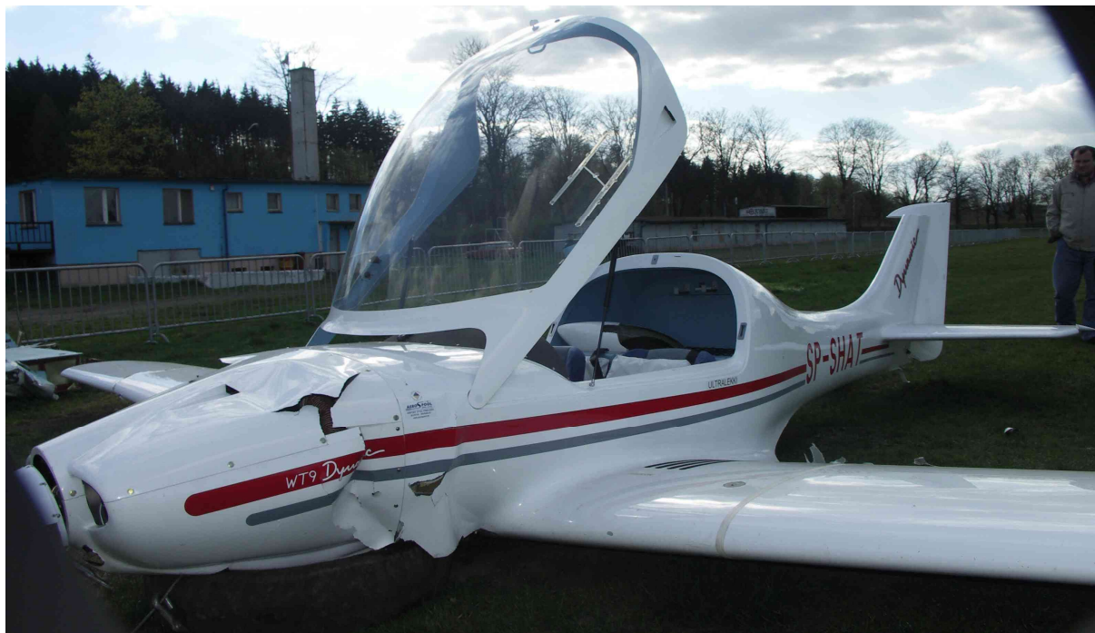
17 – Uszkodzenia przedniej części kadłuba, lewa strona. Otwarta osłona kabiny.
