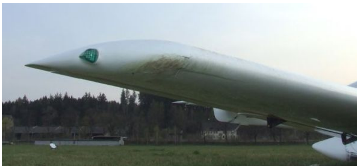
16 – Uszkodzenia końcówki prawego skrzydła.
